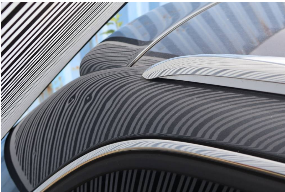
Diverse Dellen am Dachholm rechts
