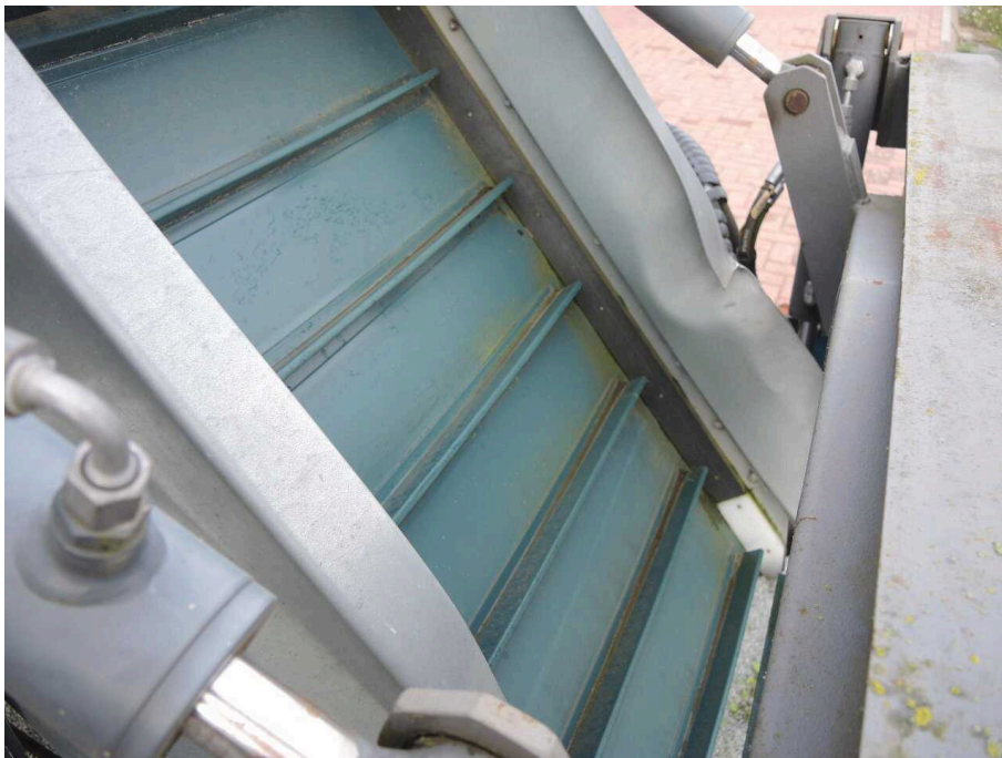
Bild 16 Aufbau Führungsblech verformt
