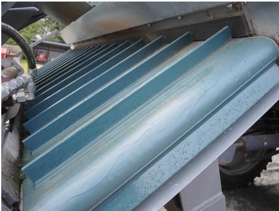
Bild 22 Aufbau Anbauteil Transportband verschlissen
