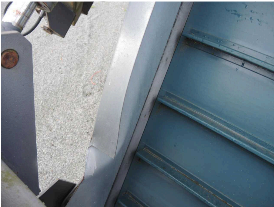
Bild 17 Aufbau Führungsblech verformt
