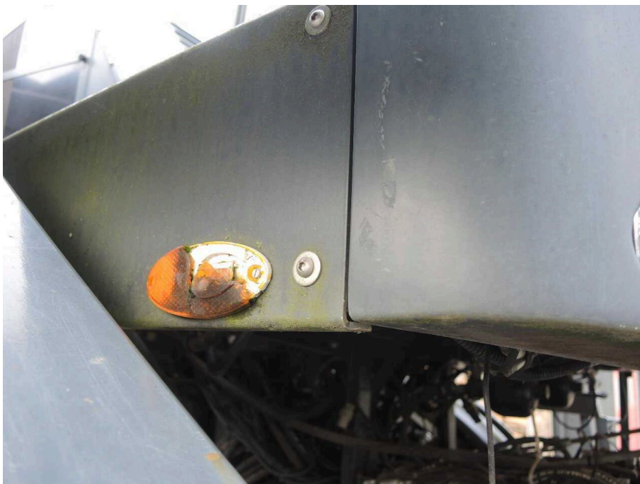
Bild 24 rechte Seite Seitenmarkierungsleuchte rechts gebrochen
