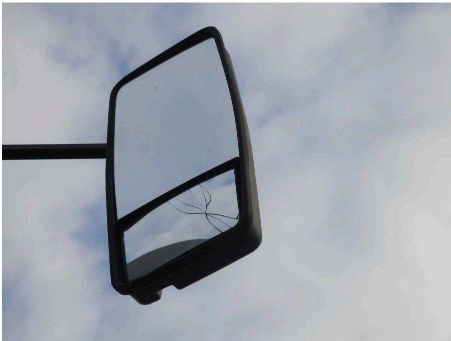
Bild 26 rechte Seite Außenspiegel rechts gebrochen
