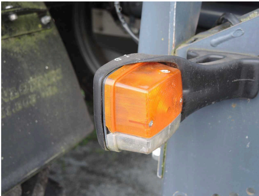
Bild 25 Fahrzeugfront Blinkleuchte vorne rechts gebrochen
