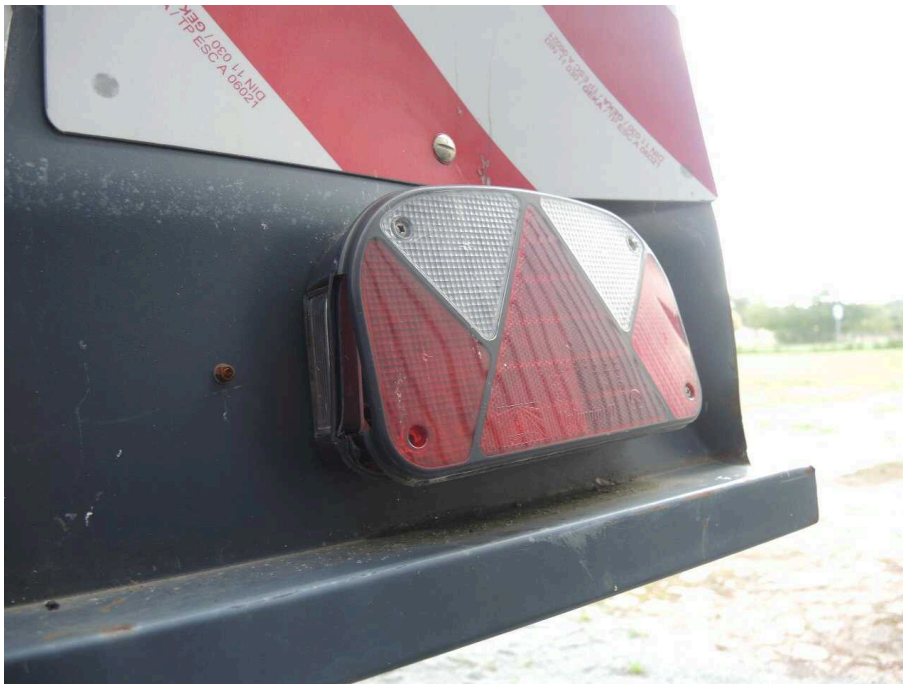
Bild 21 Fahrzeugheck Rückleuchte rechts gebrochen
