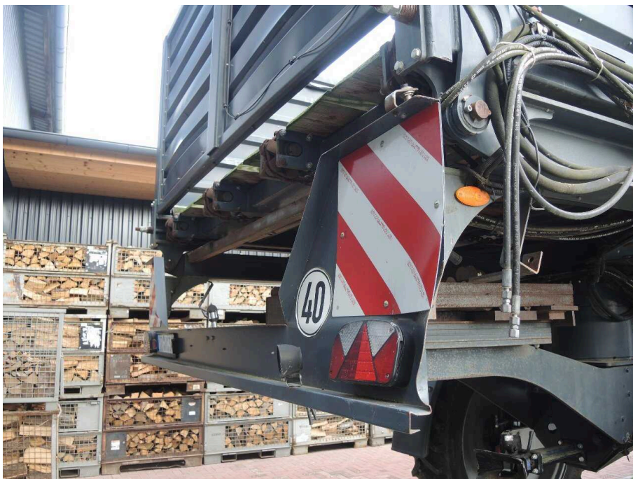
Bild 18 Fahrzeugheck Heckrahmen verformt
