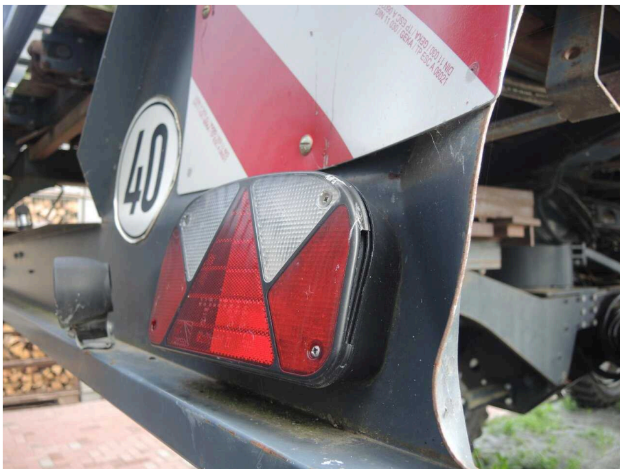
Bild 20 Fahrzeugheck Rückleuchte rechts gebrochen
