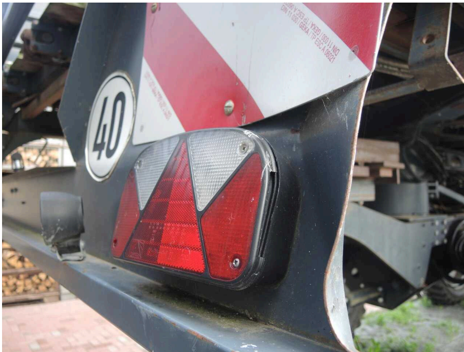
Bild 19 Fahrzeugheck Heckrahmen verformt
