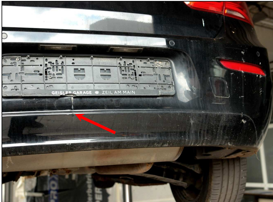
Lichtbild Nr.: 11 Stoßfänger hinten gestaucht, geknickt, eingerissen
