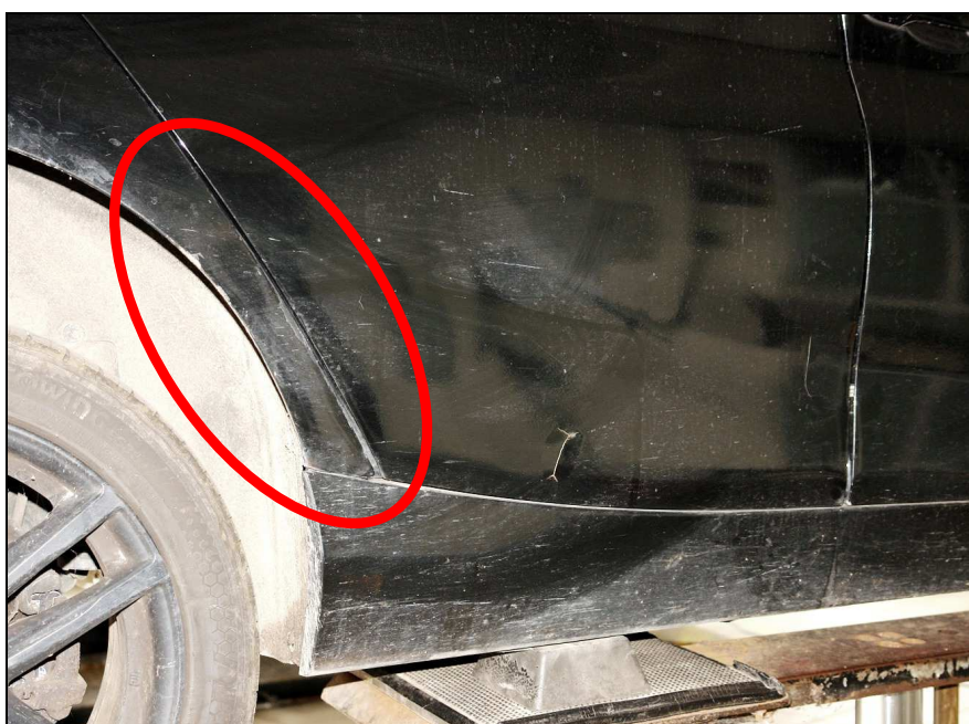
Lichtbild Nr.: 16 Seitenwand hi.re. pro- visorisch instandge- setzt, lackiert
