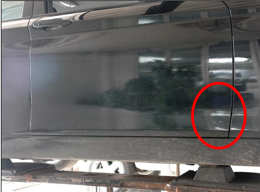
Lichtbild Nr.: 13 Tür vorne rechts pro- visorisch instandge- setzt, lackiert
