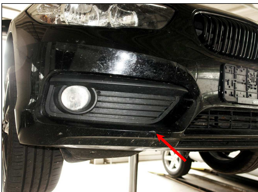
Lichtbild Nr.: 10 Stoßfänger vorne rechts angebrochen, eingerissen
