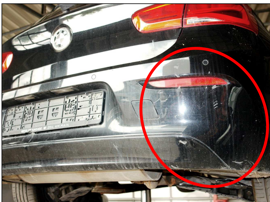
Lichtbild Nr.: 12 Stoßfänger hi. rechts gestaucht, geknickt, verschrammt
