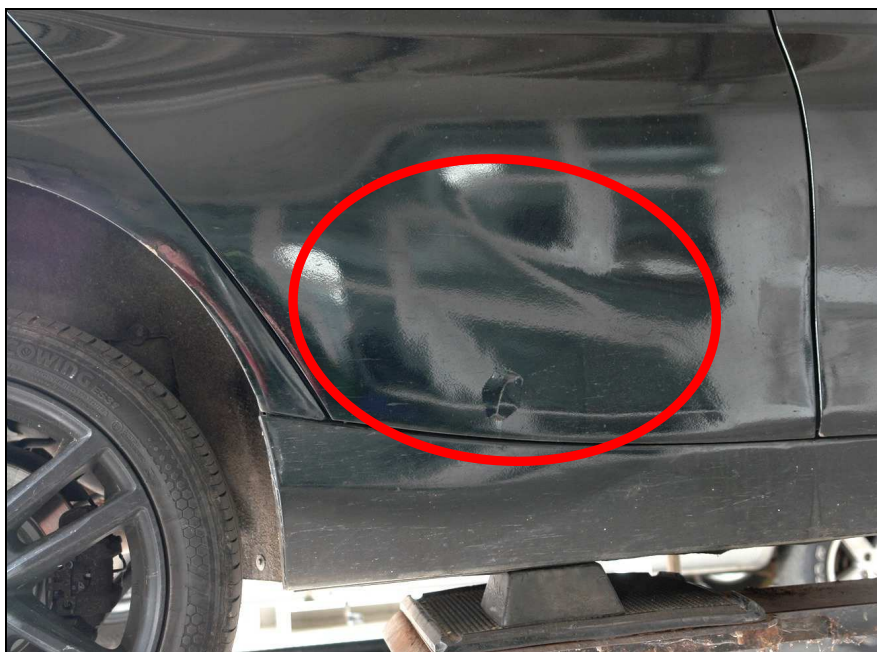
Lichtbild Nr.: 15 Tür hinten rechts pro- visorisch instandge- setzt, lackiert
