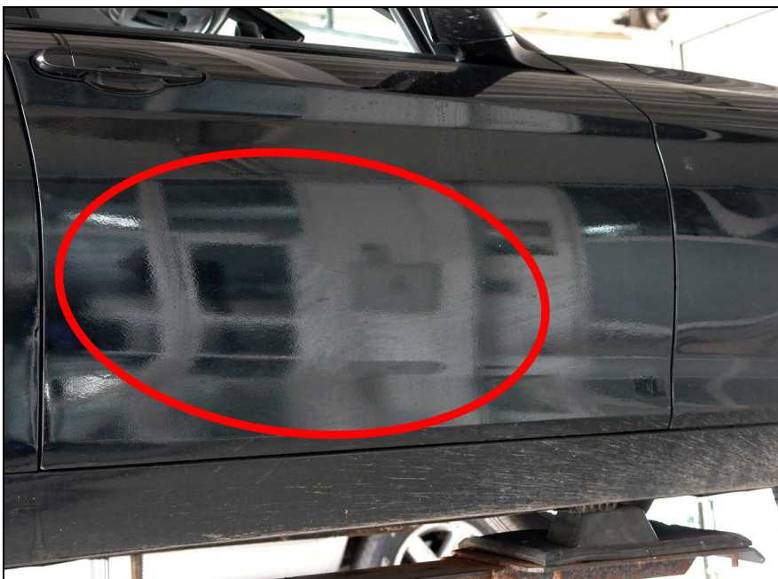
Lichtbild Nr.: 14 Tür vorne rechts pro- visorisch instandge- setzt, lackiert
