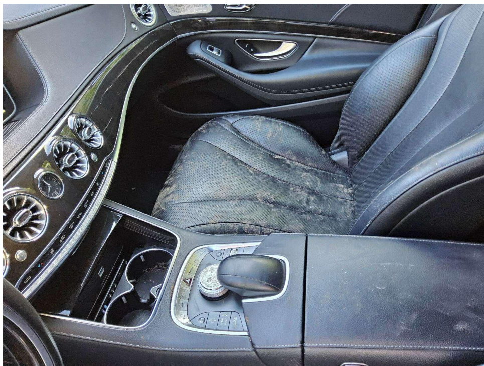
Bild 8 : Innenraum vorn Schimmelbildung
