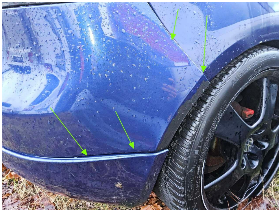
Bild 7 : Stoßfänger hinten verformt
