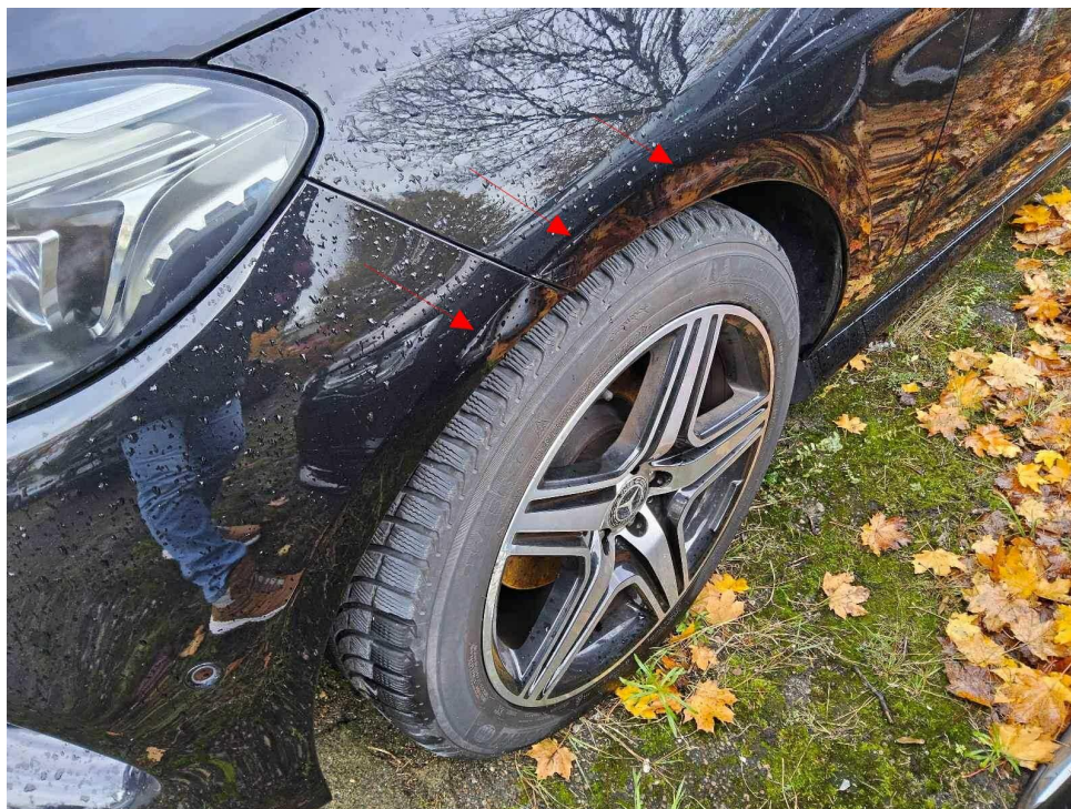
Bild 12 : Stossfänger verschrammt, Kotflügel eingedrückt
