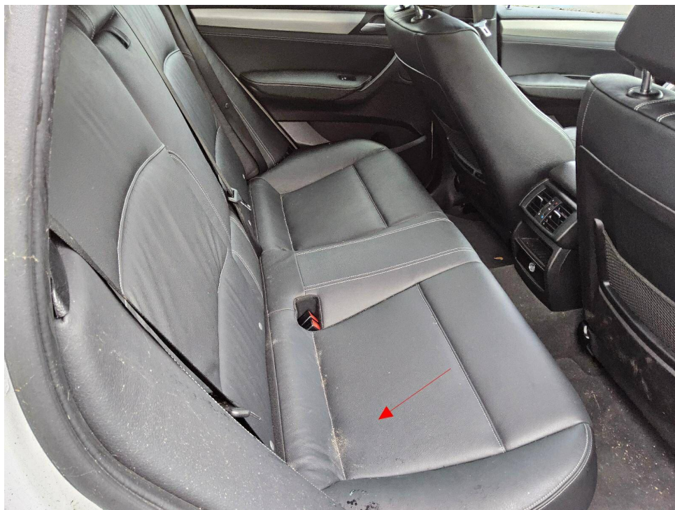
Bild 9 : Innenraum hinten mit Schimmelbefall
