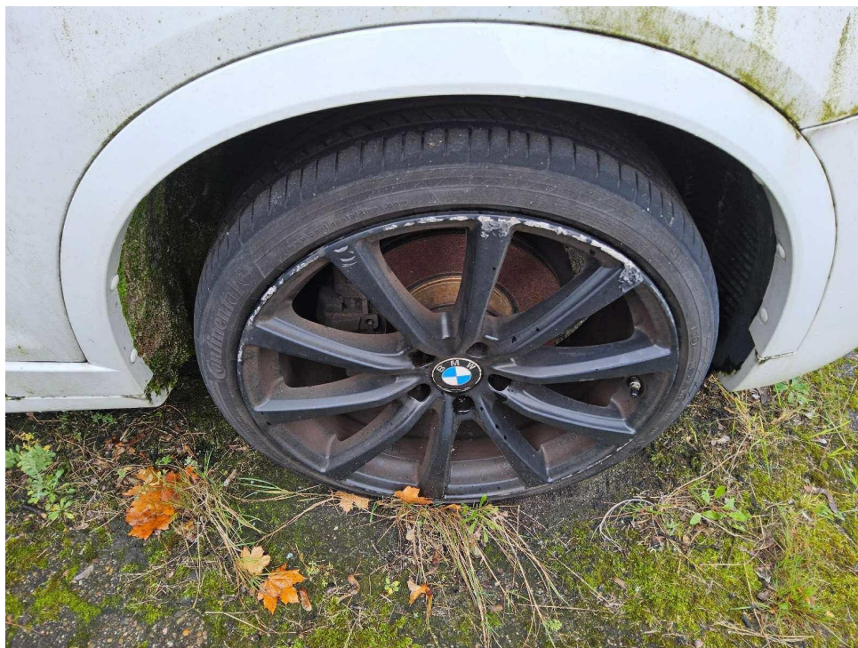
Bild 13 : Rad rechts vorn beschädigt
