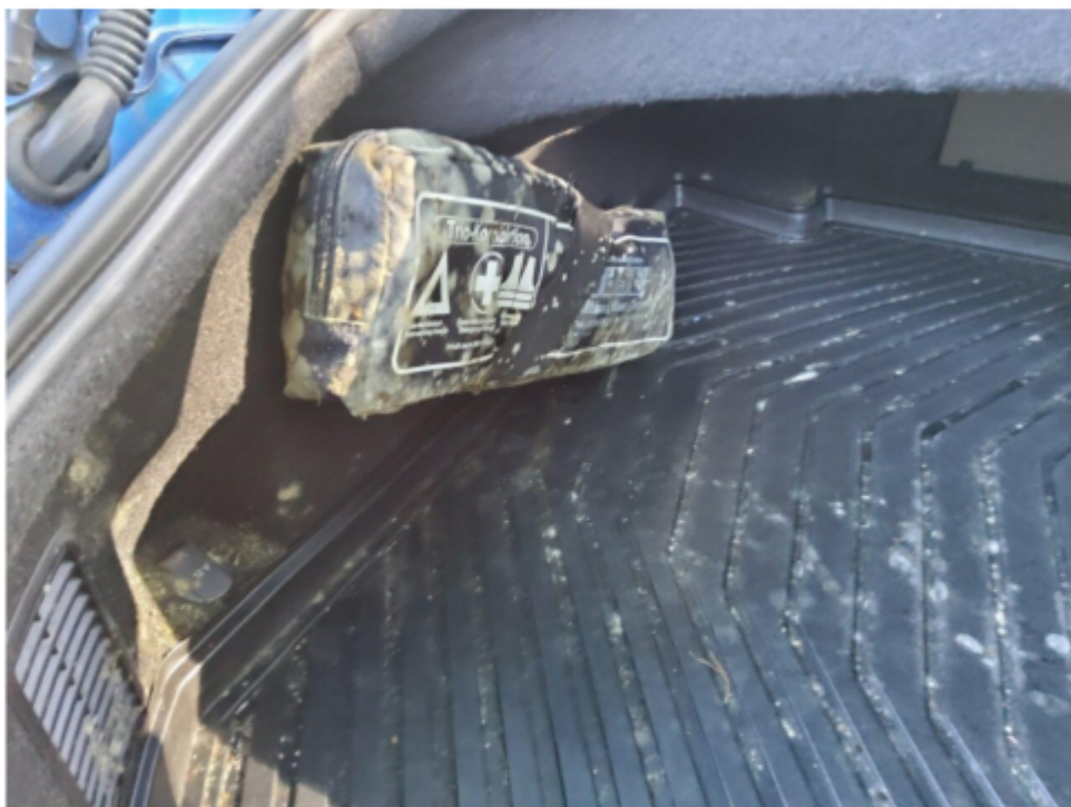
Bild 28 : Kofferraum Schimmel entfernen, Verkleidung Reinigen, Troknen und desinfizieren
