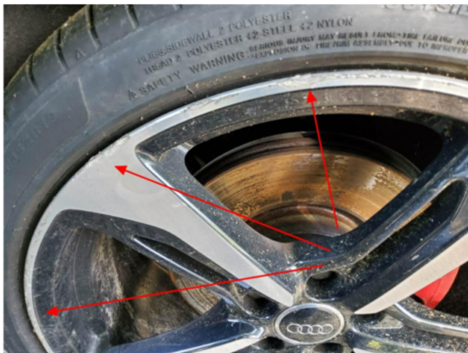
Bild 17 : Alufelge vorne rechts verschrammt
