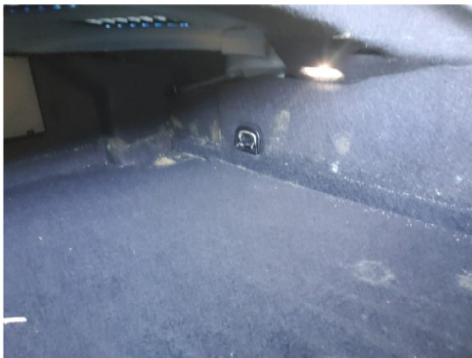
Bild 26 : Kofferraum Schimmel entfernen, Verkleidung Reinigen, Troknen und desinfizieren
