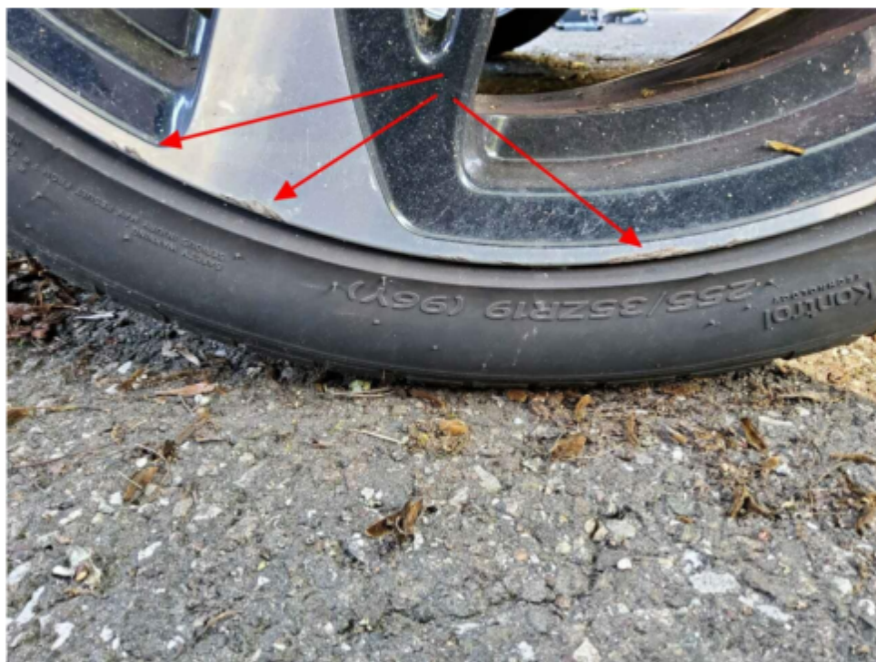
Bild 15 : Alufelge vorne links verschrammt
