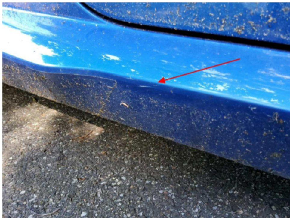
Bild 16 : Schweller rechts zerkratzt
