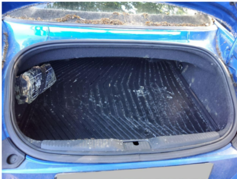
Bild 29 : Kofferraum Schimmel entfernen, Verkleidung Reinigen, Troknen und desinfizieren
