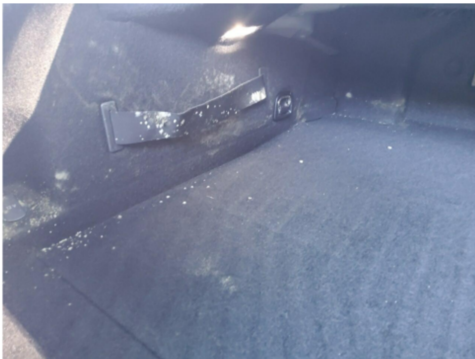
Bild 27 : Kofferraum Schimmel entfernen, Verkleidung Reinigen, Troknen und desinfizieren
