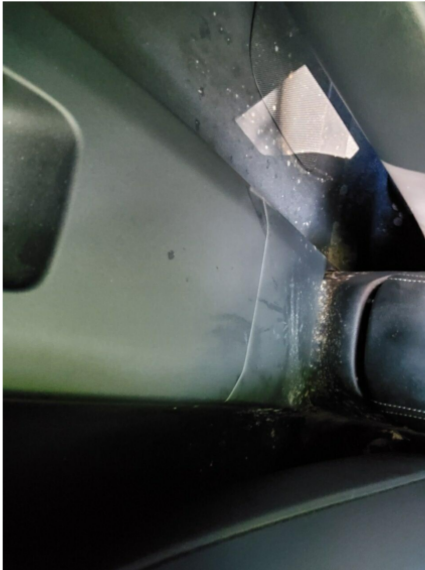
Bild 22 : Innenraum Schimmel entfernen, Sitze und Bodenbelag aus und einbauen und Reinigen, trocknen und desinfizieren
