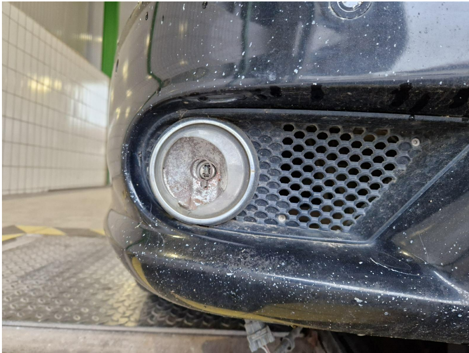
Bild 9 : Nebelscheinwerfer rechts, Abdeckscheibe gebrochen
