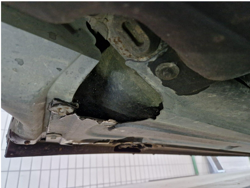
Bild 14 : Unterbodenverkleidung rechts, durchstoßen
