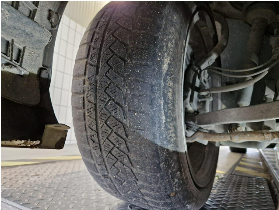
Bild 11 : Reifen vorne, bis Karkasse abgefahren, Reifengröße vorne falsch
