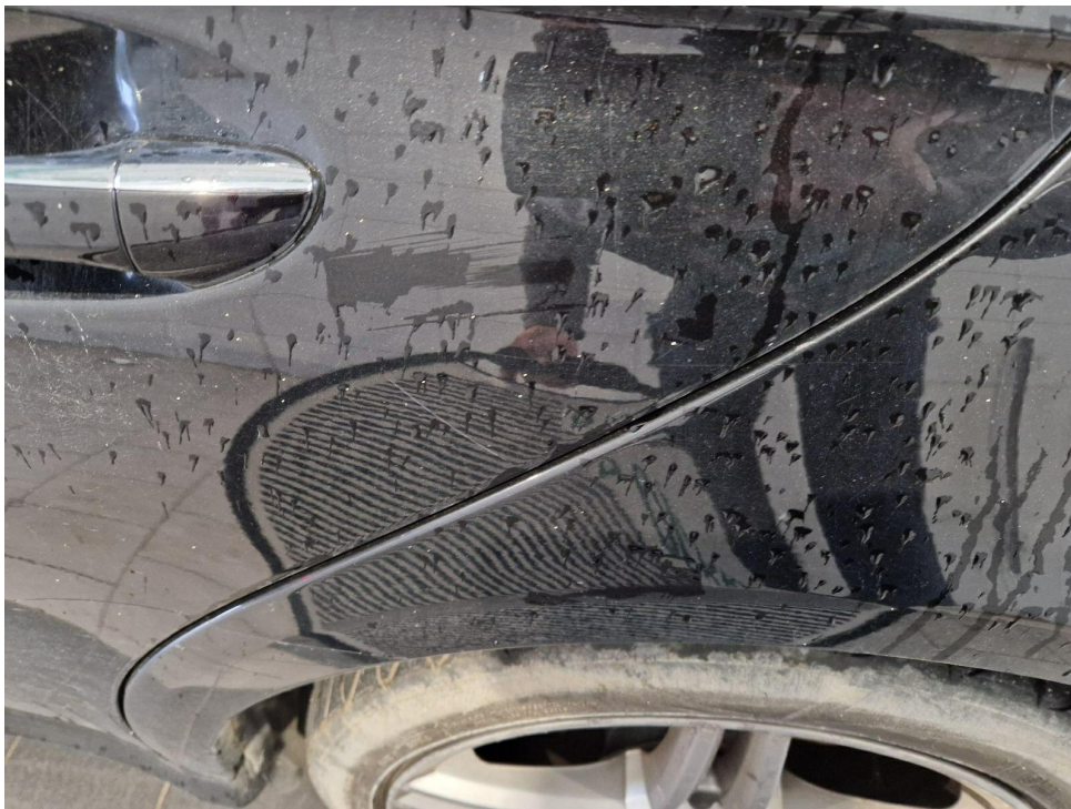
Bild 18 : Karosseriebleche aussen, stellenweise zerkratzt, Heavy-Cut-schleifen und polieren
