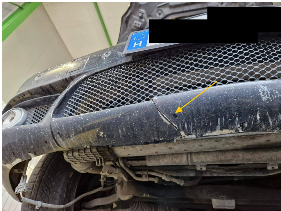
Bild 8 : Stoßfängerverkleidung eingerissen, Unterfahrschutz fehlt
