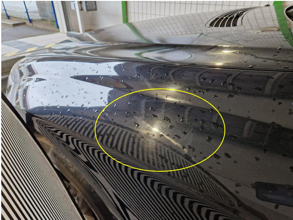
Bild 15 : Lackbild an Karosserieblechen aussen, stumpf
