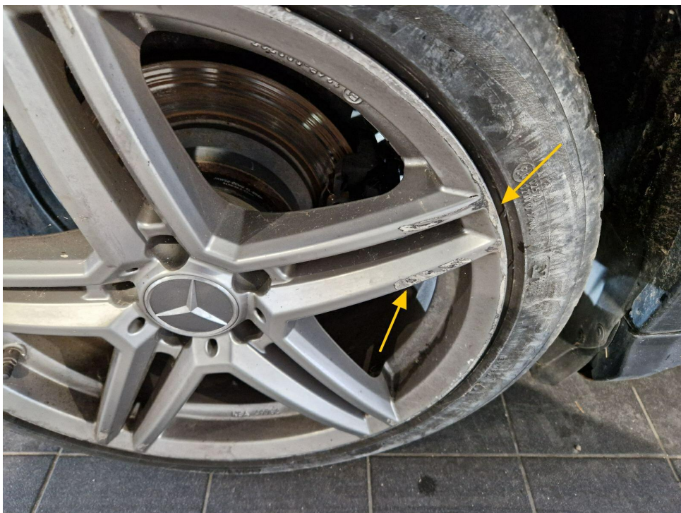
Bild 10 : Alle Leichtmetallräder mit starker Bordsteinbeaufschlagung
