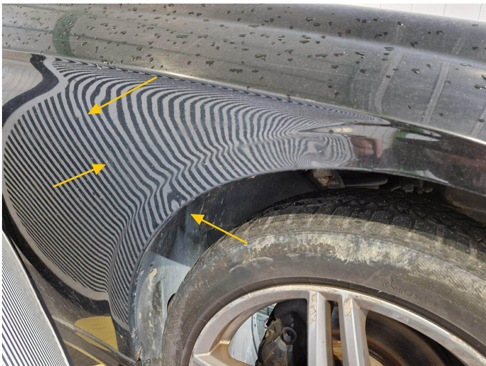
Bild 16 : Kotflügel vorne rechts, mehrfach eingedellt
