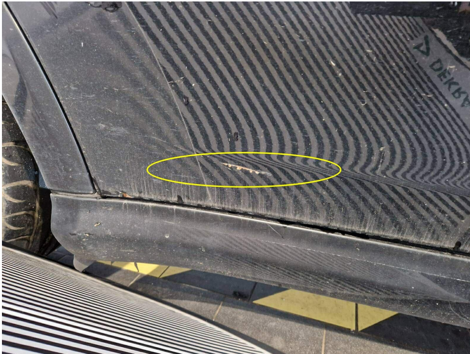
Bild 17 : Türe hinten rechts, tiefe Einschrammung
