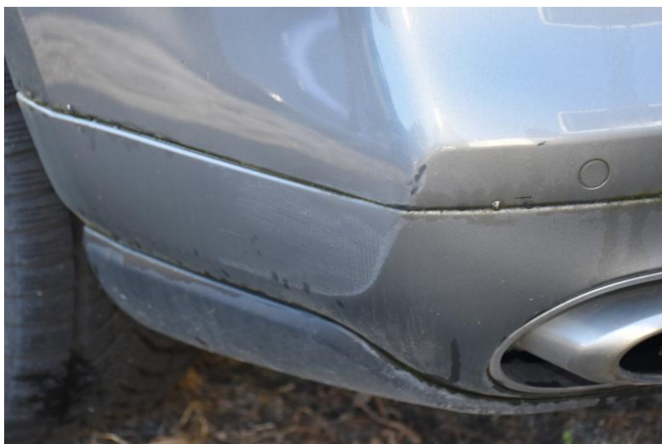
Stoßfängerverkleidung hinten beschädigt
