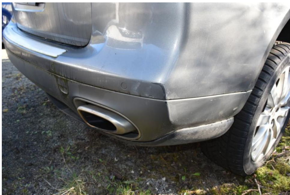
Stoßfängerverkleidung hinten beschädigt
