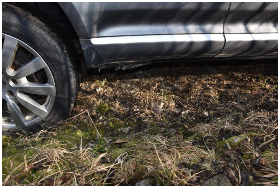
Schwellerblende rechts fehlt
