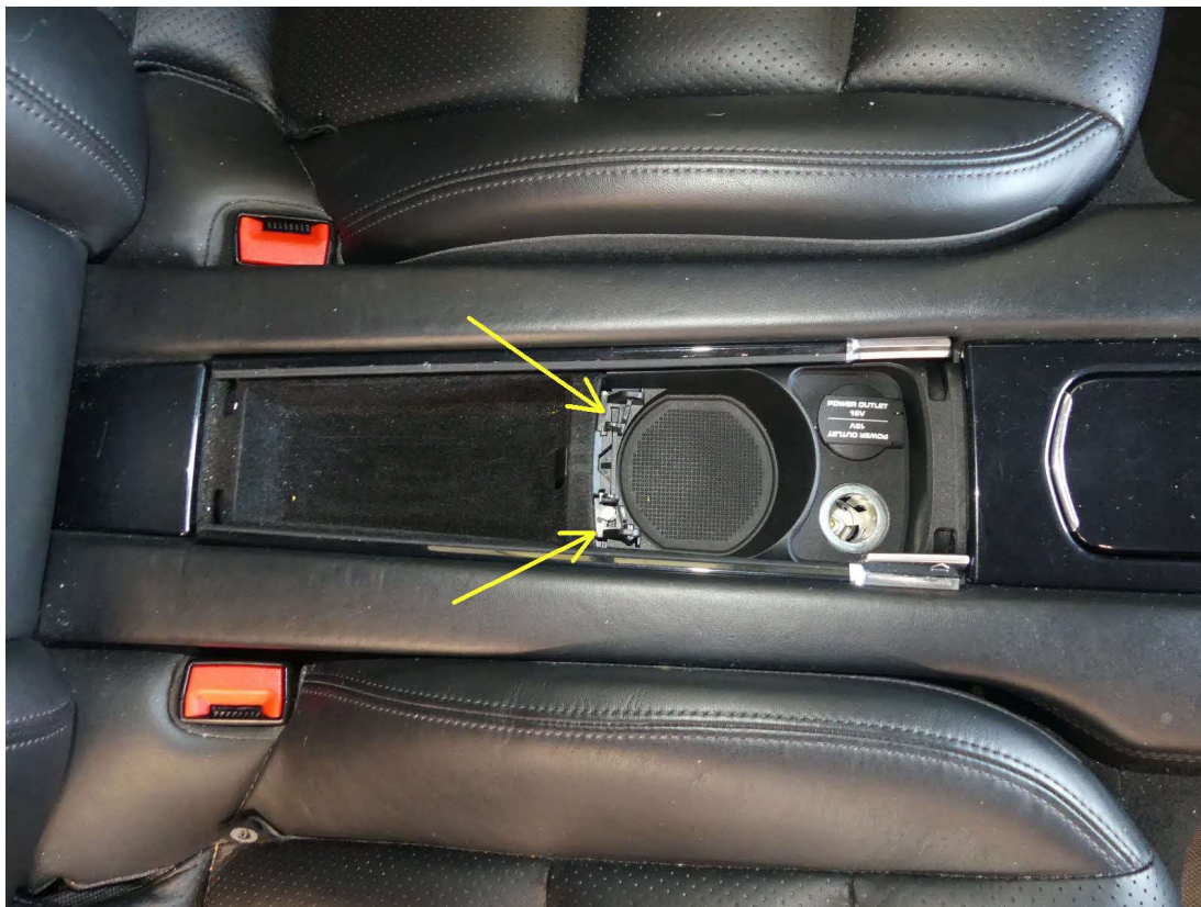
Bild Nr: 23 Cupholder hinten beschädigt
