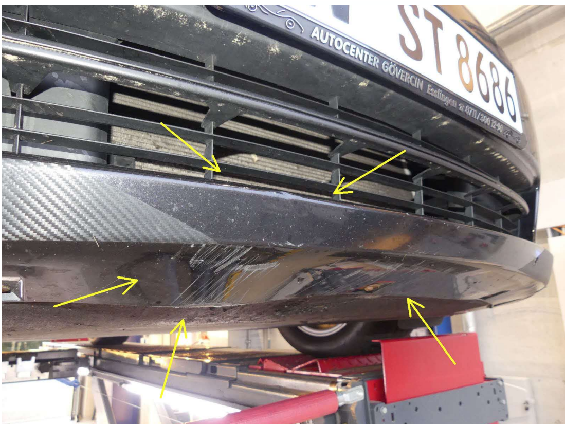
Bild Nr: 14 Stoßfängerverkleidung vorne unten beschädigt
