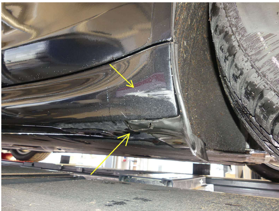
Bild Nr: 18 Schwellerverkleidung links beschädigt
