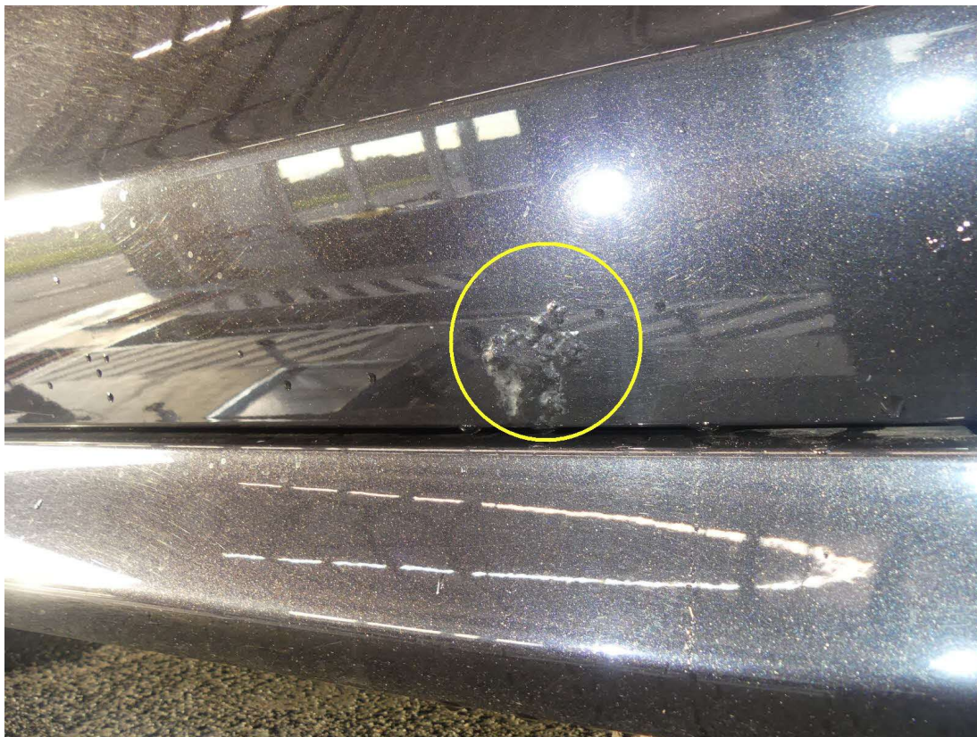
Bild Nr: 17 einzelne lokale Korrosionsstellen
