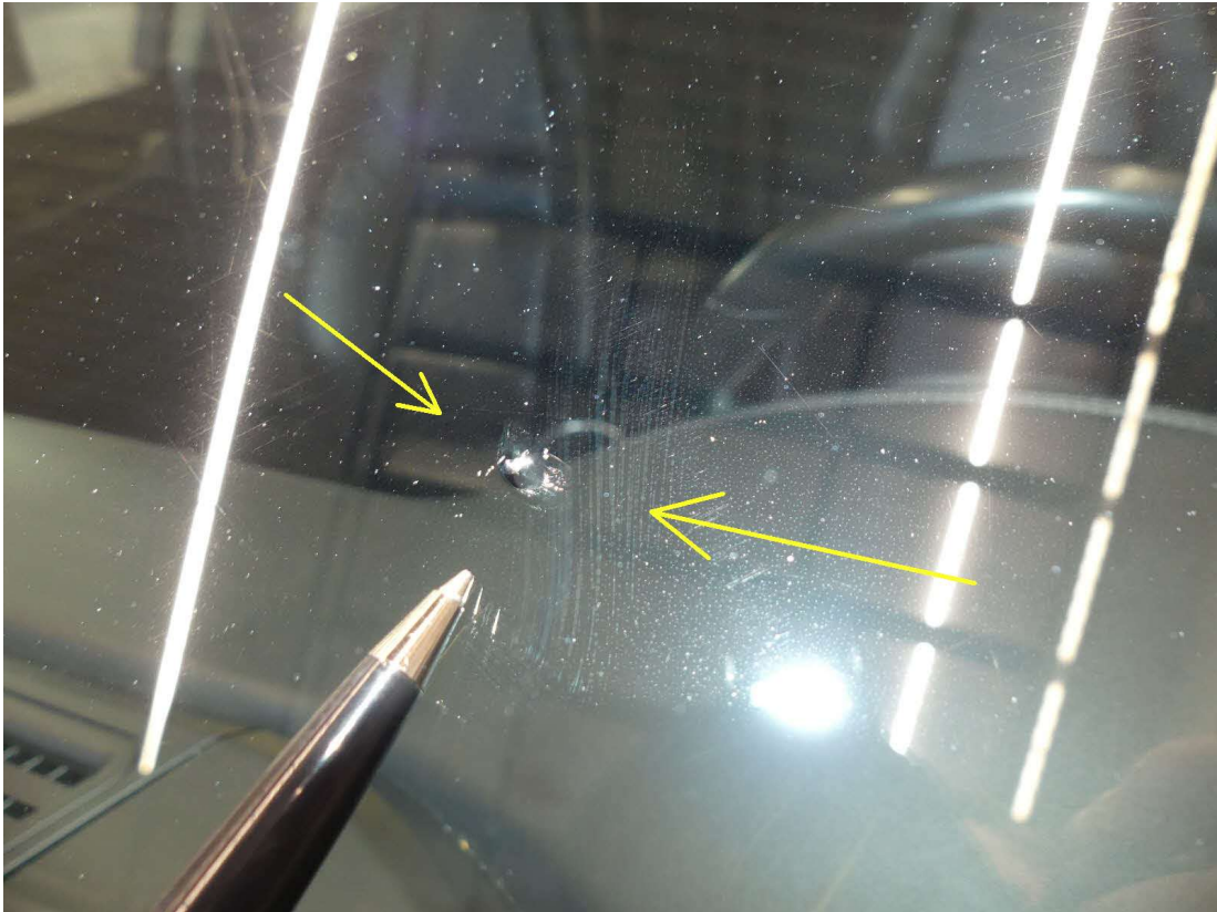
Bild Nr: 21 Steinschlag Windschutzscheibe im Fahrersichtfeld
