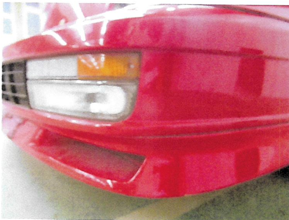
Bild 26 : Lackkratzer am Stoßfänger und Spoiler vorn
