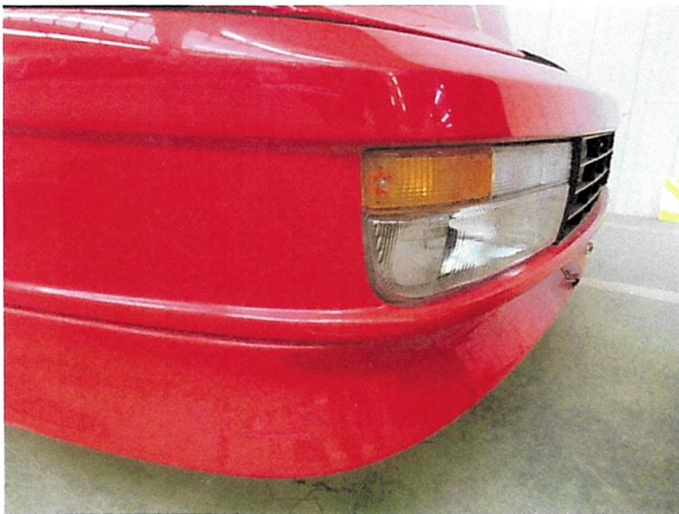
Bild 24 : Lackkratzer am Stoßfänger und Spoiler vorn
