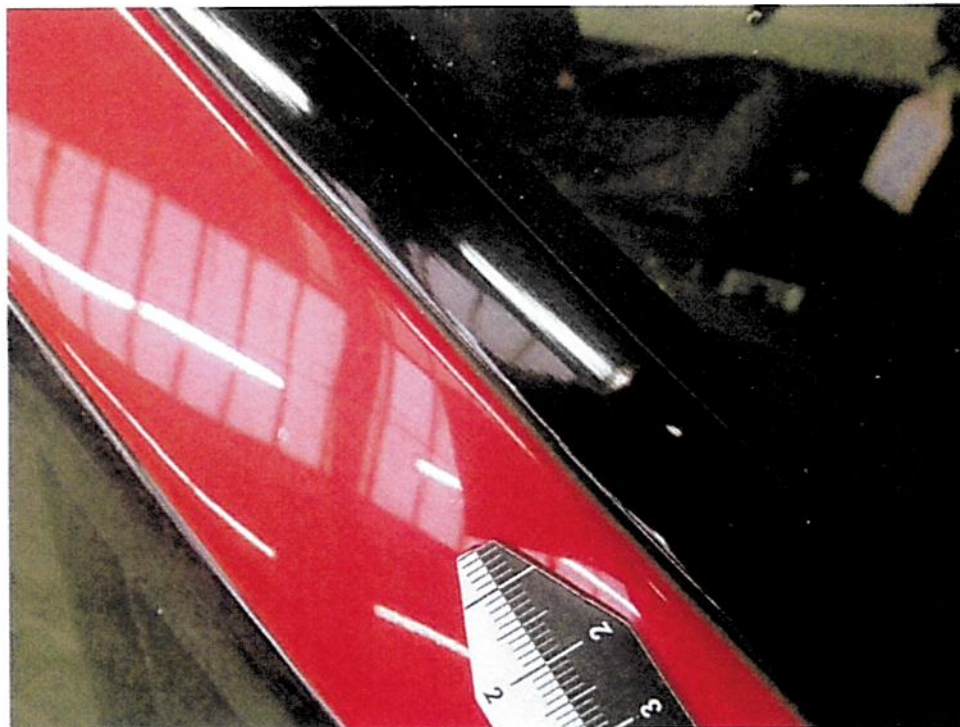
Bild 34 : Steinschlag mit Delle an der rechten A-Säule
