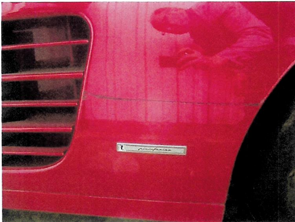
Bild 28 : Seitenwand links verschrammt
