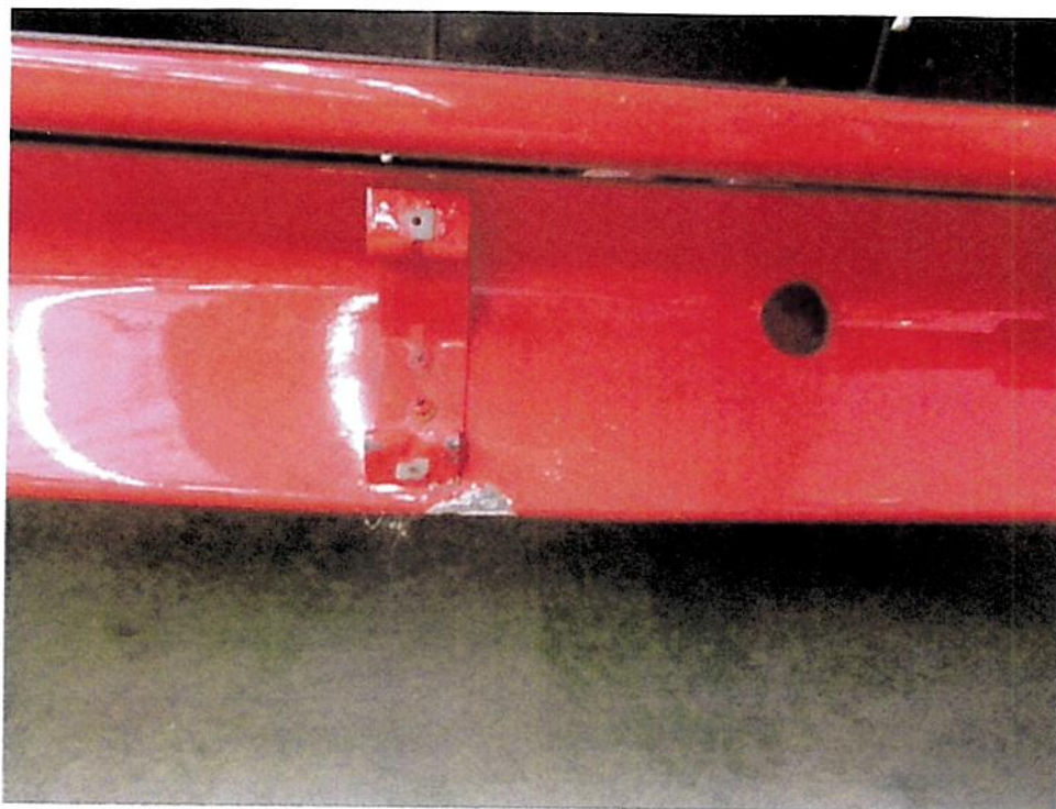
Bild 25 : Lackkratzer am Stoßfänger und Spoiler vorn
