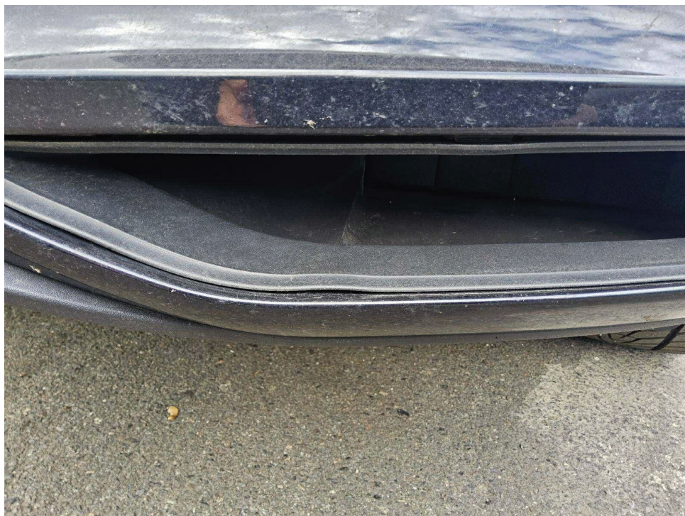
Bild 6 : Lufteinlassgitter linksseitig verformt
