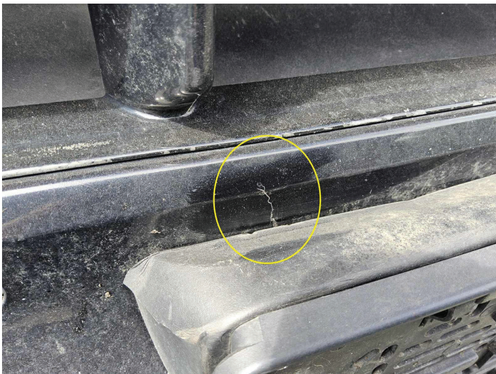
Bild 12 : Stoßfänger und Kennzeichenunterlage gerissen und Parksensor eingedrückt
