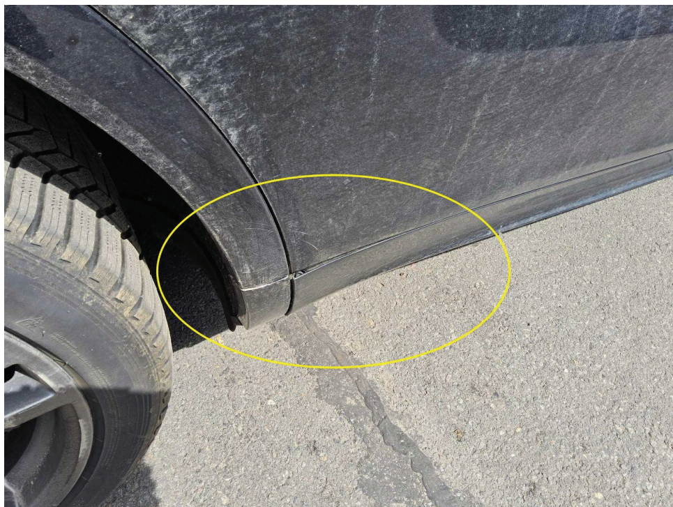
Bild 10 : Blende Tür hinten rechts unterhalb abstehend
