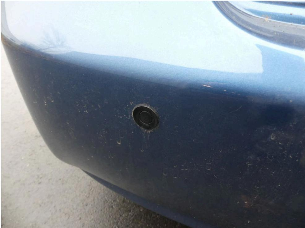
Bild: 39 Einzelansicht Einparkhilfe hinten
