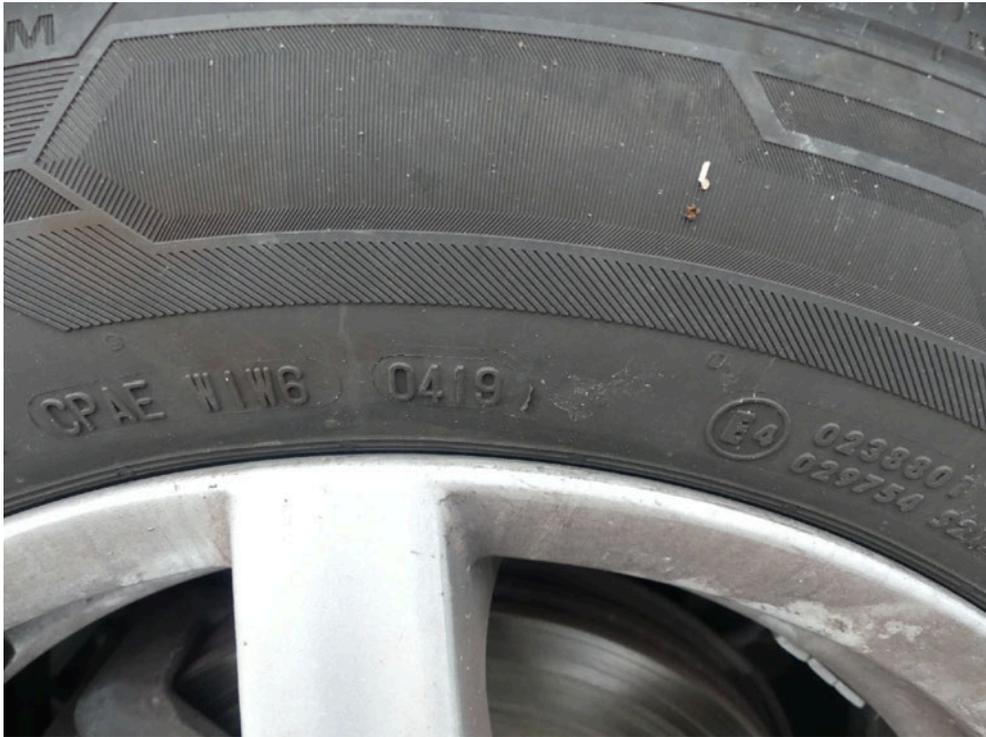
Bild: 13 Ausweisung der DOT Nummer der Radialreifen Vorderachse
