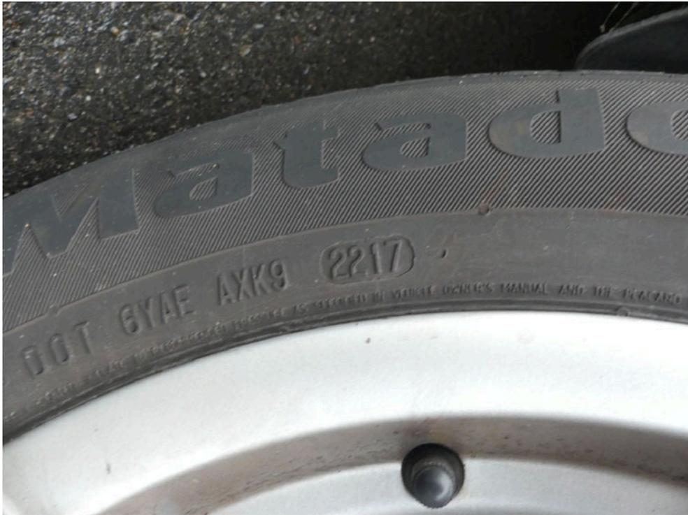
Bild: 17 Ausweisung der DOT Nummer der Radialreifen Hinterachse
