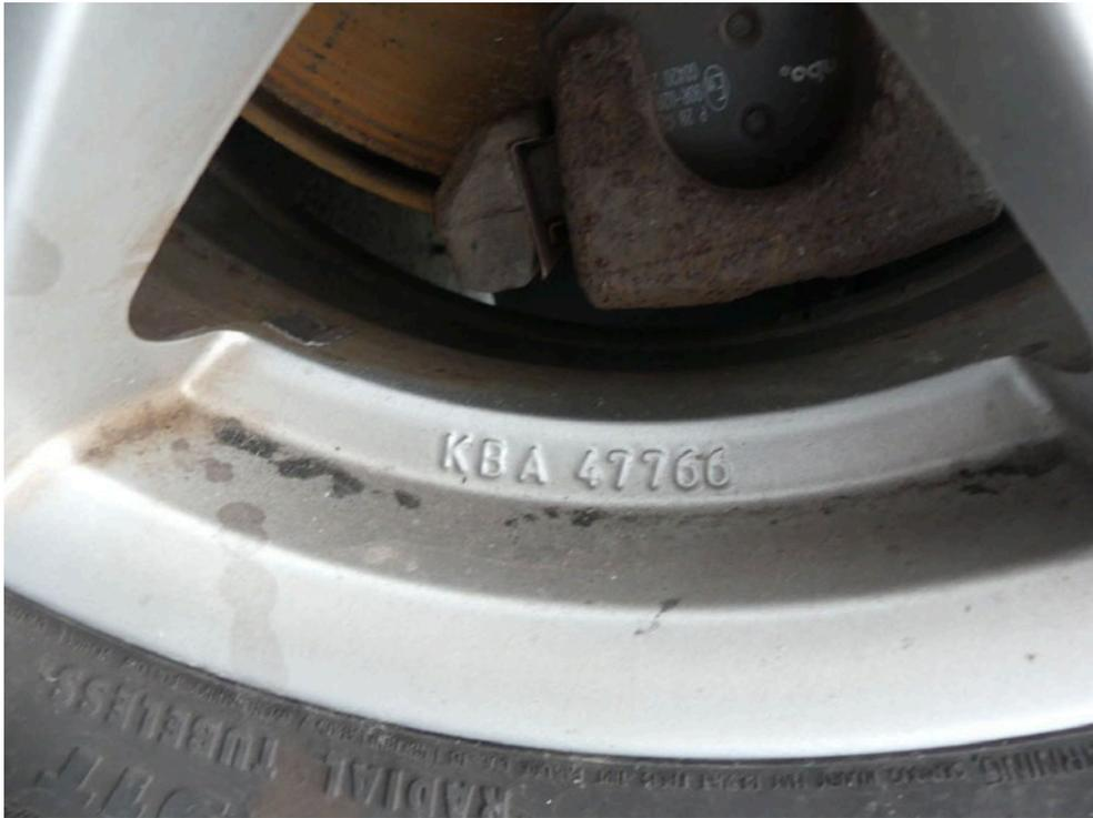
Bild: 15 Ausweisung KBA Nummer der LM-Felgen.
