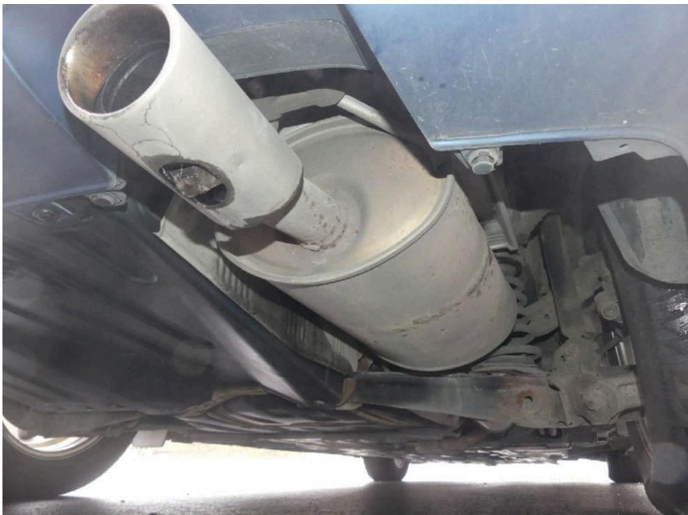
Bild: 26 Detailansicht Endschalldämpfer
