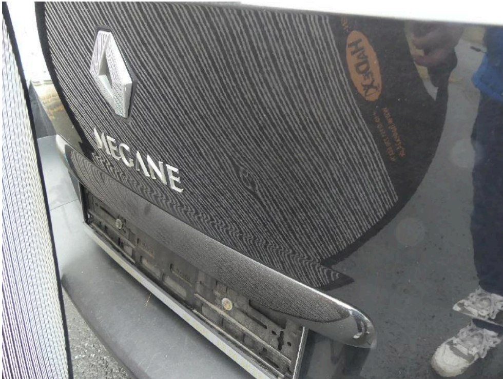
Bild: 65 Heckklappe punktuell gestaucht
