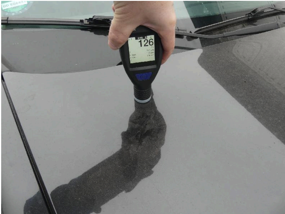
Bild: 39 Ausweisung Lackschichtdickenmessung vorgenommen, Messwerte dem beiliegenden Protokoll entnehmen.
