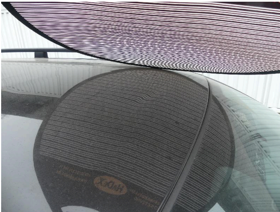
Bild: 52 Fahrzeugdach deformiert.
