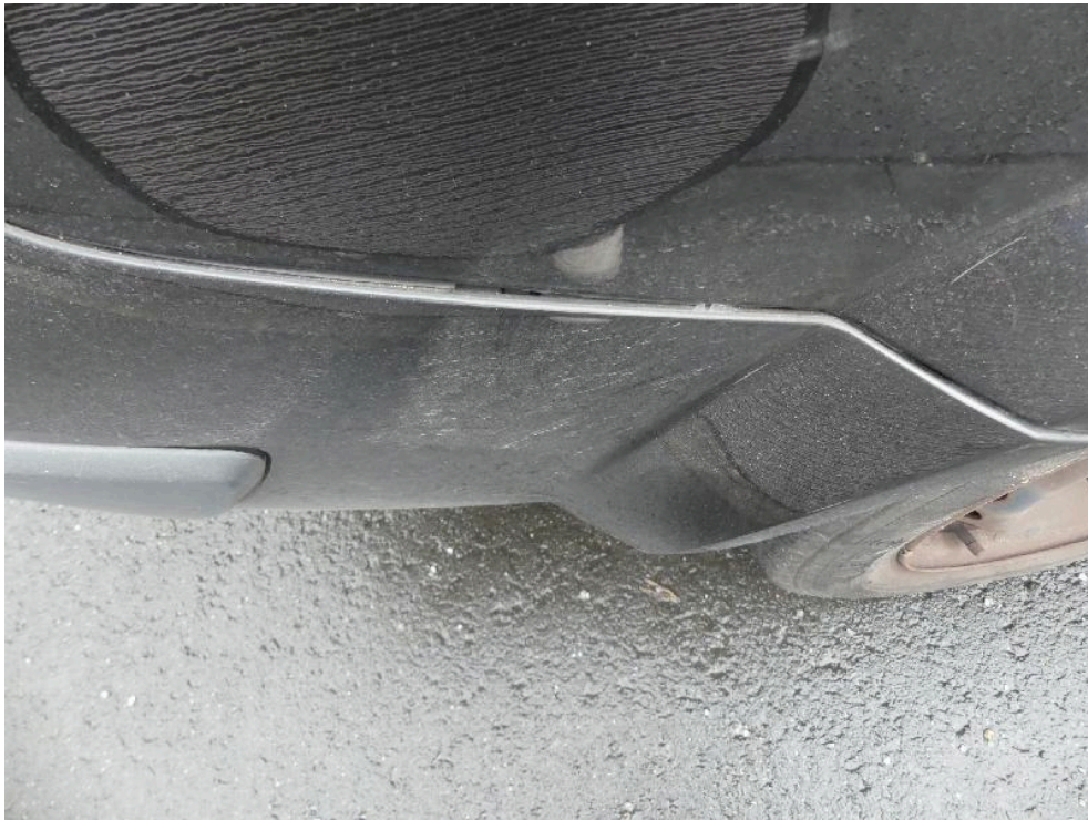
Bild: 59 Heckverkleidung weist rechtsseitig eine veränderte Einbaulage auf.
