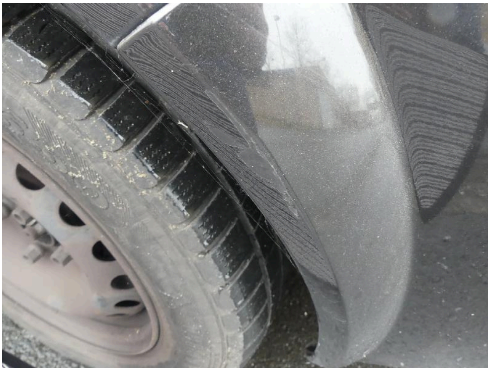
Bild: 50 Frontverkleidung rechts im Lackaufbau abgetragen.
