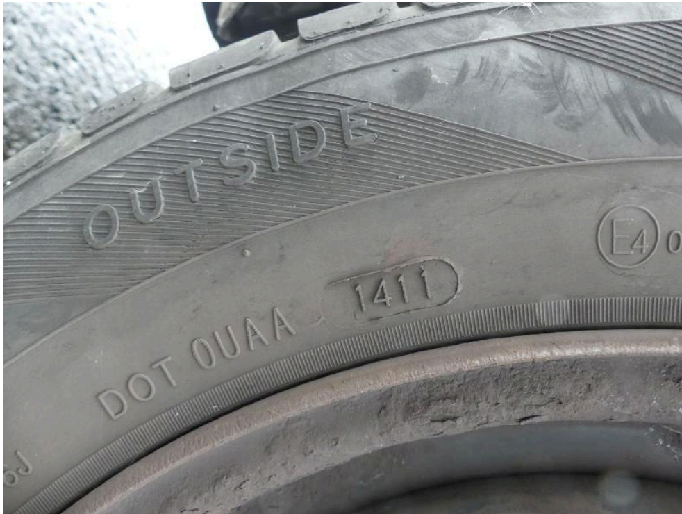
Bild: 45 Ausweisung der DOT Nummer der Radialreifen
