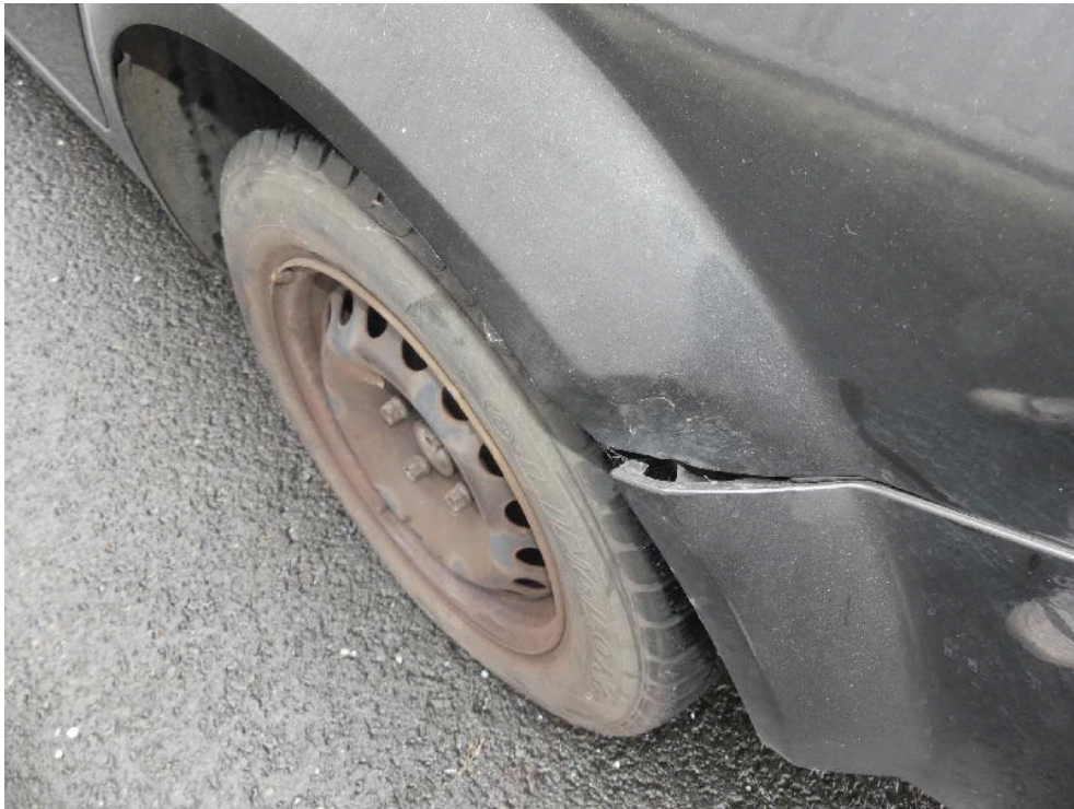
Bild: 71 Seitenwand links deformiert.
