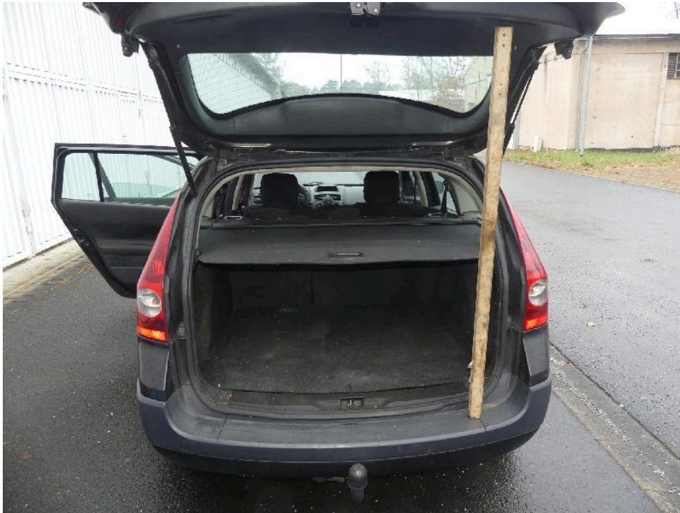
Bild: 25 Ansicht Kofferraum bei geöffneter Heckklappe, die Gasdruckdämpfer sind ohne Funktion.
