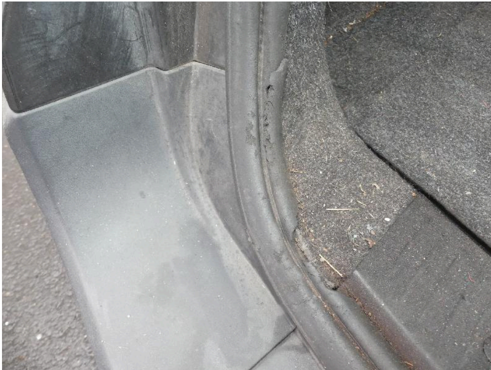
Bild: 69 Dichtung Heckklappe beschädigt.
