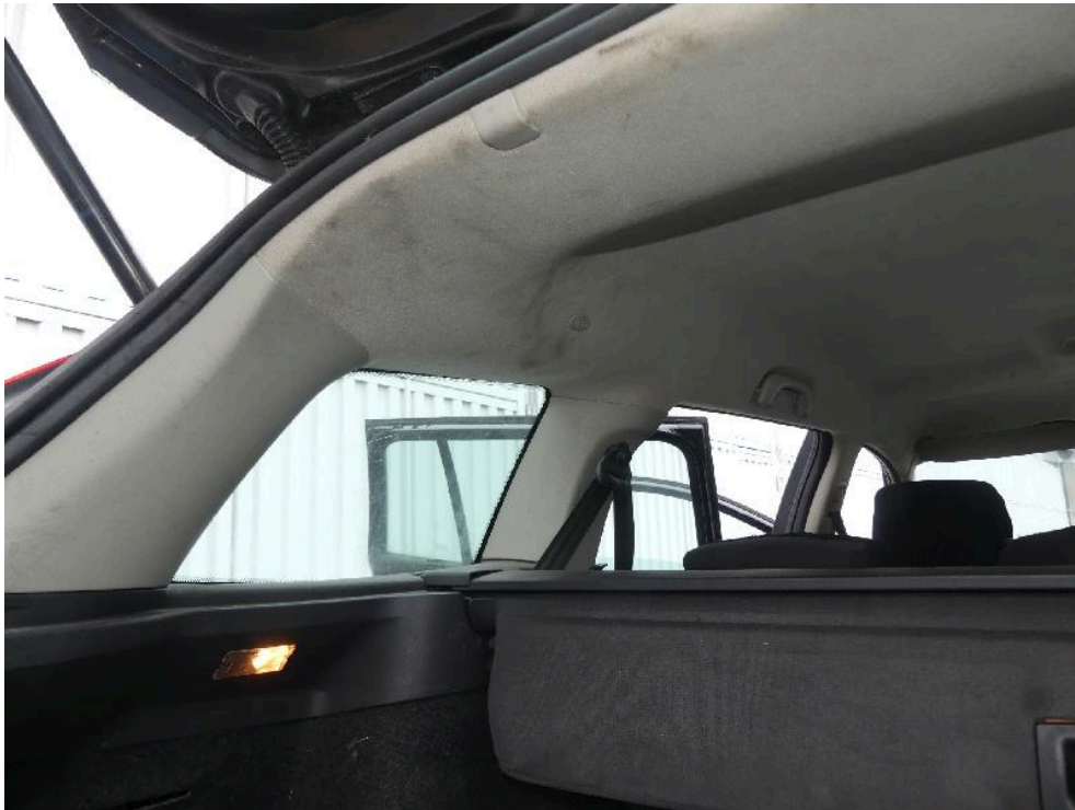
Bild: 27 Verschmutzung Innenraum
