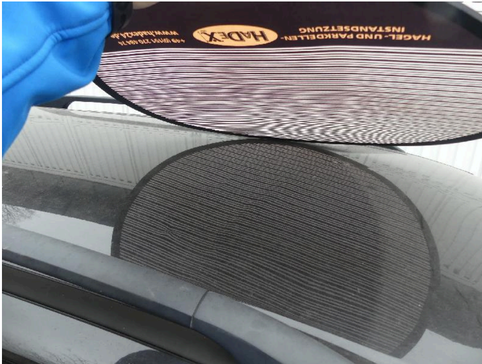
Bild: 51 Fahrzeugdach deformiert.
