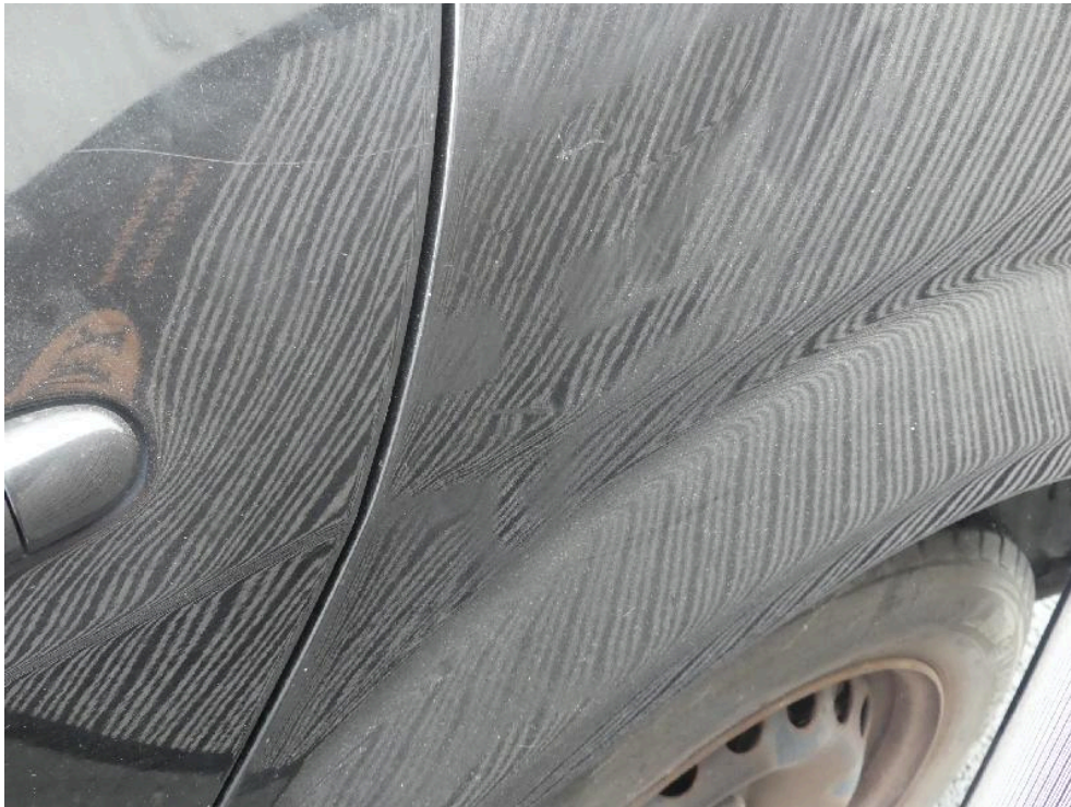
Bild: 73 Seitenwand links beschädigt.
