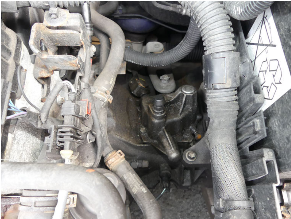
Bild: 23 Ausweisung Verölung Motorraum
