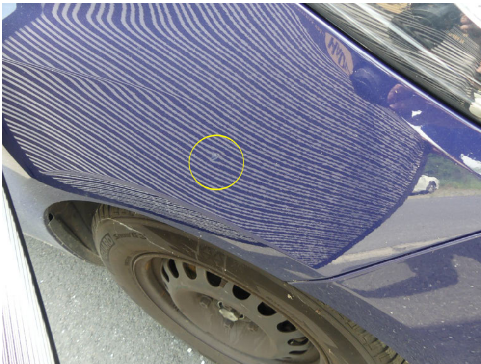
Bild: 32 Ausweisung Parkkdelle Kotflügel rechts
