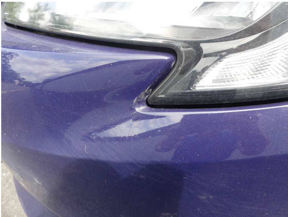
Bild: 30 Ausweisung Anstosspuren Hauptscheinwerfer links
