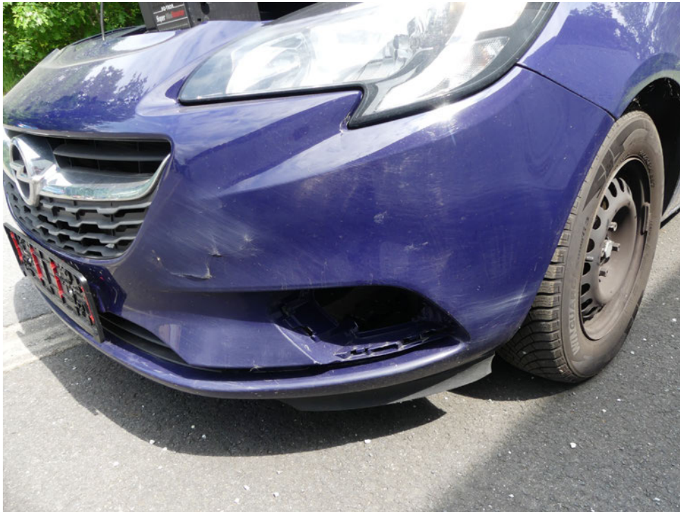
Bild: 27 Ausweisung Beschädigung Frontverkleidung ...
