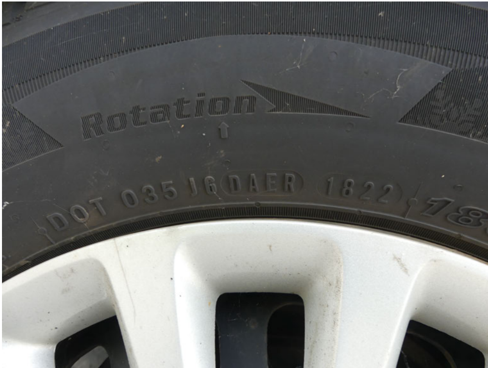
Bild: 25 Ausweisung der DOT Nummer der Radialreifen
