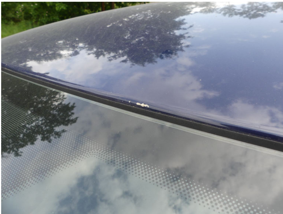
Bild: 26 Ausweisung Beschädigung Fahrzeugdach im vorderen Segment
