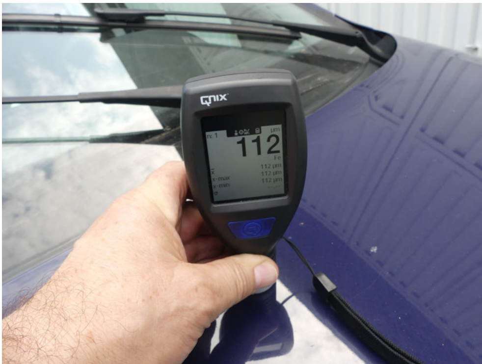
Bild: 38 Ausweisung Lackschichtdickenmessung vorgenommen, Messwerte dem beiliegenden Protokoll entnehmen.
