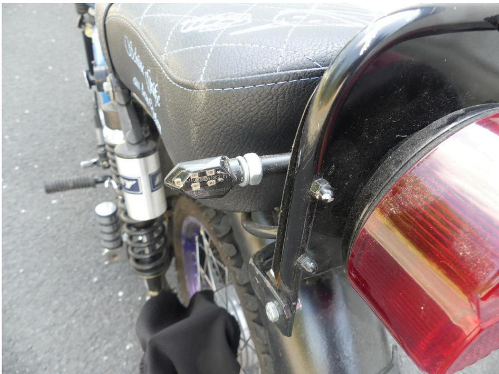
Bild: 30 Richtungsanzeiger hinten LED
