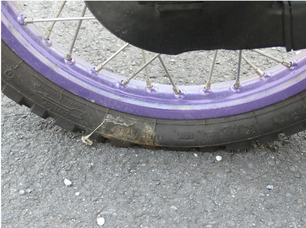
Bild: 25 Reifen Hinterrad aktuell verminderter Reifendruck.
