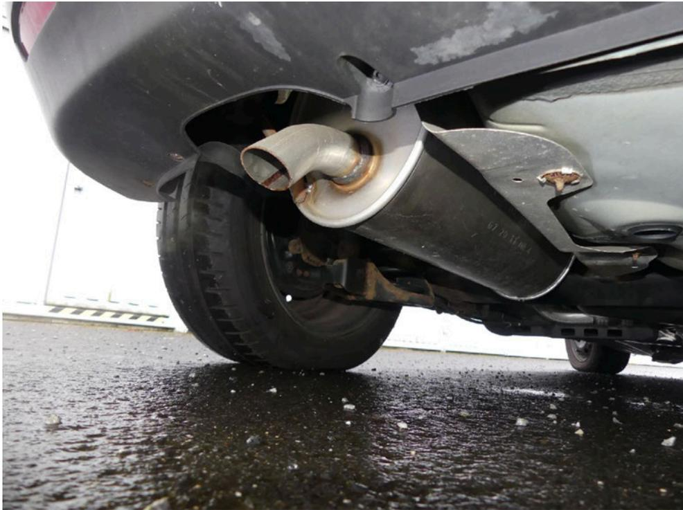
Bild: 51 Detailansicht Endschalldämpfer
