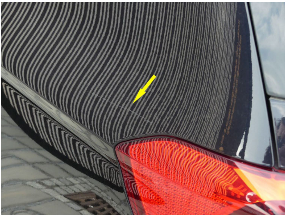
Bild: 58 Fortführend ist die linke Seitenwand streifend im Lackaufbau verkratzt.
