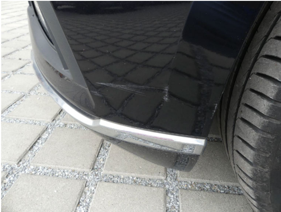
Bild: 53 Weiterführend ist die Frontverkleidung im unteren Segment streifend markiert.
