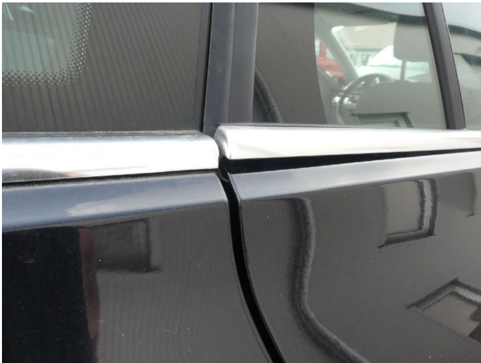
Bild: 65 ... die Fensterschachtabdeckung ist im hinteren Bereich partiell lose.
