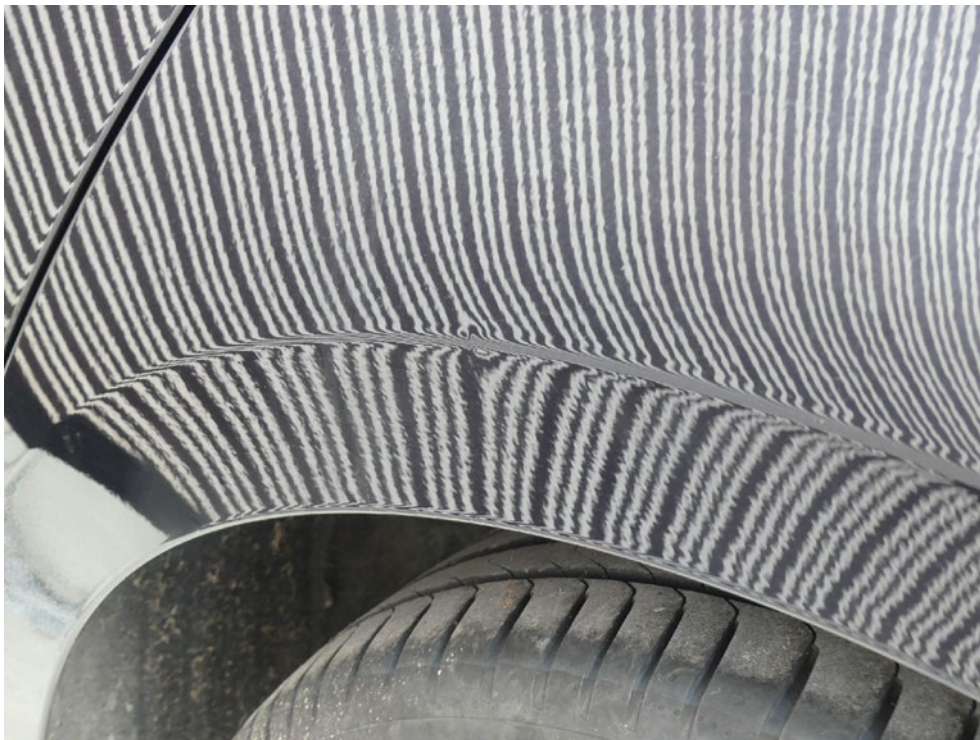
Bild: 57 Seitenwand links punktuell im Radlaufbogen gestaucht.
