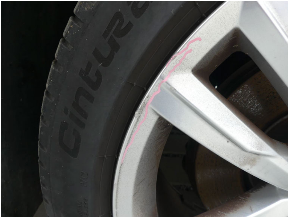
Bild: 21 LM-Felge vorn rechts beschädigt.
