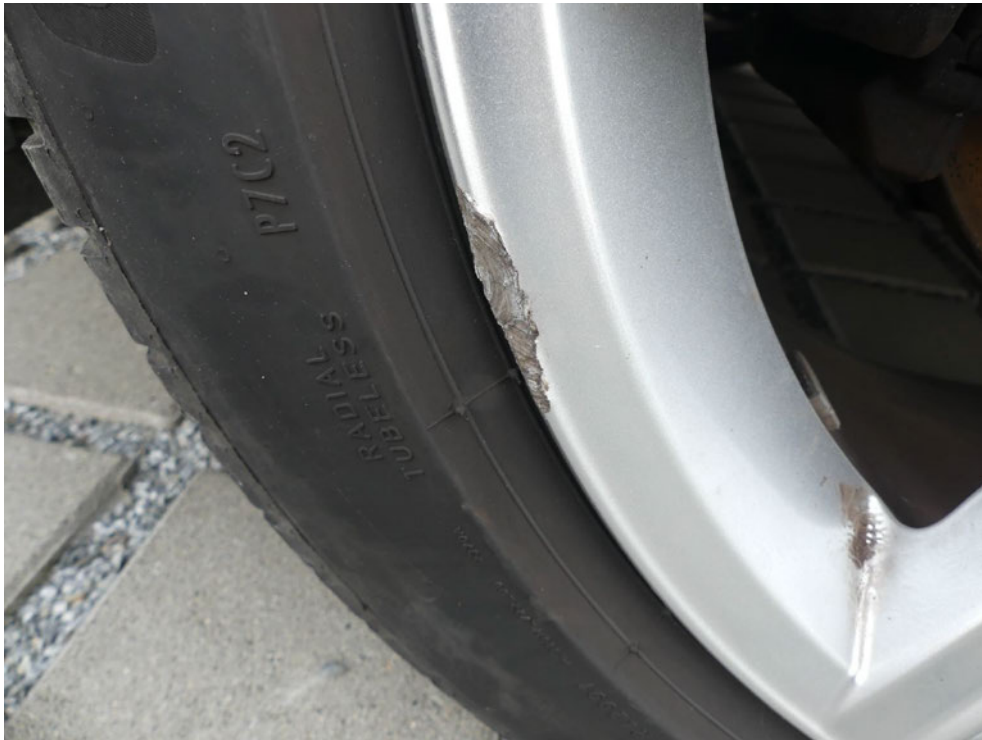
Bild: 15 LM-Felge vorn links partiell beschädigt.
