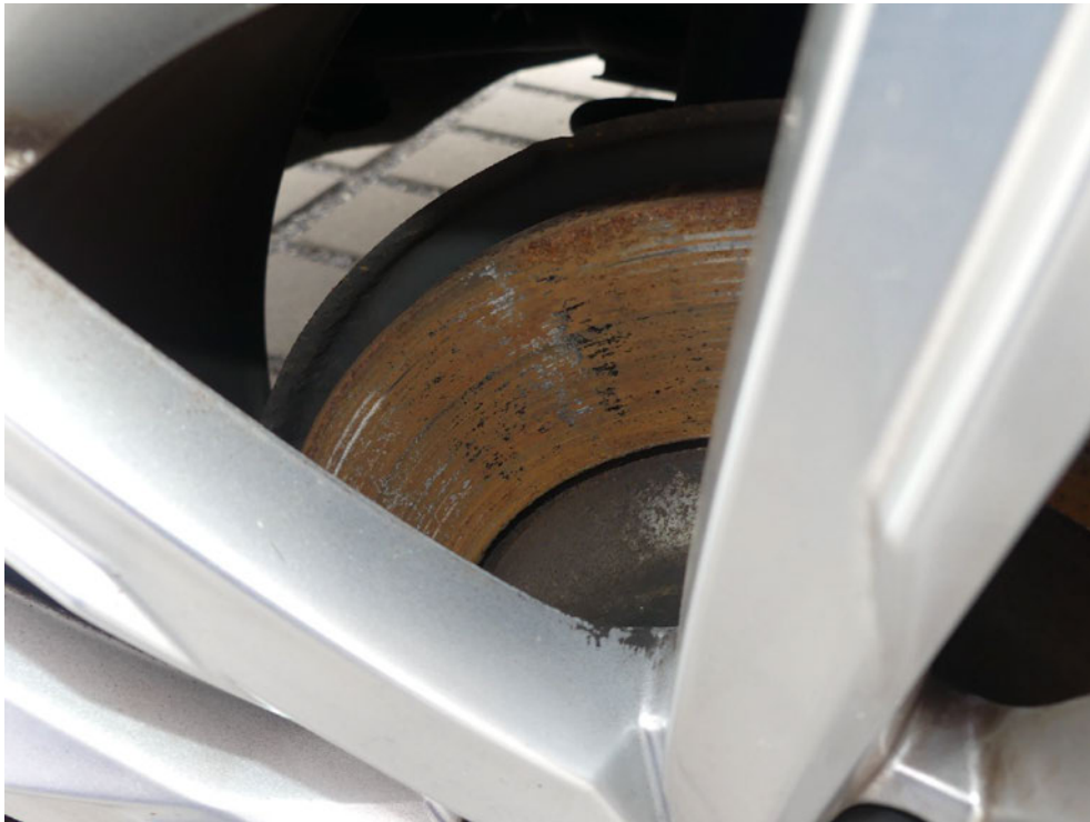
Bild: 23 Standschaden Bremsanlage
