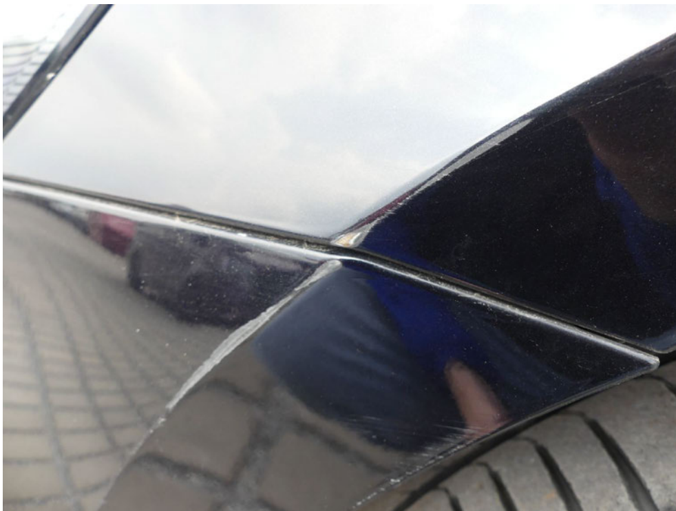
Bild: 52 ... diese sind beidseitig im Lackaufbau abgetragen.
