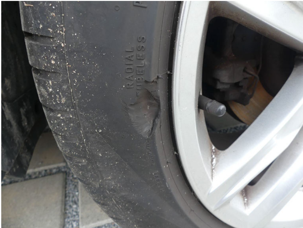
Bild: 17 Reifen hinten links partiell ausgebrochen.
