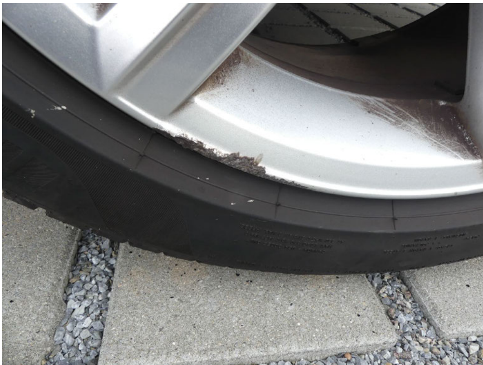
Bild: 18 Weiterführend ist die LM-Felge hinten links beschädigt.
