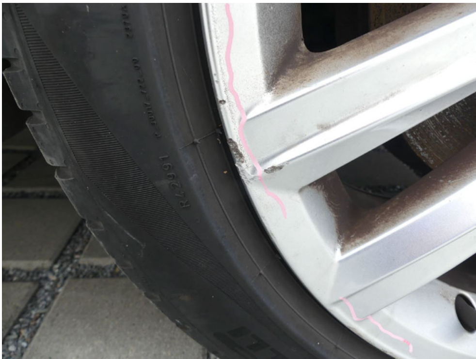
Bild: 22 Ausweisung weitere Beschädigung der LM-Felge vorn rechts
