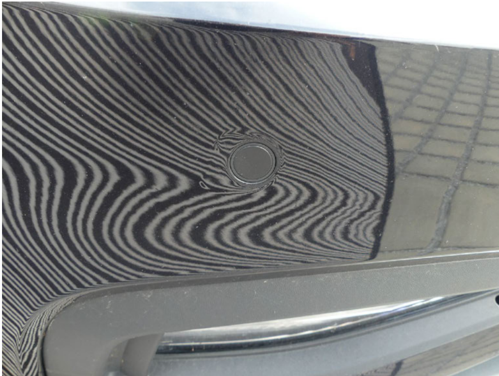
Bild: 55 .... diese ist nachlackiert, im Bereich der Einparksensoren ist ein Qualitätsdefizit feststellbar.
