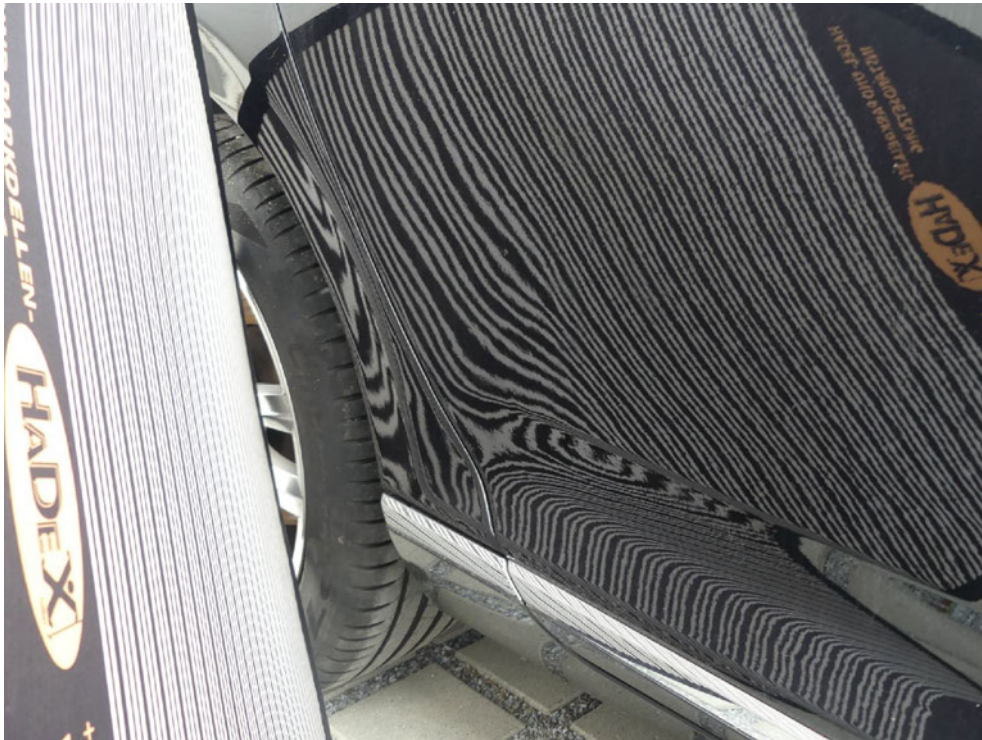
Bild: 63 Ansicht Fondtür rechts, die Lackoberfläche stellt sich unruhig dar, eine Nachlackierung ist erfolgt.
