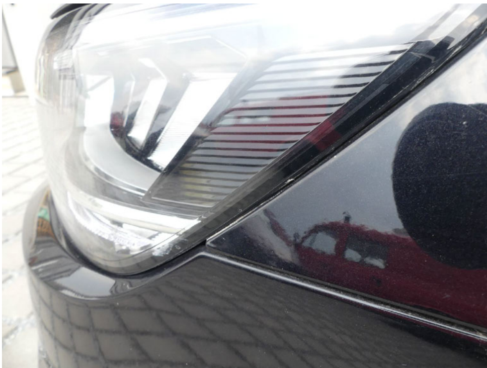
Bild: 50 Klebebandrückstände am linken Kotflügel anhaftend.
