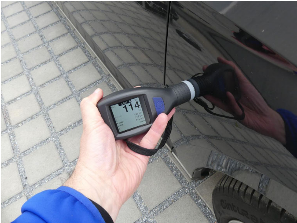
Bild: 49 Ausweisung Lackschichtdickenmessung vorgenommen, Messwerte dem beiliegenden Protokoll entnehmen.
