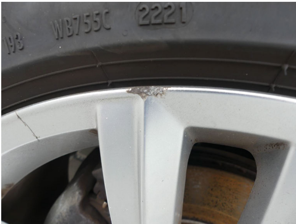
Bild: 14 LM-Felge vorn links partiell beschädigt.
