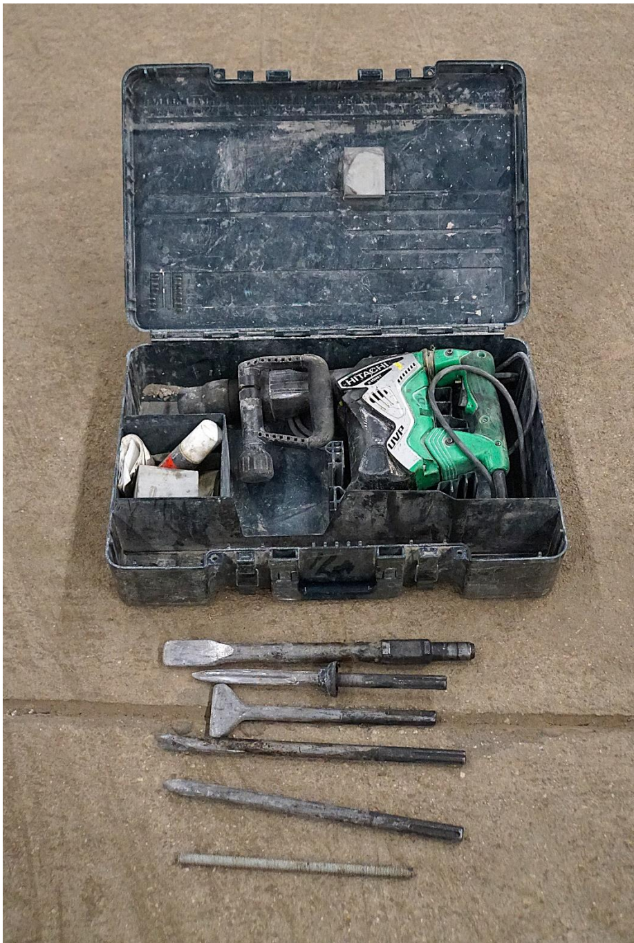
Hitachi Meißelhammer H45 MRY in Koffer mit Aufsätzen
