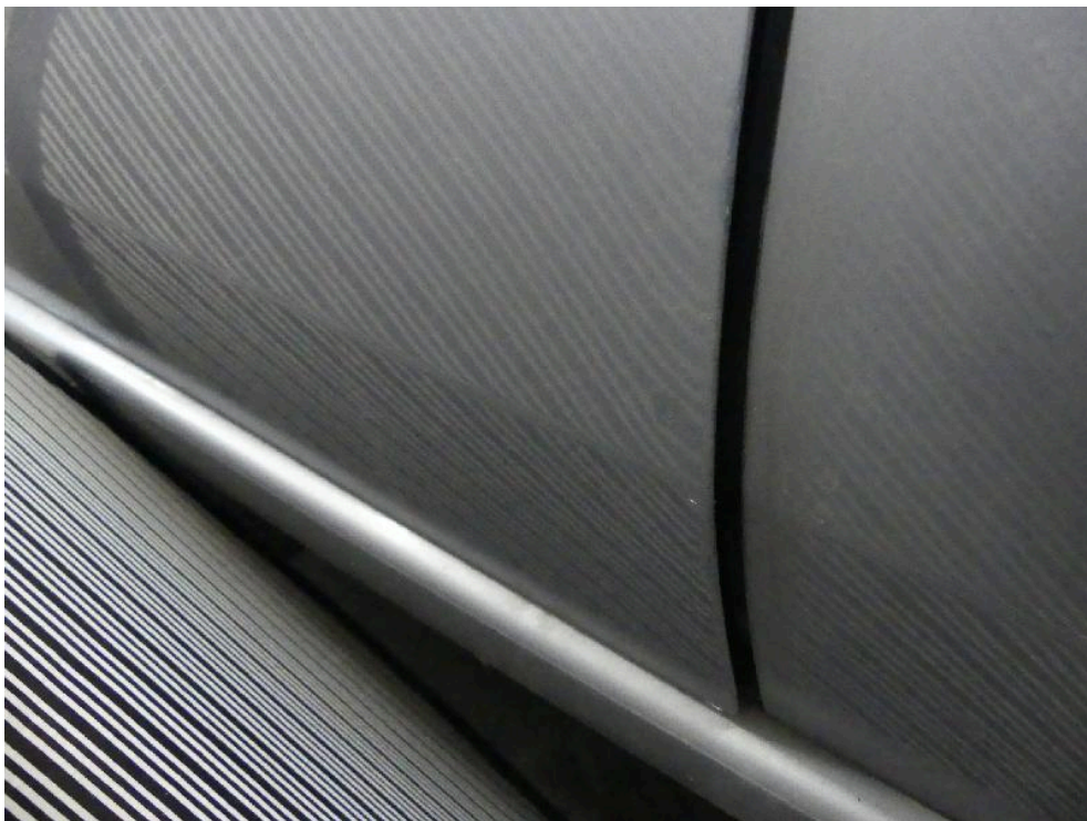
Bild: 53 Fahrertür im unteren hinteren Segment gestaucht.
