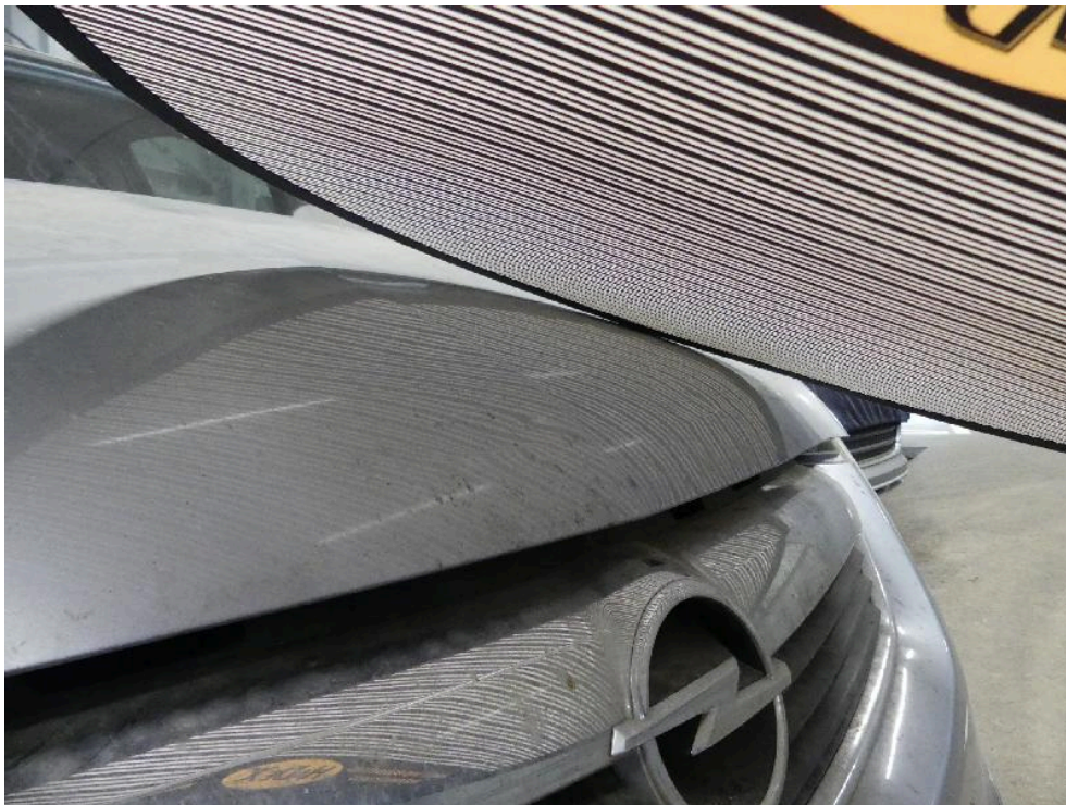
Bild: 48 ... diese ist im vorderen Segment deformiert.
