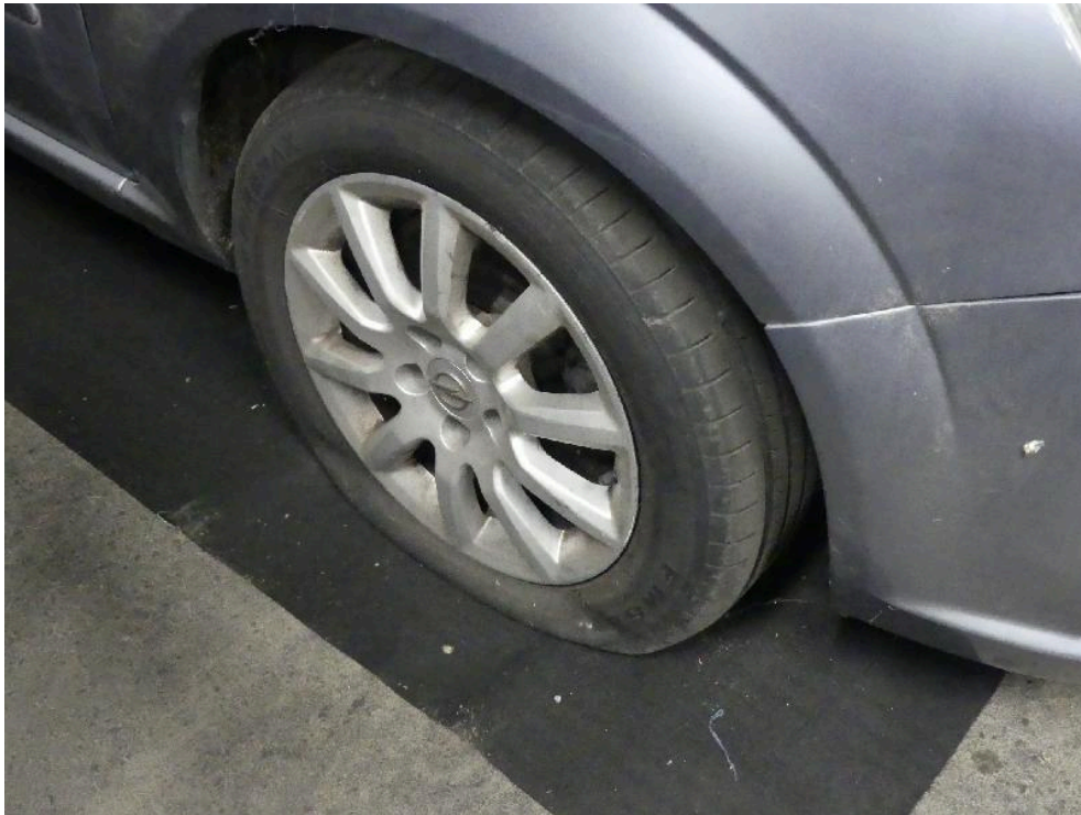
Bild: 37 Reifen vorn rechts drucklos.
