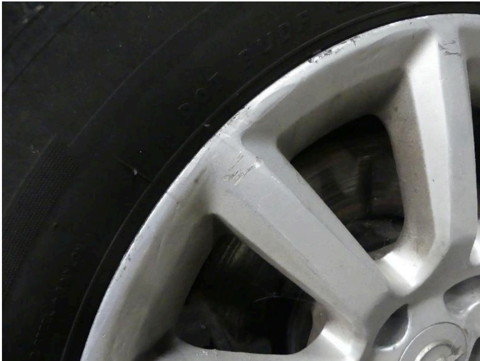
Bild: 39 LM-Felge beschädigt
