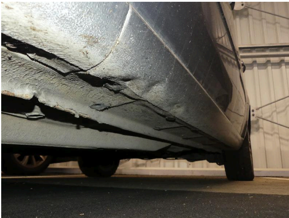
Bild: 51 Schweller links im vorderen Segment deformiert.
