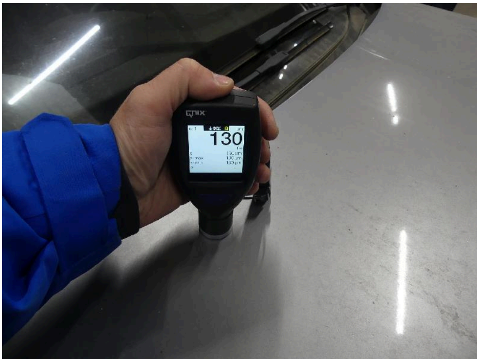
Bild: 8 Ausweisung Lackschichtdickenmessung vorgenommen, Messwerte dem beiliegenden Protokoll entnehmen.
