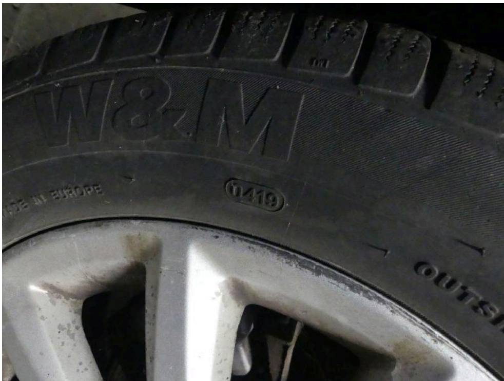
Bild: 42 Ausweisung der DOT Nummer der Radialreifen Hinterachse
