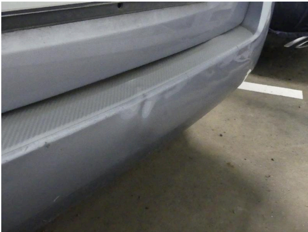
Bild: 58 Heckverkleidung deformiert.
