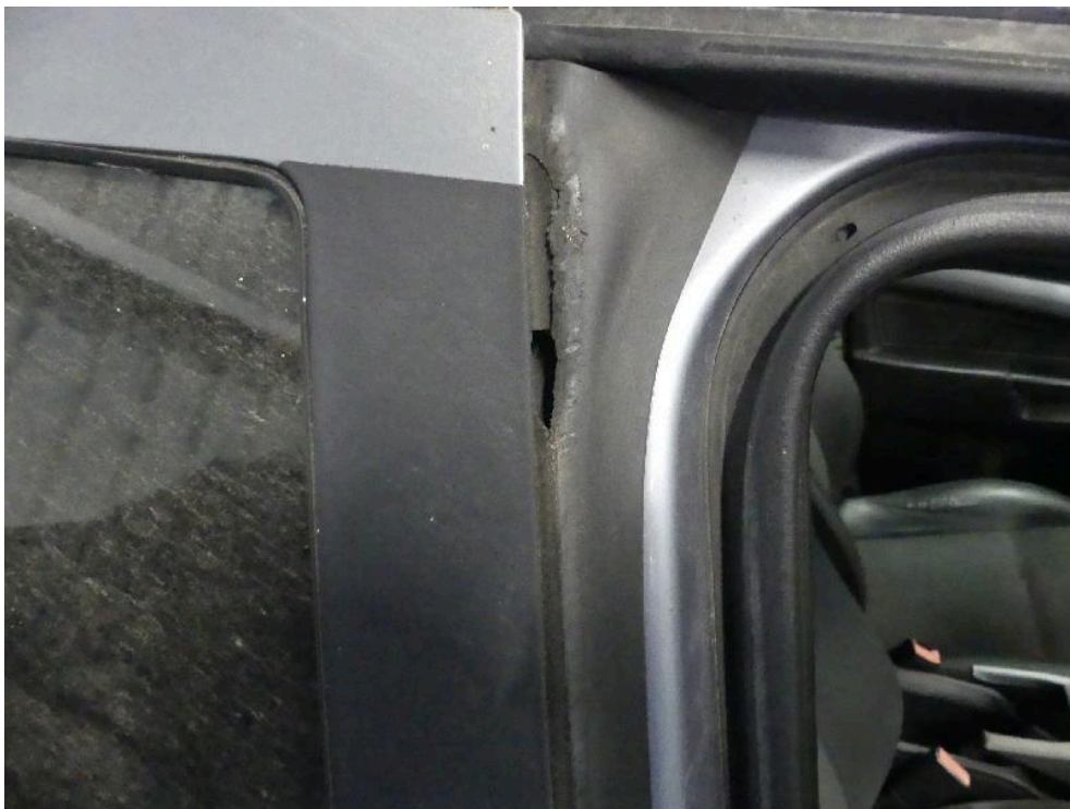
Bild: 63 Abdichtung B-Säule rechts beschädigt / verschlissen.
