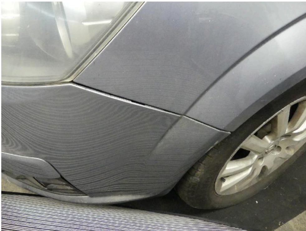
Bild: 50 Linksseitig Übergang Frontverkleidung zu dem Kotflügel sichtbar versetzt.
