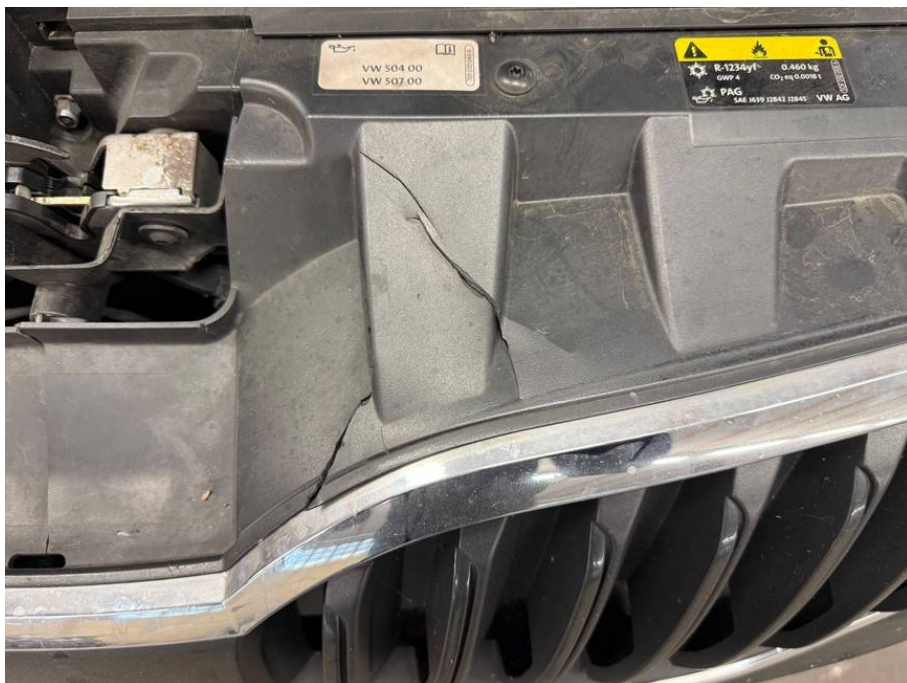
Abdeckung Kühlergrill gebrochen
