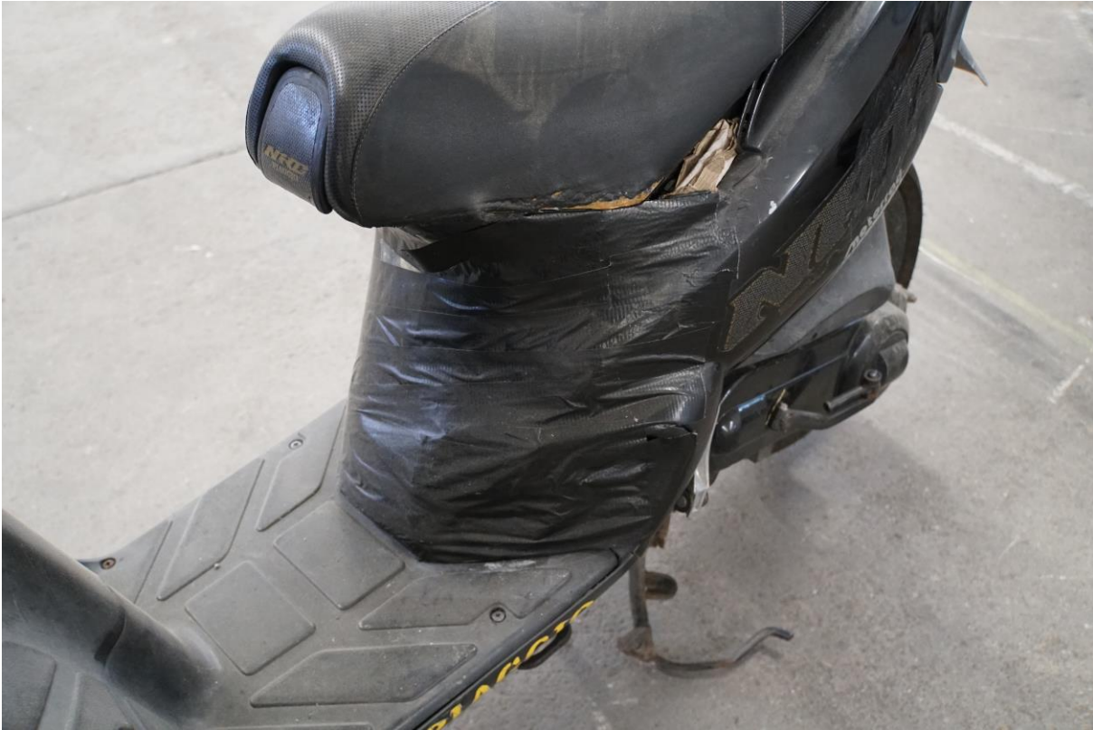
Schaden Sitzbank. Provisorisch mit Panzertape gefixt.
