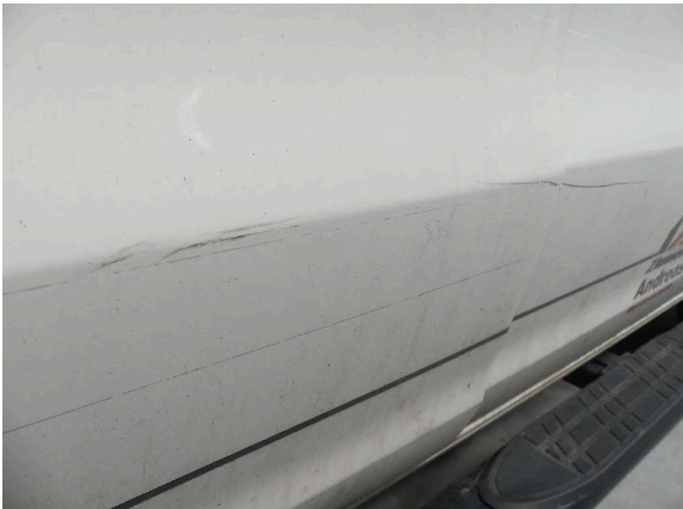
Bild: 60 Ansicht Fahrertür, diese ist streifend im Lackaufbau markiert.
