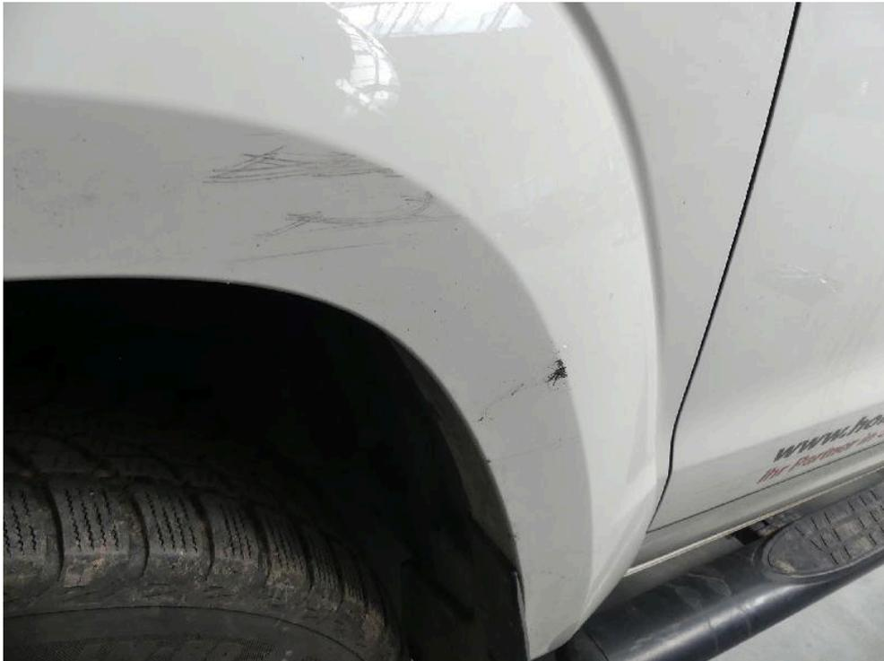
Bild: 49 Detailansicht Abdeckung Kotflügel vorn links, diese ist streifend im Lackaufbau beschädigt.
