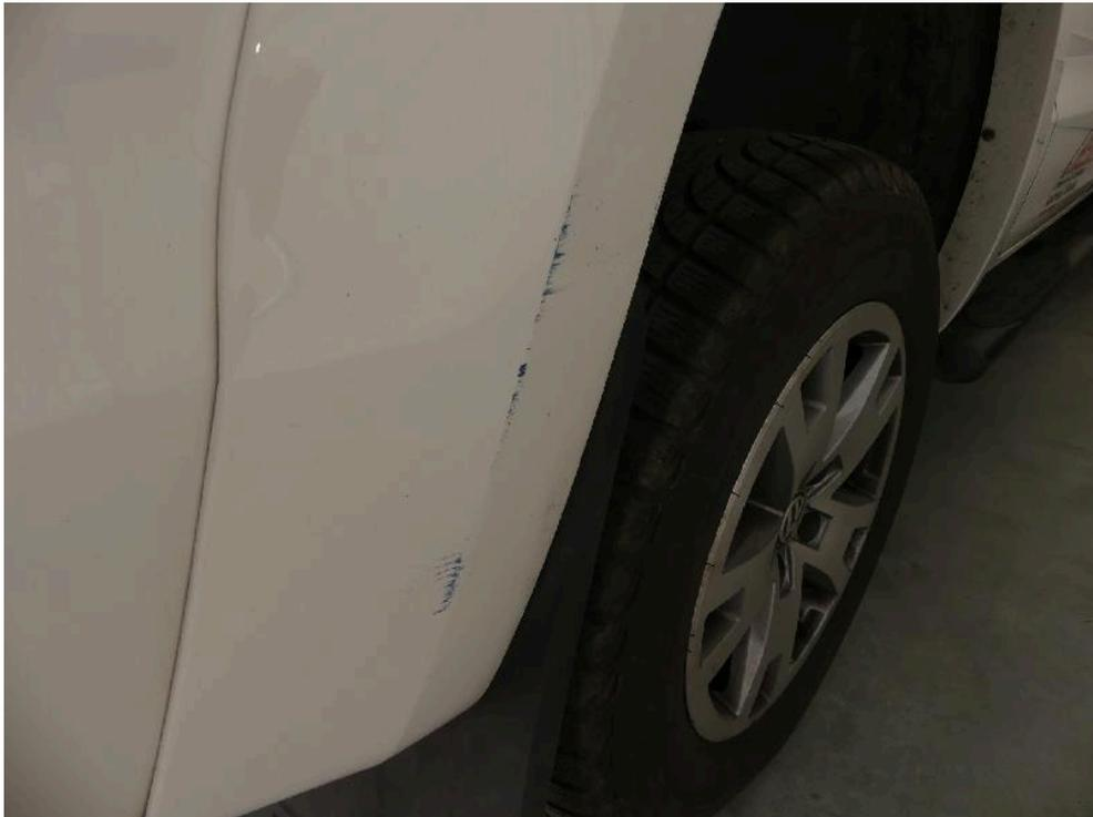
Bild: 45 Detailansicht Radverbreiterung hinten rechts, diese ist partiell im Lackaufbau verkratzt.
