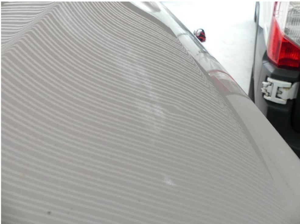
Bild: 58 punktuelle Eindellung in der Motorhaube
