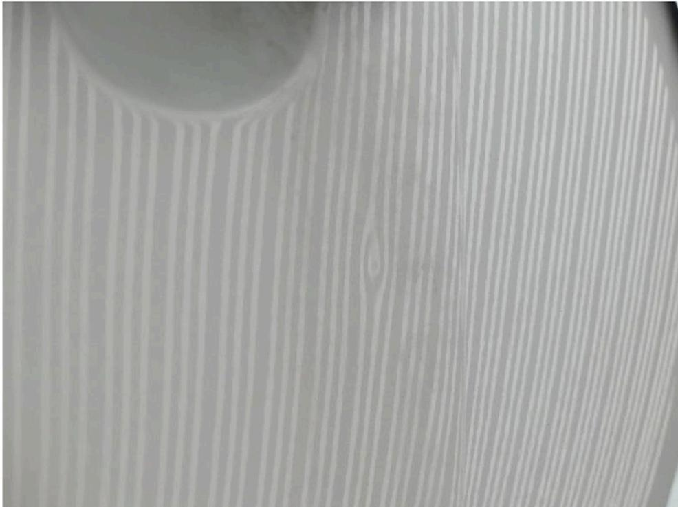
Bild: 59 Delle Fahrertür unterhalb des Türöffners.
