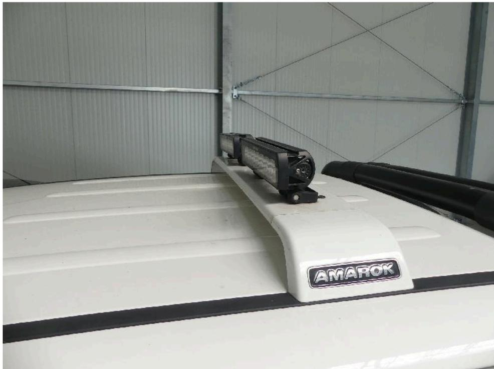
Bild: 11 Detailansicht Dachbügel mit Zusatzscheinwerfer
