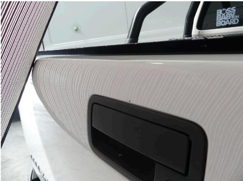
Bild: 54 Die Ladeklappe ist mehrfach im Grundmaterial gestaut.
