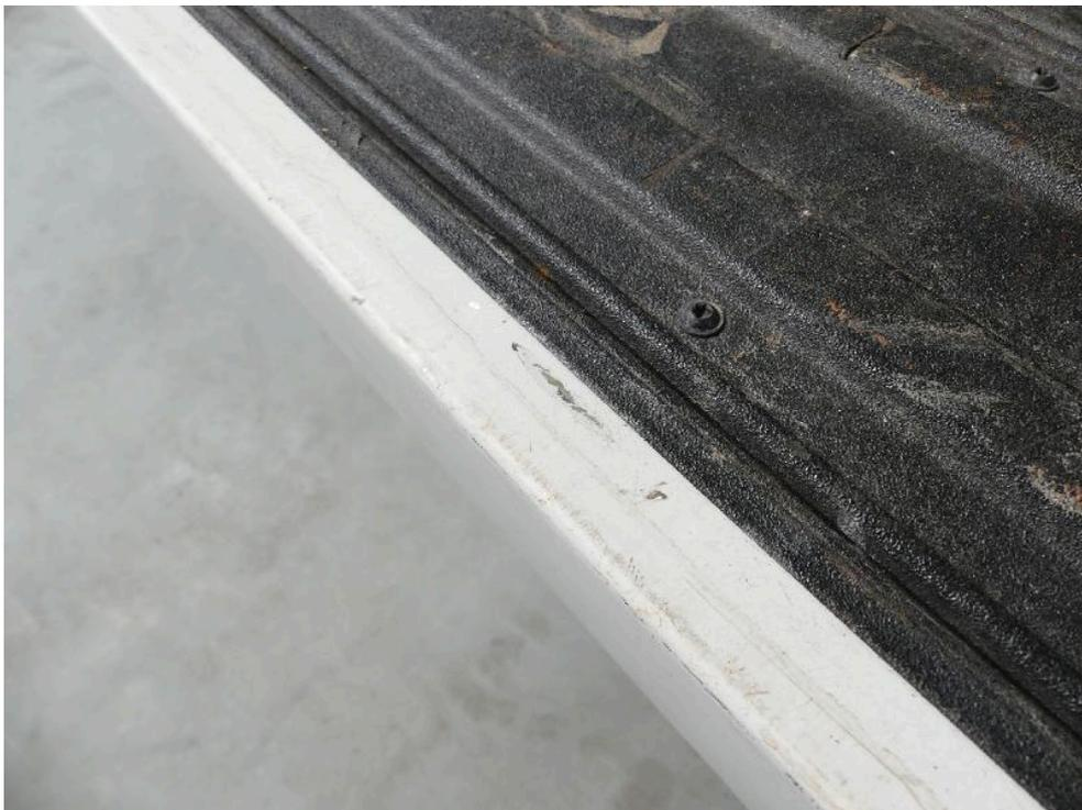
Bild: 52 Detaillierte Darstellung Ladeklappe, der Lackaufbau ist partiell abgetragen.
