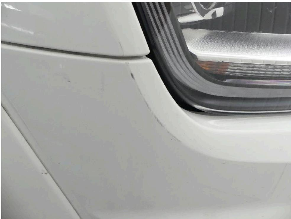
Bild: 47 Ansicht Frontverkleidung der Lackaufbau ist ebenso beschädigt.
