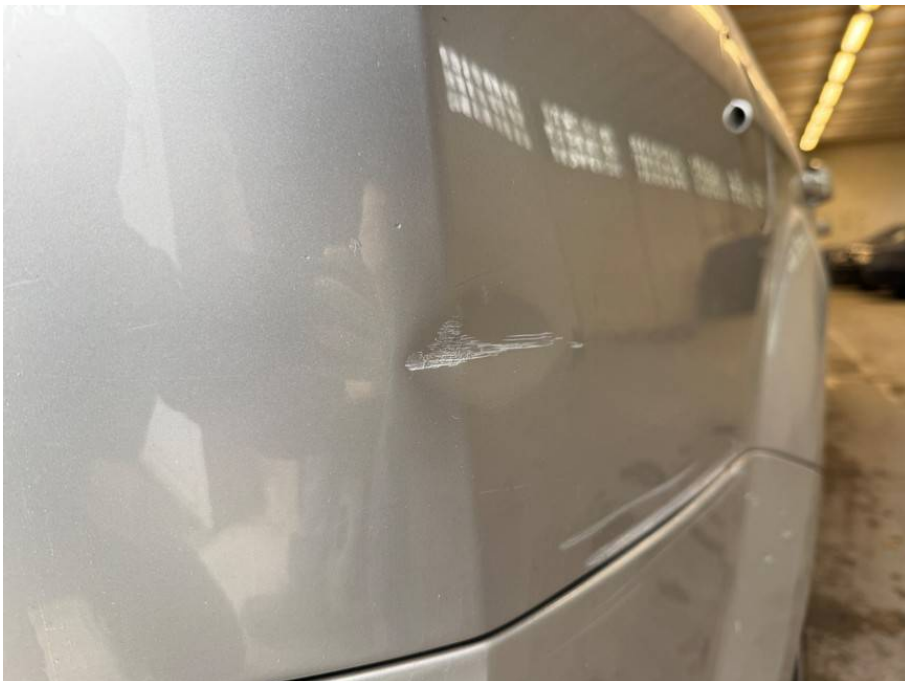
Seitenwand verkratzt und eingedellt
