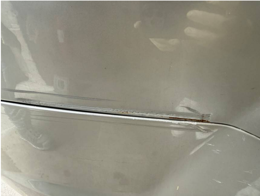
Seitenwand verkratzt und eingedellt
