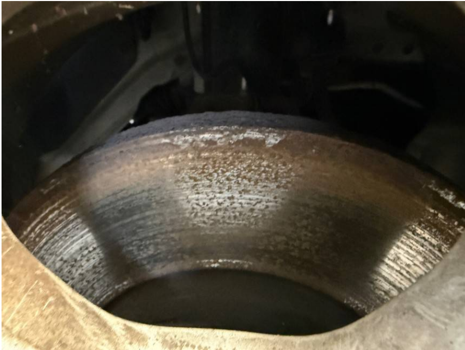
Bremsscheiben rundum stark korrodiert
