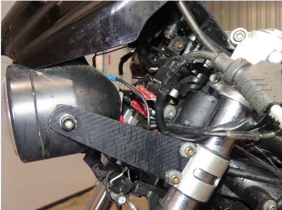
Bild: 15 Detailansicht Befestigungspunkt der Hauptscheinwerfer
