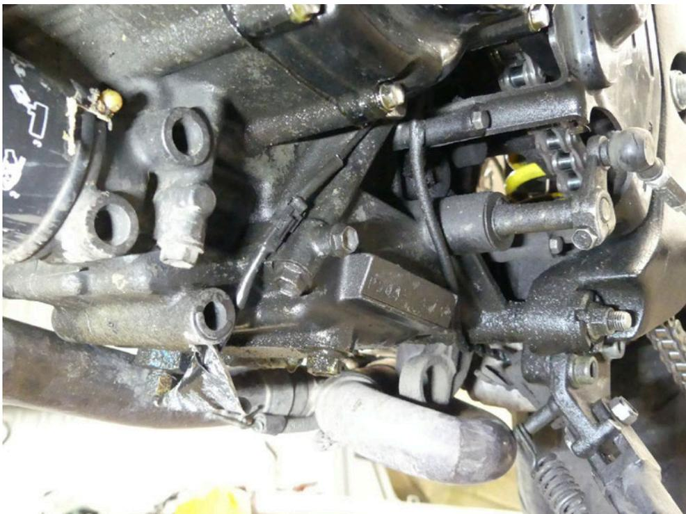
Bild: 22 Undichtigkeiten Motor vorhanden
