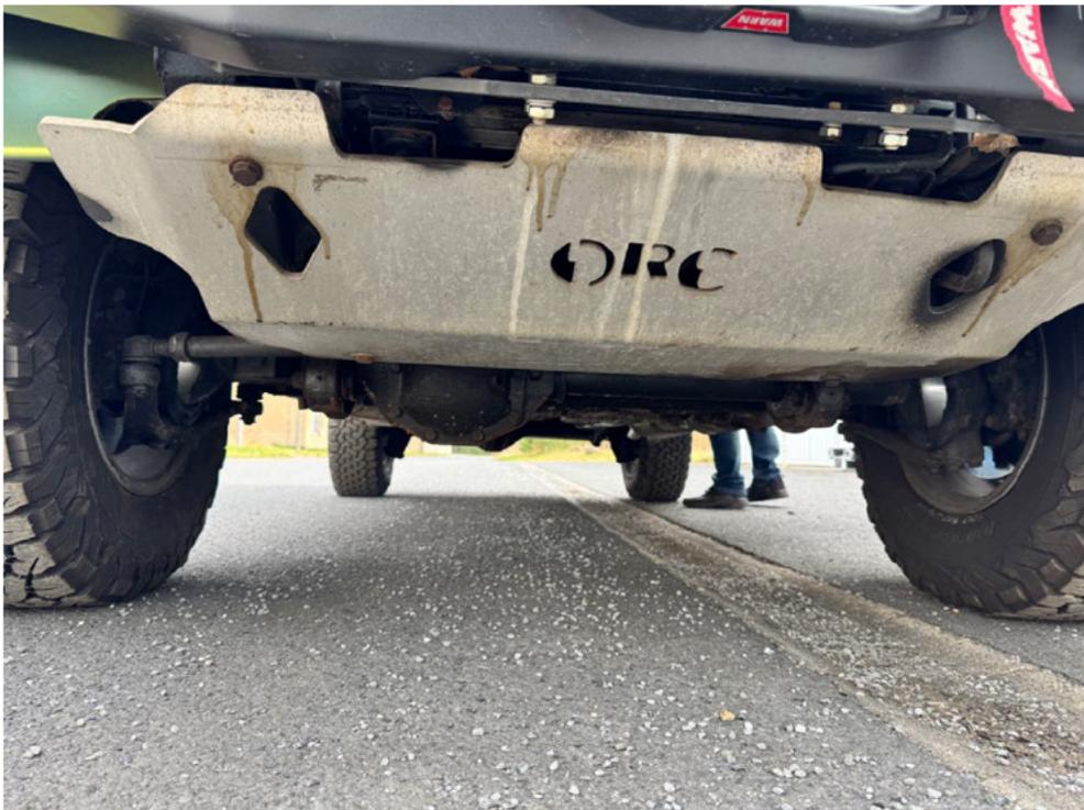
Bild: 46 Ausweisung verbauter Unterfahrschutz Hersteller ORC
