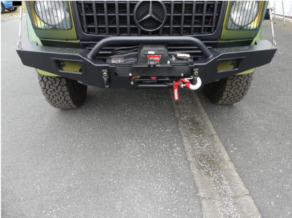
Bild: 45 Ansicht Windenstoßstange mit Seilwinde
