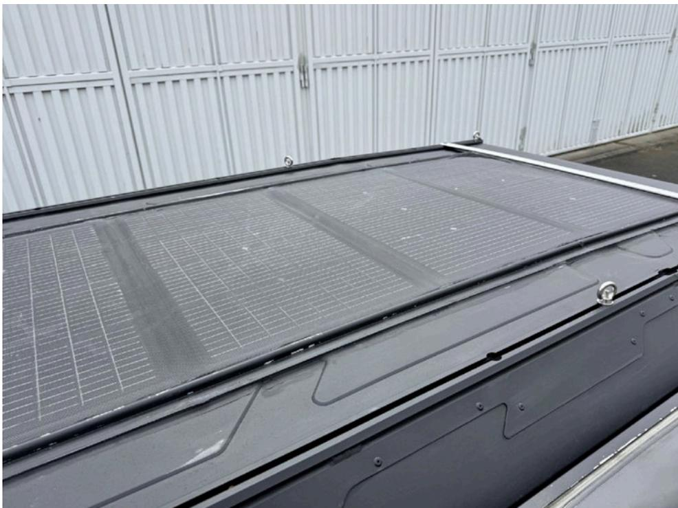
Bild: 38 Ausweisung Solarmodul Fahrzeugdach
