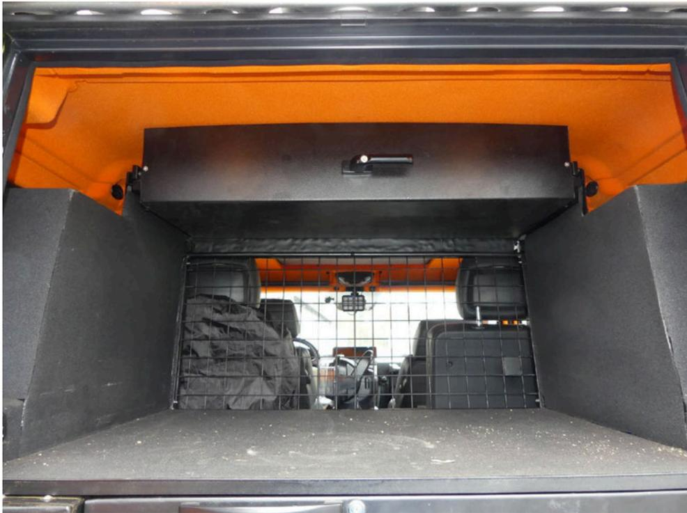
Bild: 25 Ausweisung Staufach am Fahrzeugdach innen verbaut.
