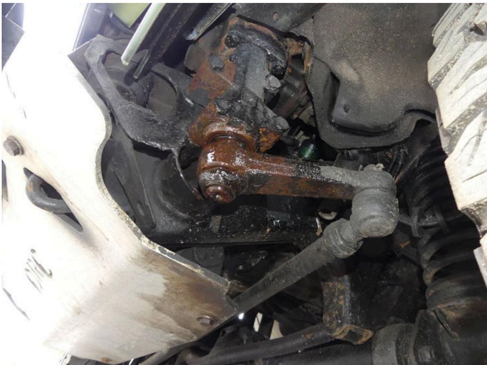
Bild: 34 Ausweisung sichtbare Undichtigkeiten Vorderachse links
