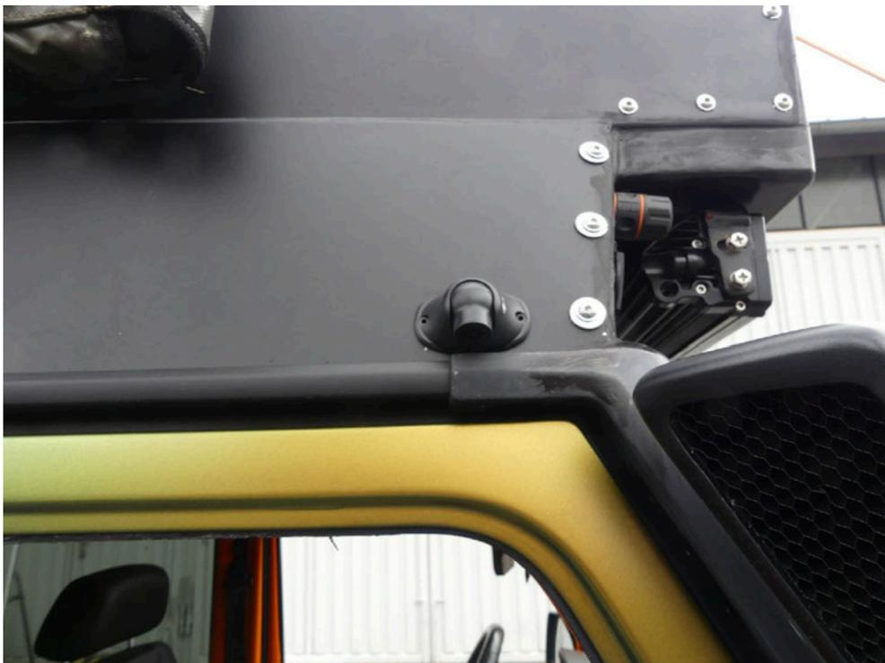
Bild: 42 Ausweisung Kamerasystem am Fahrzeug nachgerüstet
