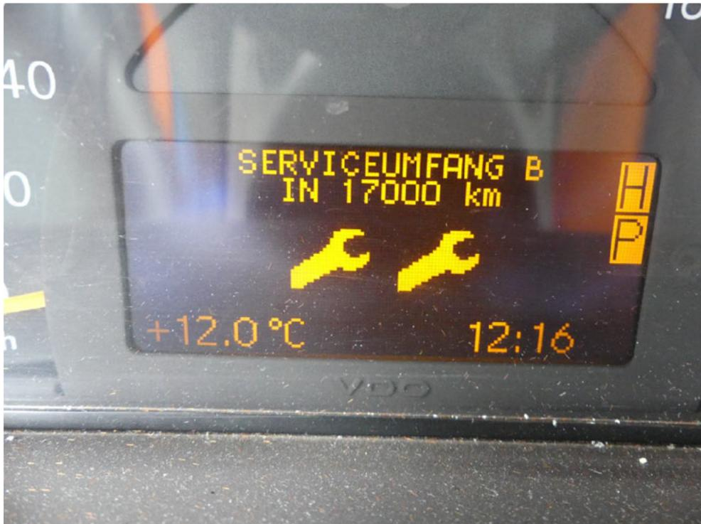
Bild: 15 Ausweisung Hinweis - Kombiinstrument
