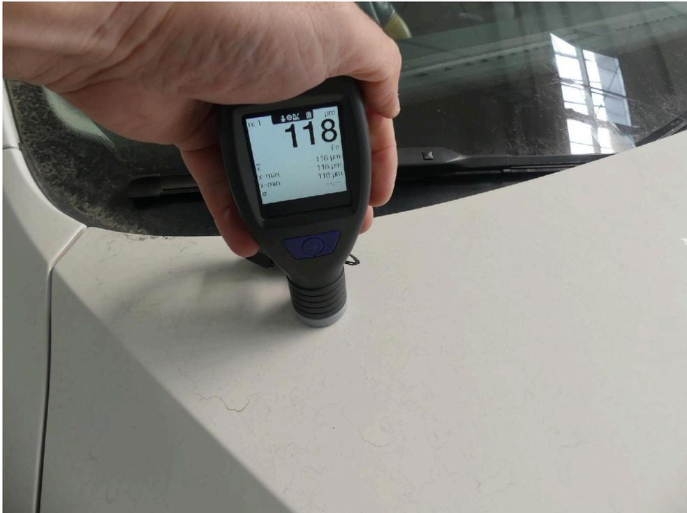
Bild: 37 Ausweisung Lackschichtdickenmessung vorgenommen, Messwerte dem beiliegenden Protokoll entnehmen.
