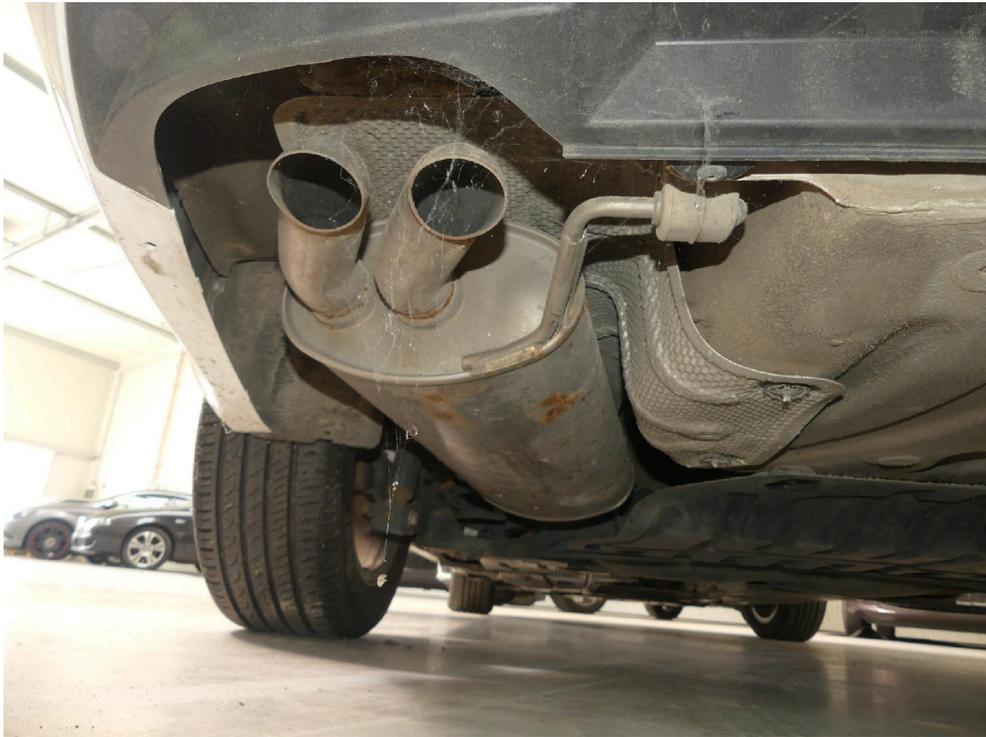
Bild: 29 Einzeldarstellung Endschalldämpfer
