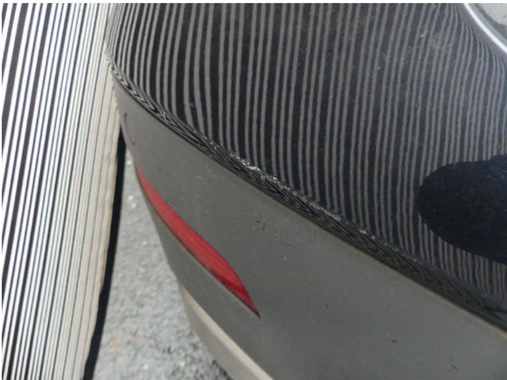
Bild: 78 Weiterführend ist der Lackaufbau der Heckverkleidung linksseitig beschädigt.
