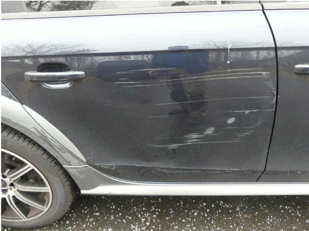
Bild: 69 Die Fondtür ist streifend in der Türaußenhaut deformeirt.
