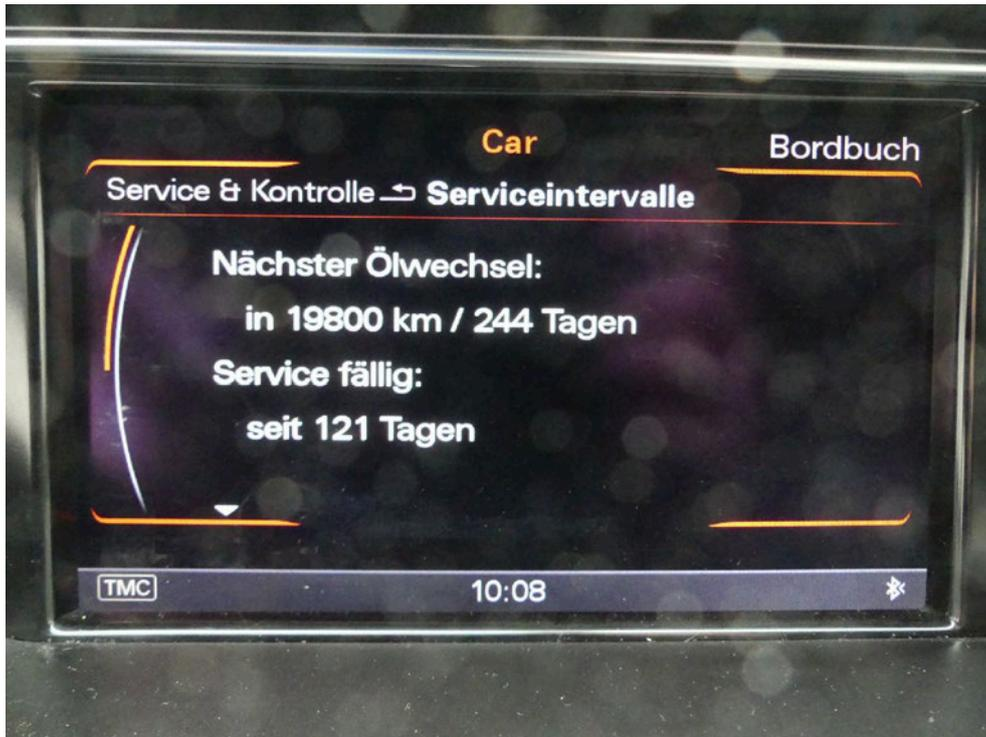
Bild: 19 Ausweisung Hinweis - Kombiinstrument - Service überfällig
