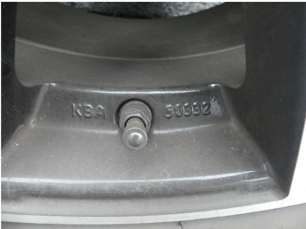
Bild: 54 Ausweisung KBA LM-Felgen Keskin / Typ KT 16
