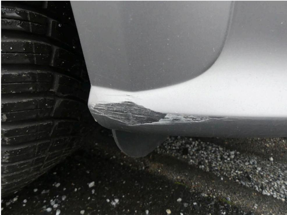
Bild: 61 .... weiterhin im unteren Segment im Material abgetragen.
