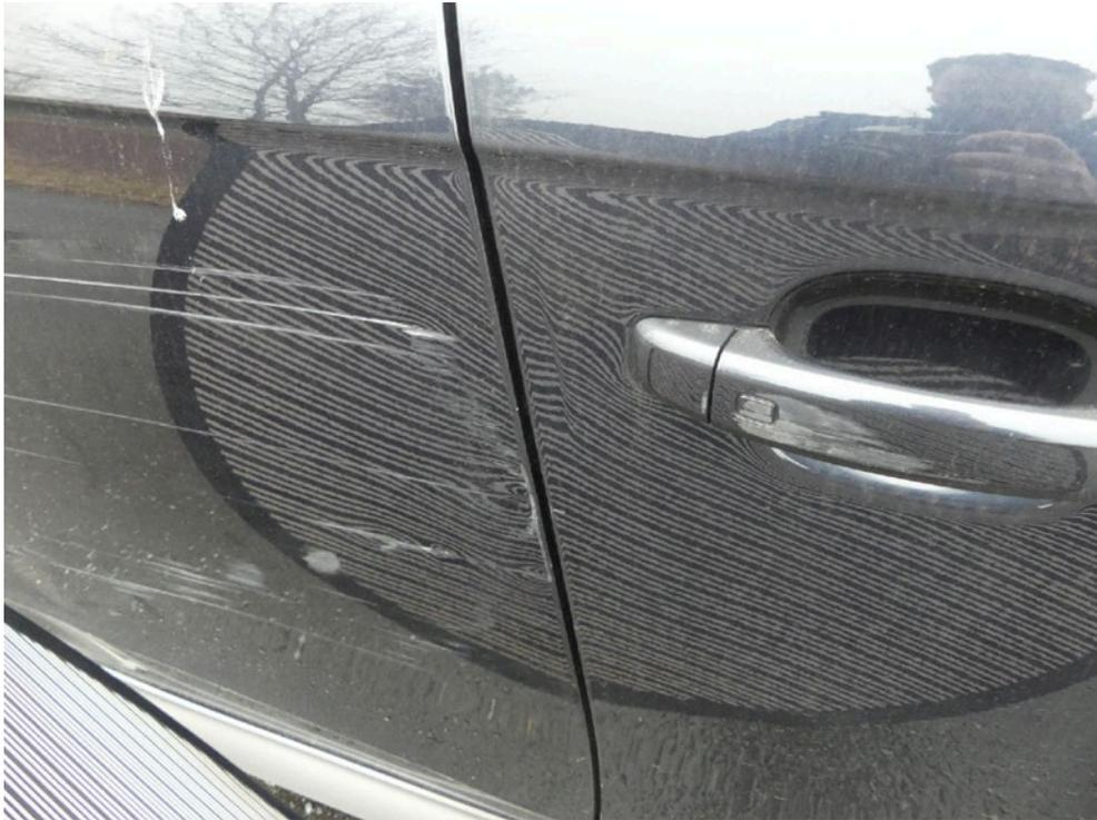
Bild: 67 Ausweisung Deformation Beifahrertür.
