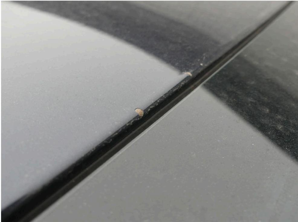
Bild: 93 Steinschläge Dachkante vorn
