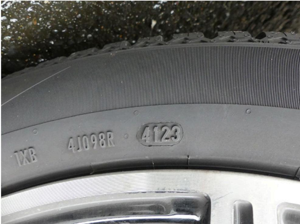
Bild: 53 Ausweisung der DOT Nummer der Radialreifen
