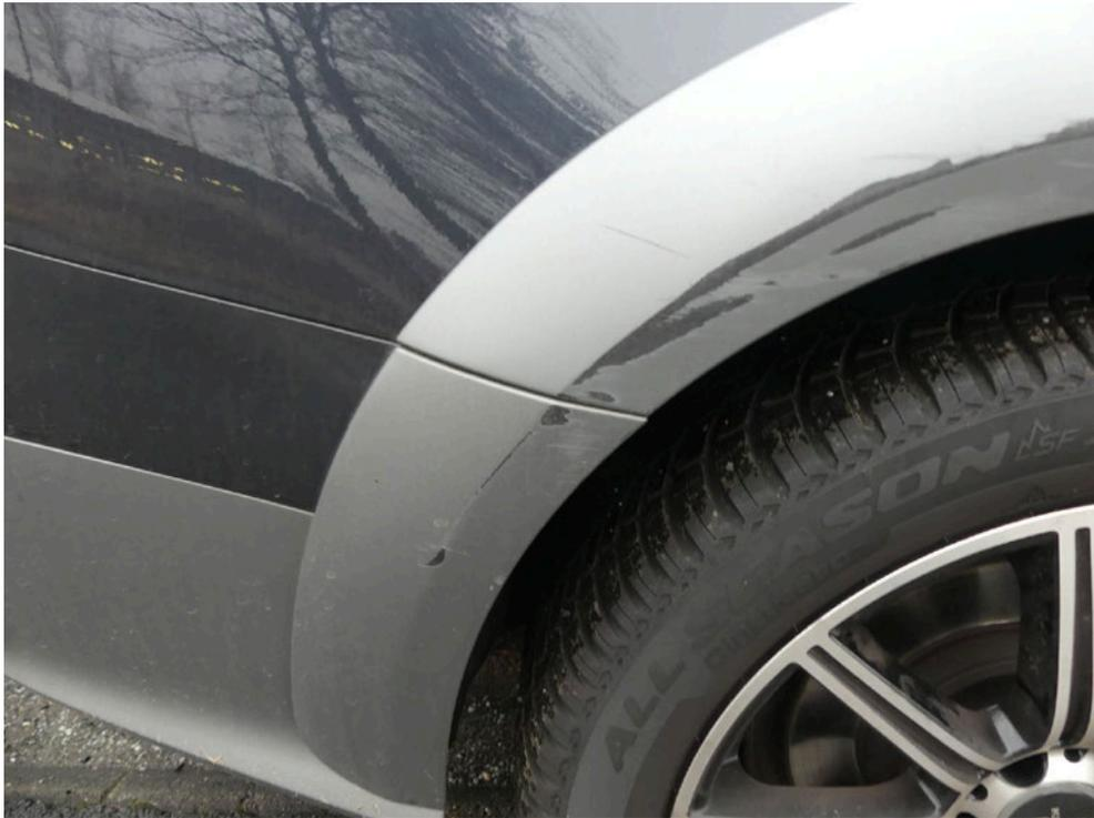
Bild: 75 Fortführend ist die Radlaufabdeckung rechts der Heckverkleidung materialbelastend markiert.
