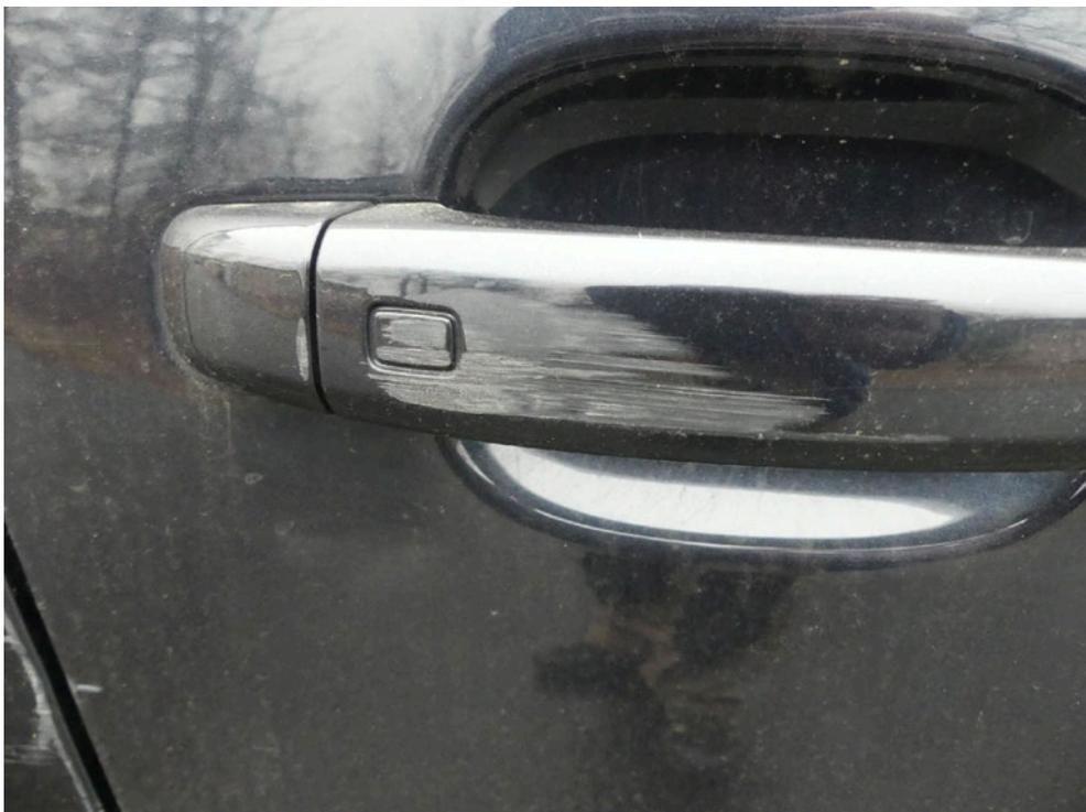
Bild: 64 .... dieser ist streifend beschädigt.
