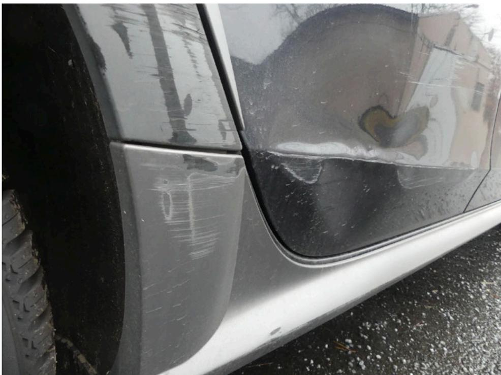
Bild: 76 Einzeldarstellung Abdeckung Einstiegsschweller rechts, diese ist ebenso im Grundmaterial abgetragen.
