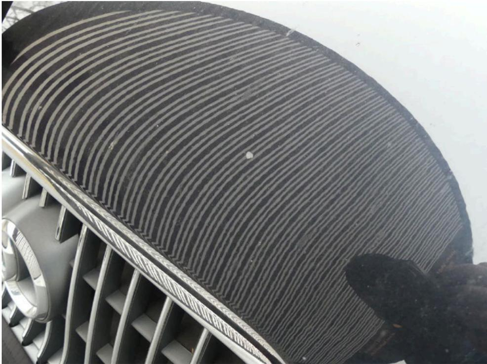
Bild: 91 Weiterführend sind sichtbar Steinschläge mit der dazugehörigen Abtragung des Lackaufbaues vorhanden.
