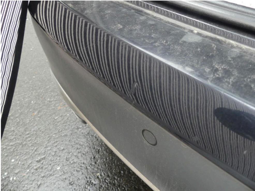
Bild: 77 Ansicht Heckverkleidung, diese ist partiell gestaucht.
