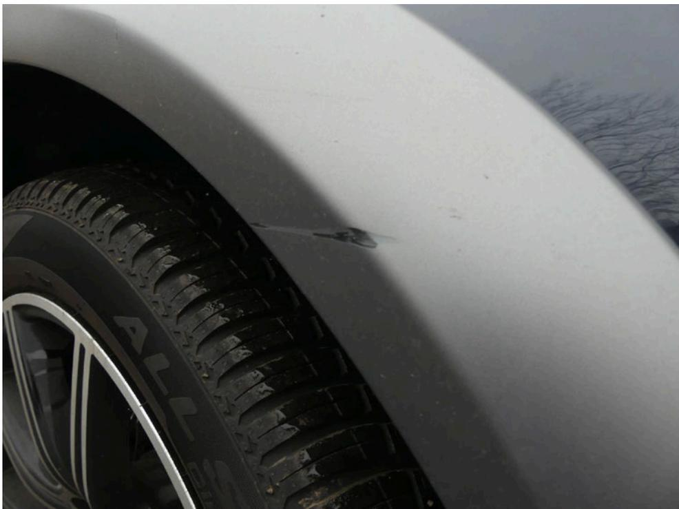
Bild: 62 Ansicht Radlaufabdeckung Kotflügel vorn rechts, diese ist streifend gestauch und partiell im Material abgetragen.
