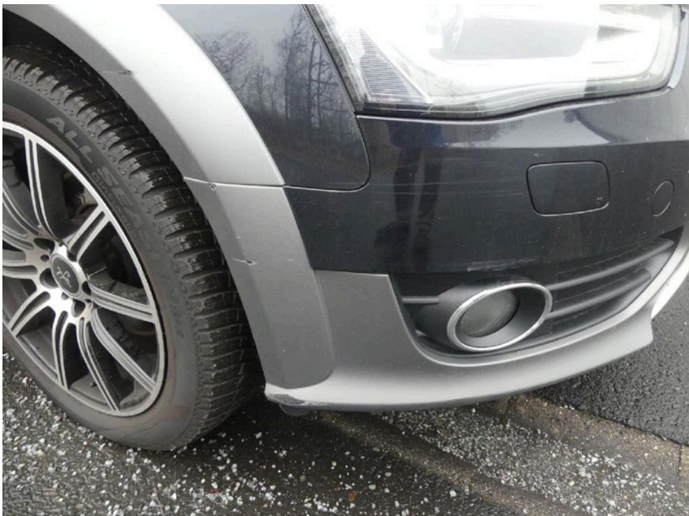
Bild: 60 Ansicht Frontverkleidung, diese ist streifend im Lackaufbau markiert und ...
