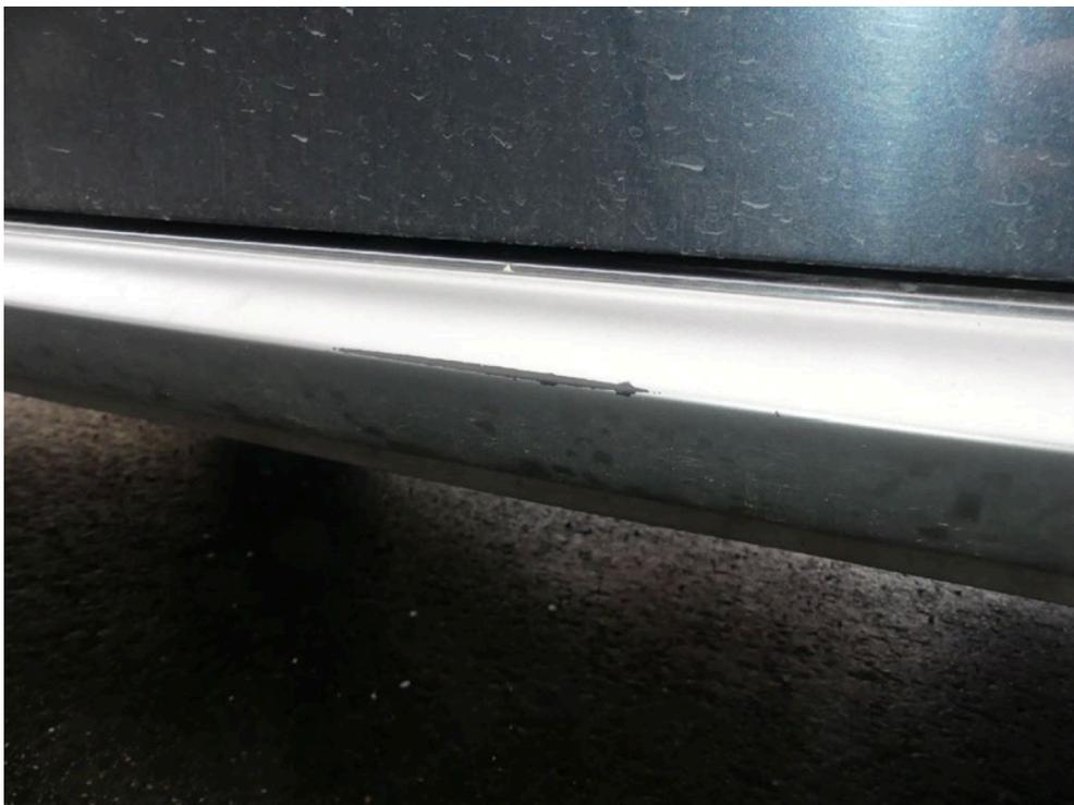
Bild: 86 ... dieser ist partiell in der Farbgebung abgetragen.
