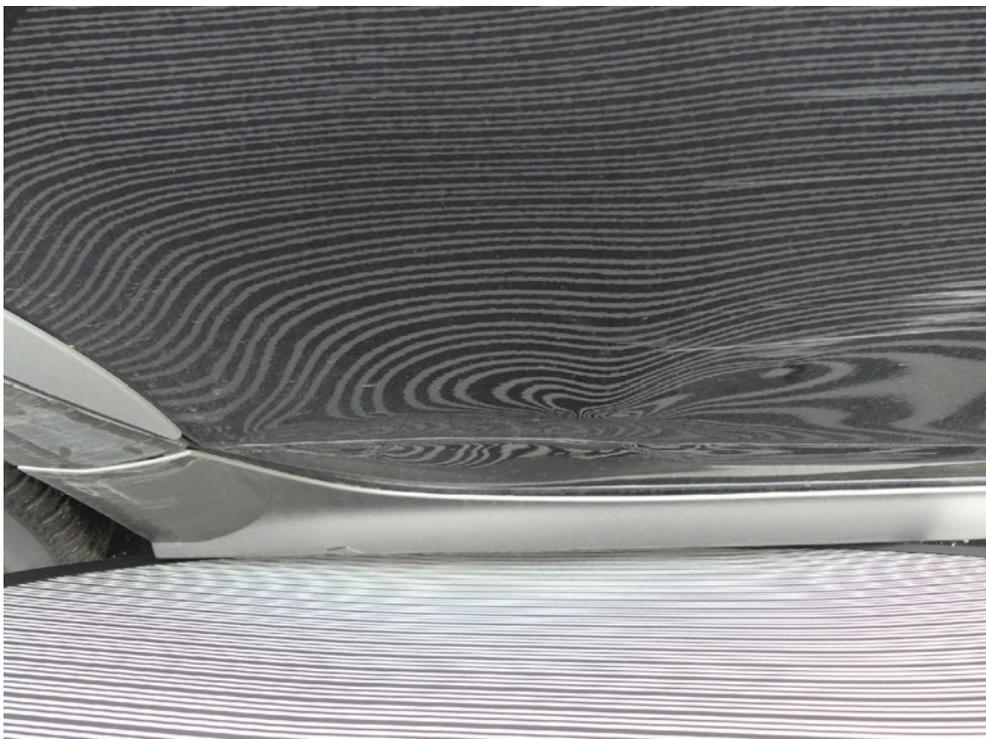
Bild: 70 Detaillierte Darstellung zur visuellen Verdeutlichung des Materialeinzuges mittels Liniensegels.
