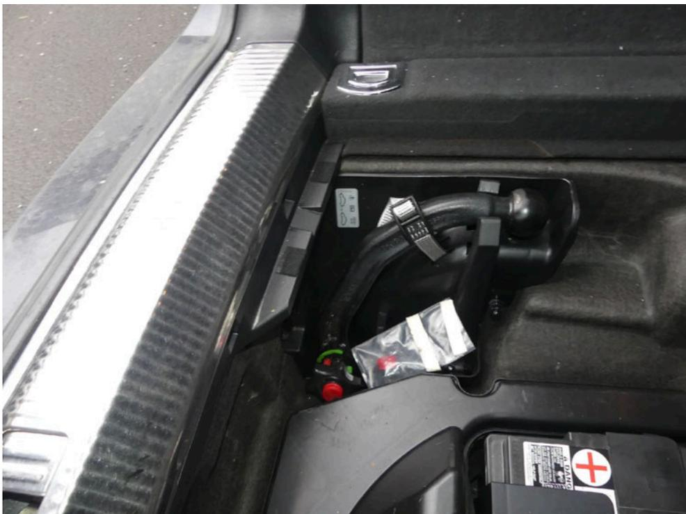
Bild: 32 .... mit abnehmbarer Anhängerkupplung.
