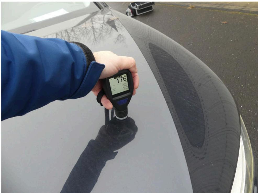
Bild: 94 Ausweisung Lackschichtdickenmessung vorgenommen, Messwerte dem beiliegenden Protokoll entnehmen.
