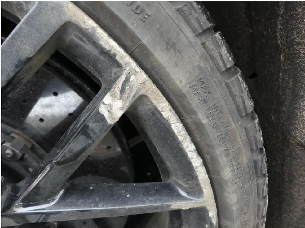
Bild: 17 ... die Leichtmetallfelge ist sichtbar im Grundmaterial abgetragen.
