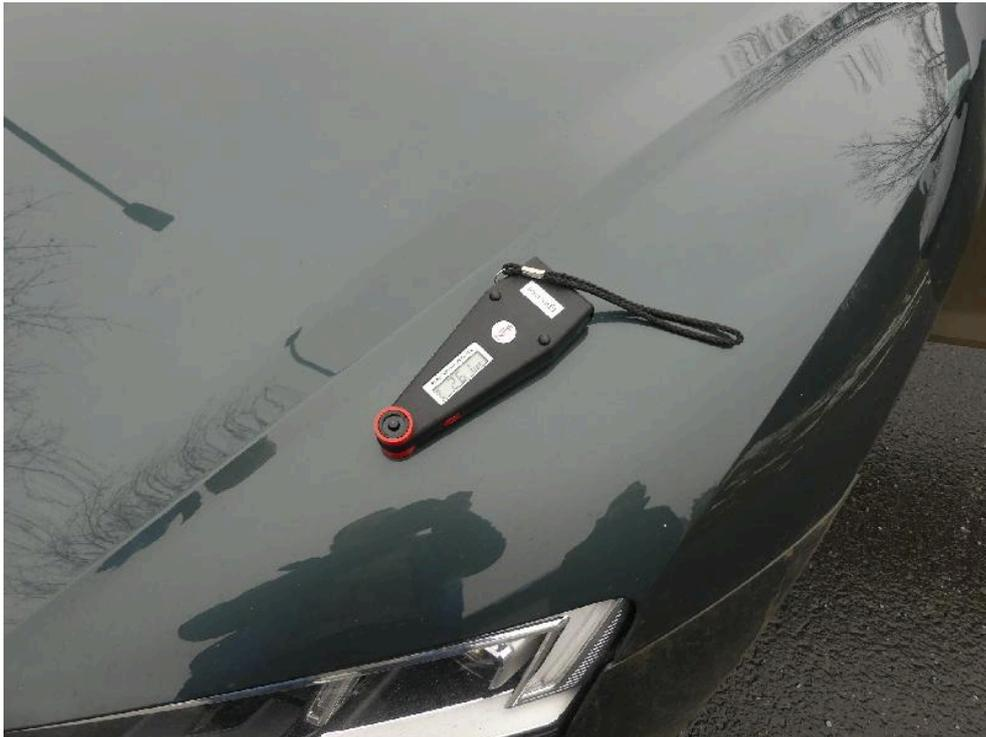
Bild: 65 Messung Lackschichtdicke Klappe vorn links ...
