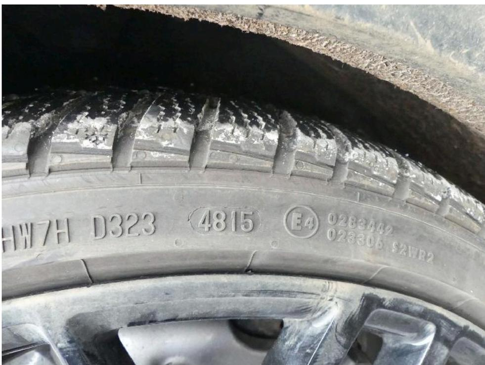
Bild: 14 Ausweisung DOT Nummer der Radialreifen.
