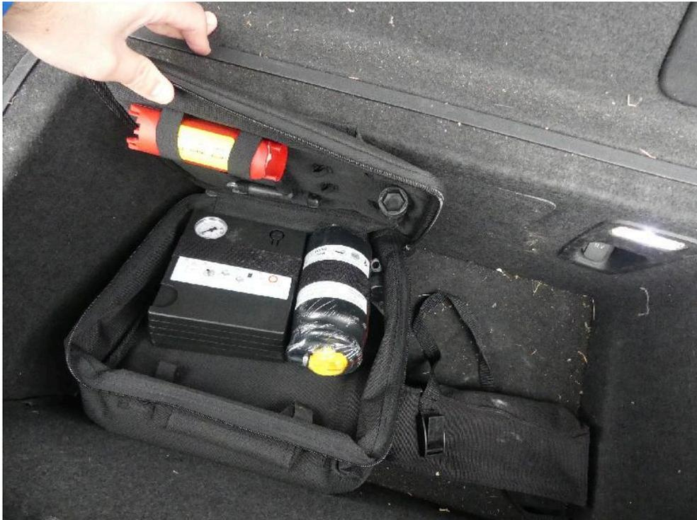
Bild: 51 Reifenfüll-KIT
