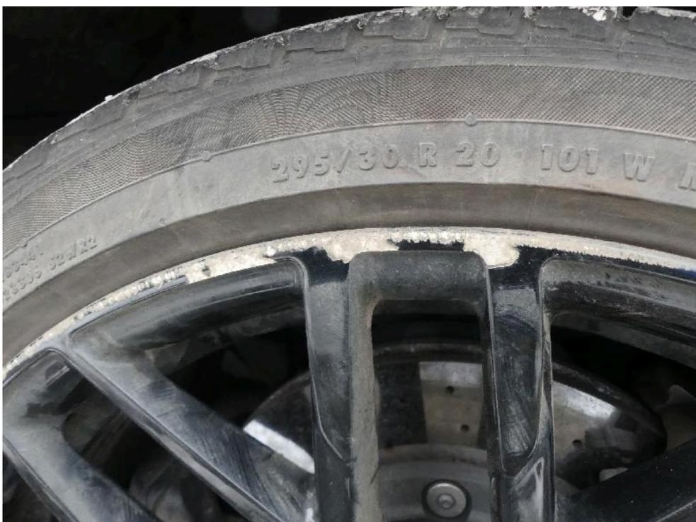
Bild: 22 ... hierbei ist ebenso das Grundmaterial der Leichtmetallfelge abgetragen.
