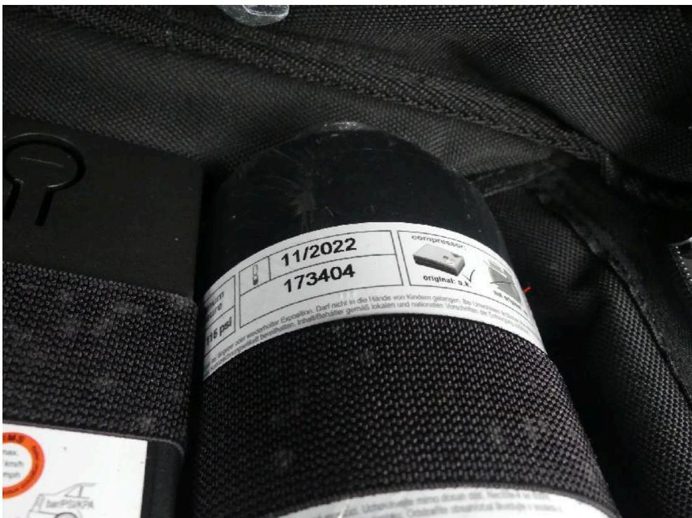
Bild: 52 Reifenfüllmittel abgelaufen
