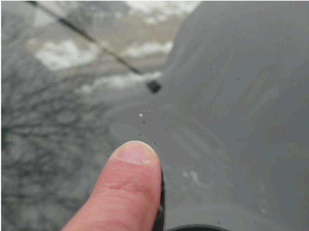
Bild: 57 ... Steinschlag im Sichtbereich
