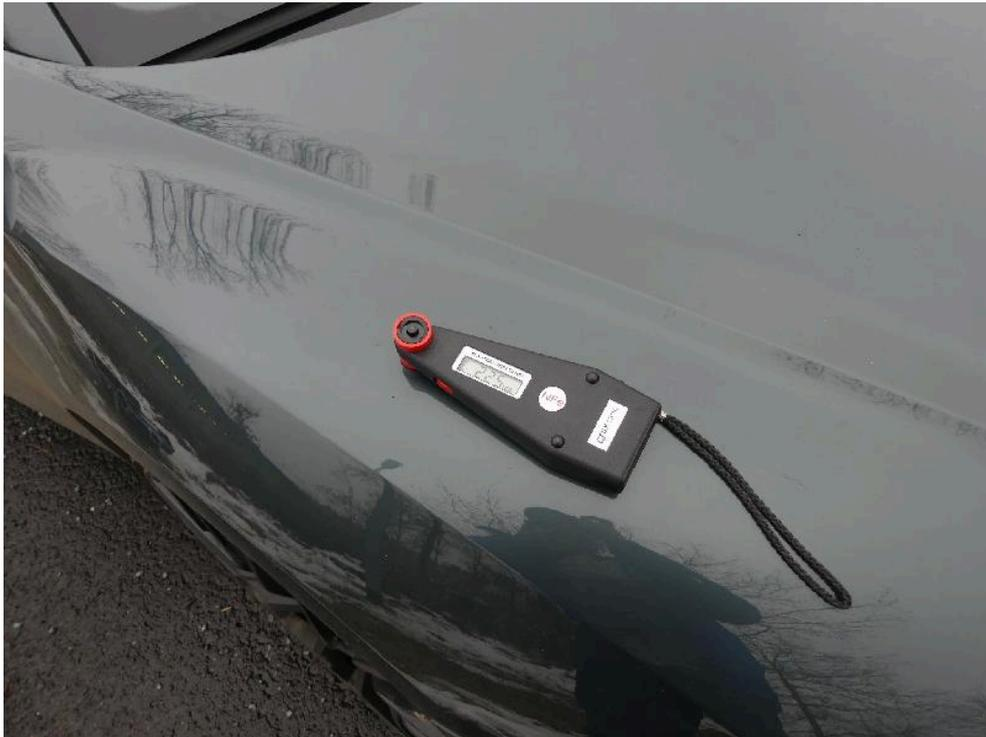
Bild: 63 Lackschichtdickenmessung Klappe vorn ....
