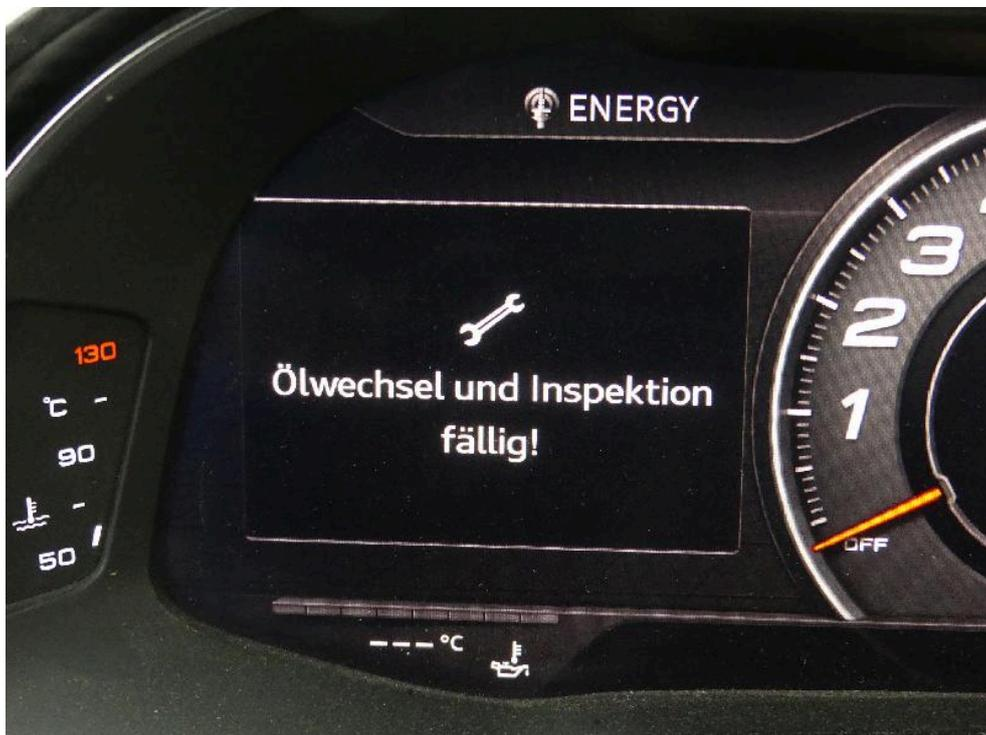
Bild: 48 Ansicht Hinweis Kombiinstrument
