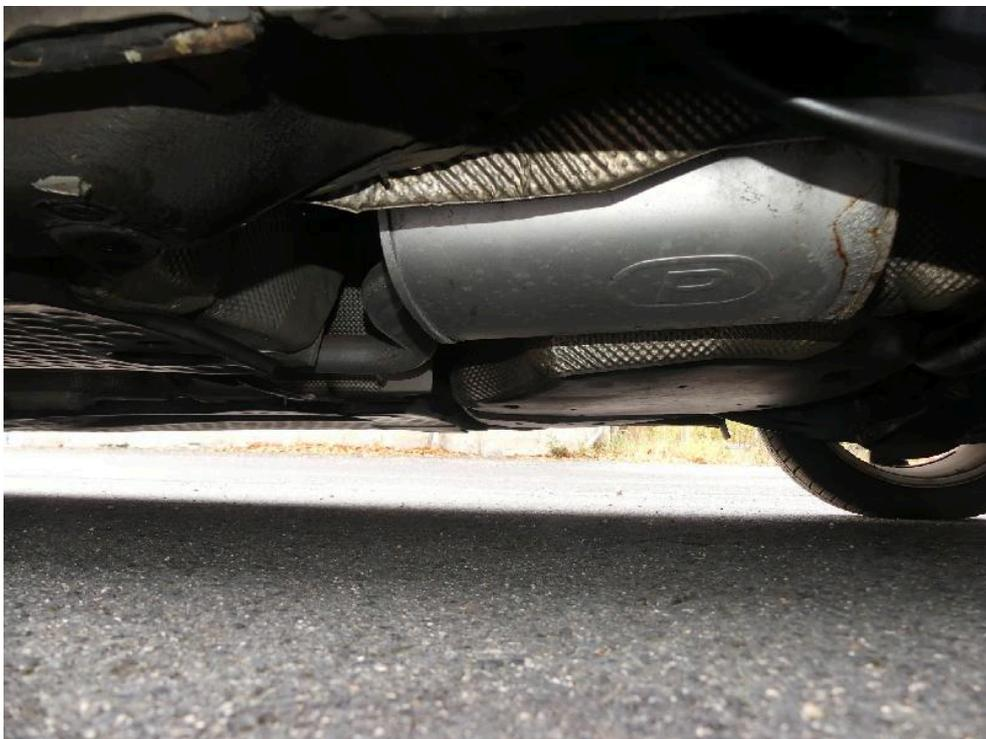
Bild: 81 Ansicht Mittelschalldämpfer, dieser ist augenscheinlich neuwertig.
