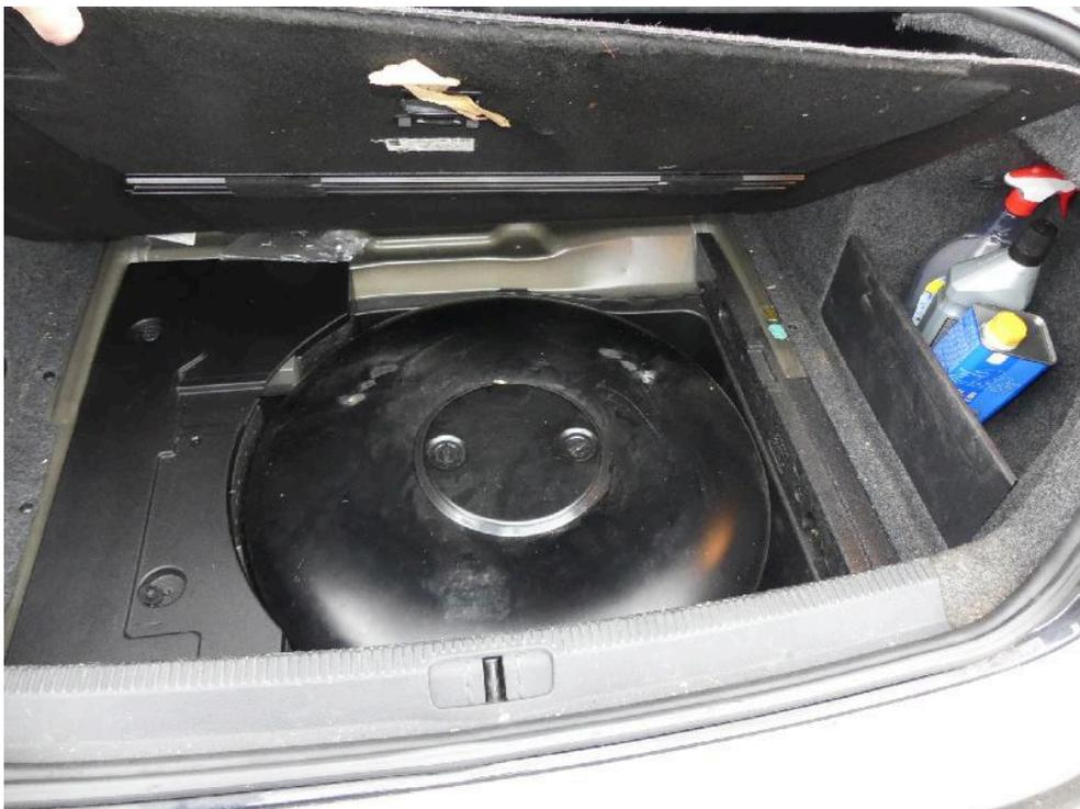
Bild: 41 Ausweisung Flüssiggastank in der Ersatzradmulde.
