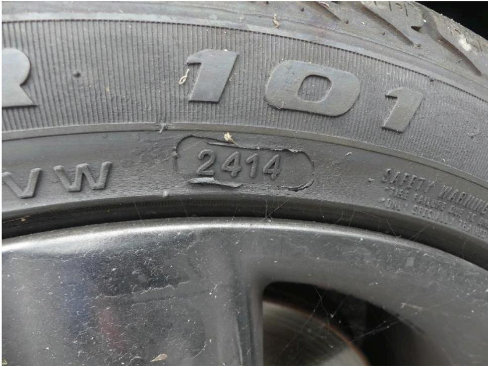
Bild: 11 Ausweisung der DOT Nummer der Radialreifen
