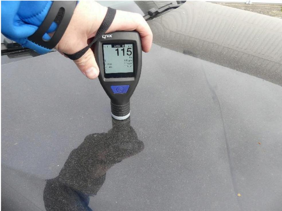
Bild: 82 Ausweisung Lackschichtdickenmessung vorgenommen, Messwerte dem beiliegenden Protokoll entnehmen.
