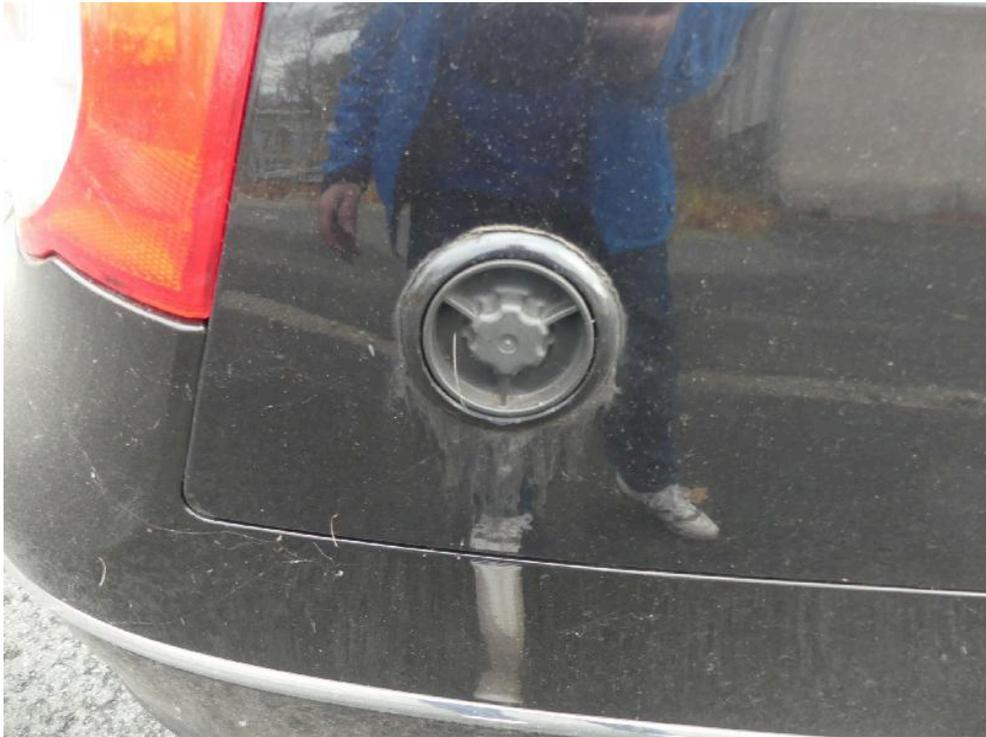
Bild: 42 Ausweisung Tankverschluss BRC-Flüssiggasanlage Seitenwand rechts
