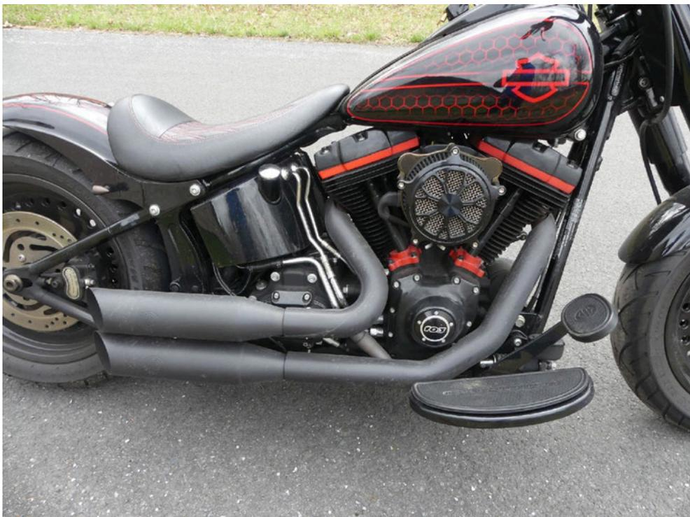
Bild: 20 Ansicht Abgasanlage mit Klappensteuerung
