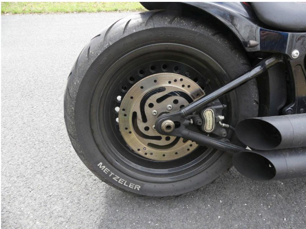
Bild: 22 Ansicht Rad/Reifenkombination hinten
