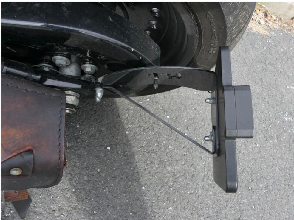
Bild: 26 Ansicht seitlicher Kennzeichenhalter
