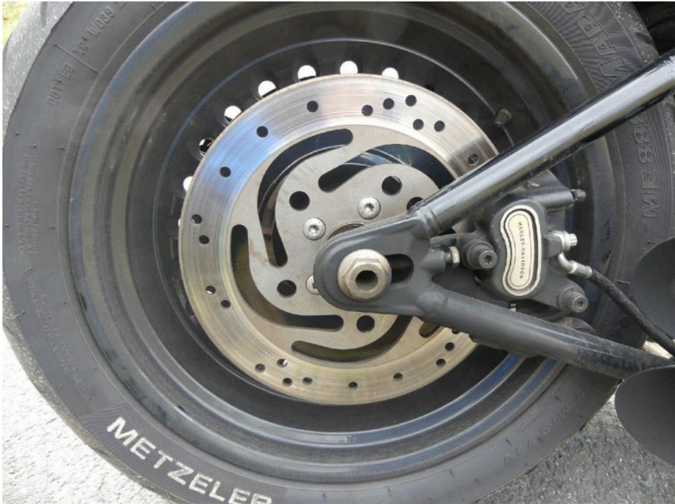
Bild: 23 Ausweisung Bremsanlage Hinterachse
