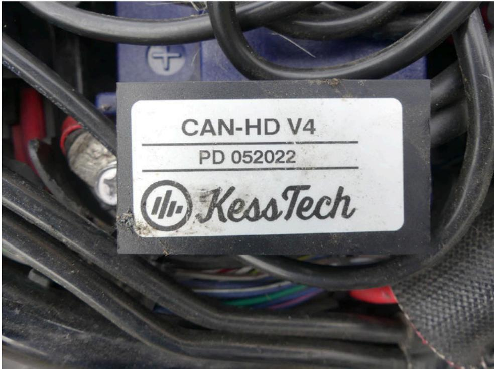
Bild: 21 Ausweisung Modul Klappensteuerung Abgasanlage
