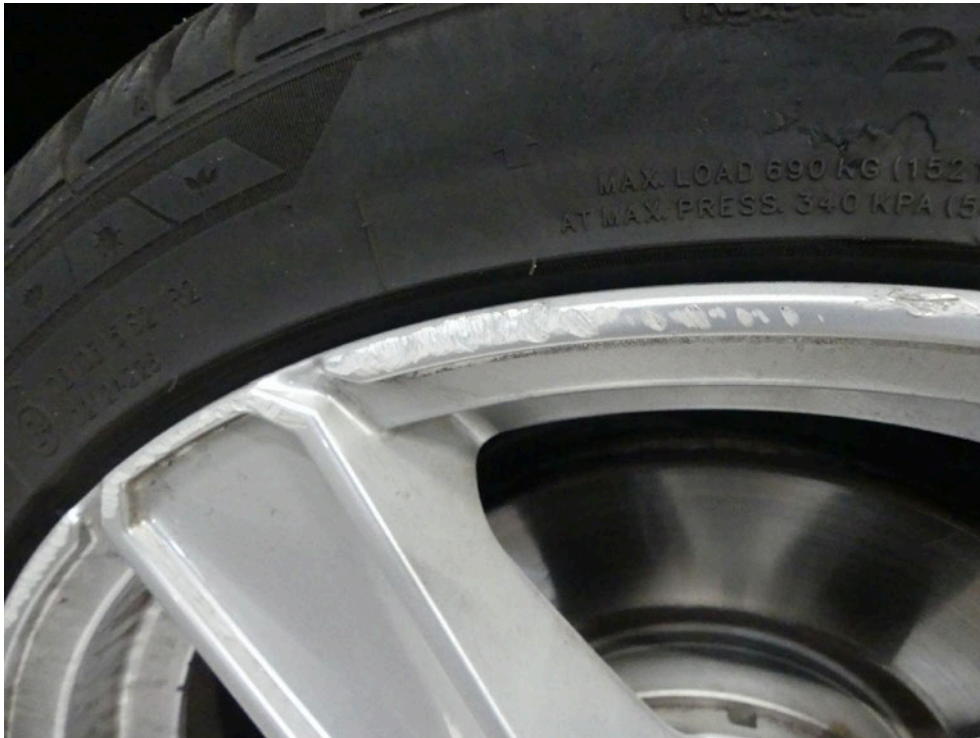
Bild: 29 Detaillierte Darstellung, LM-Felge partiell im Grundmaterial abgetragen.
