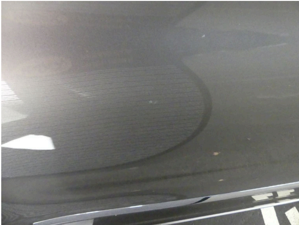
Bild: 65 ... punktuelle Eindellung in der Türaußenhaut.
