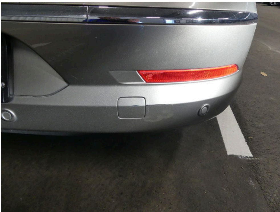
Bild: 68 Ansicht Heckverkleidung ist streifend im Lackaufbau markiert.
