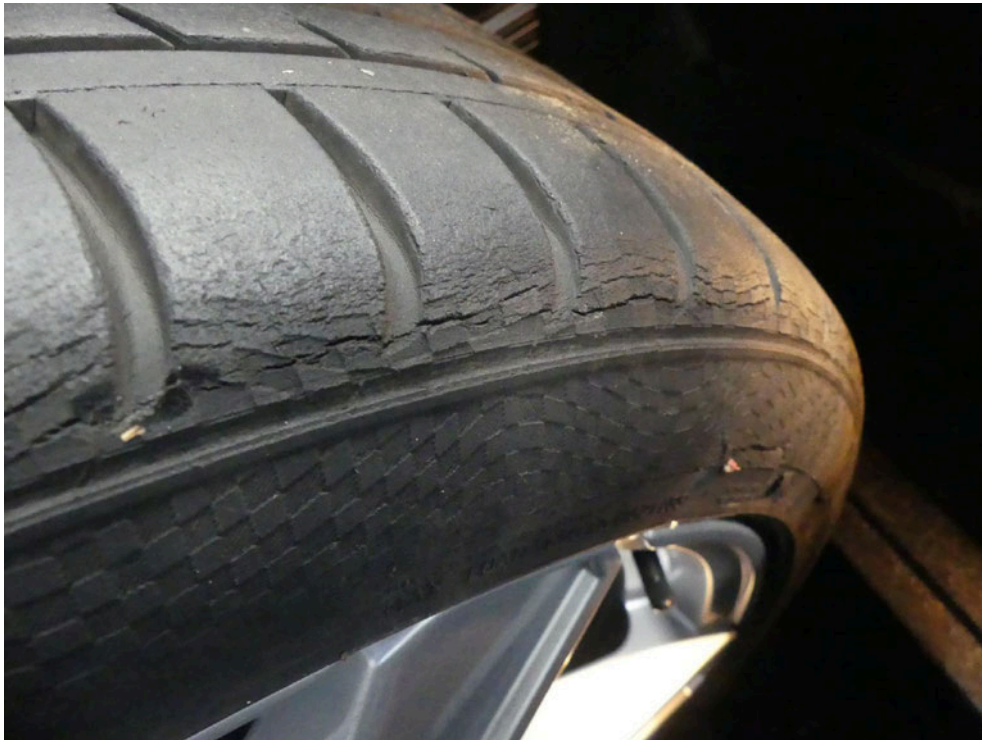
Bild: 45 Ausweitung Radialriefen Ersatzrad
