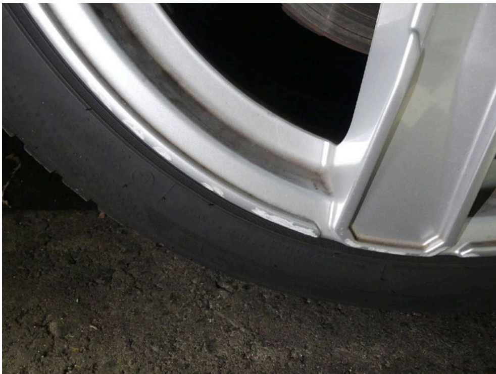
Bild: 22 LM-Felge partiell abgetragen.
