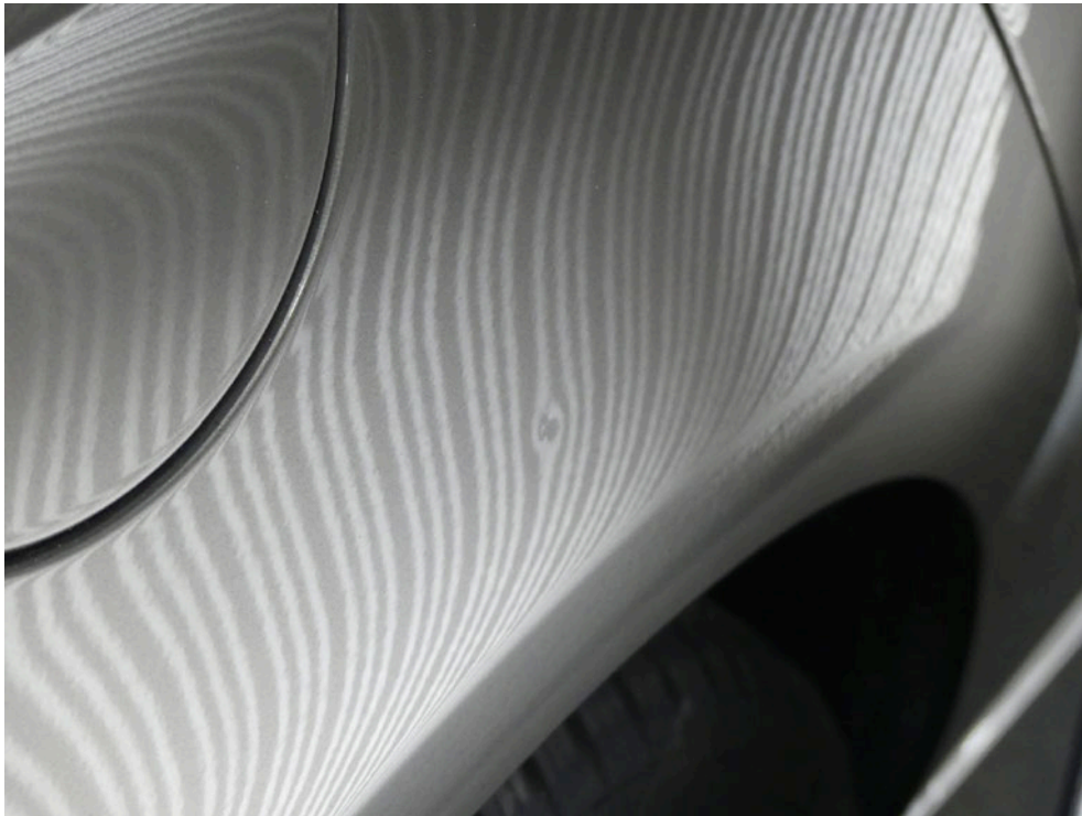
Bild: 67 ... punktuelle Eindellung im Bereich Tankeinfüllstutzen.
