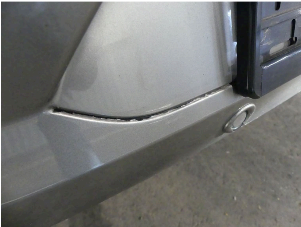
Bild: 75 Heckverkleidung nachlackiert, partiell Lackablösung vorhanden.
