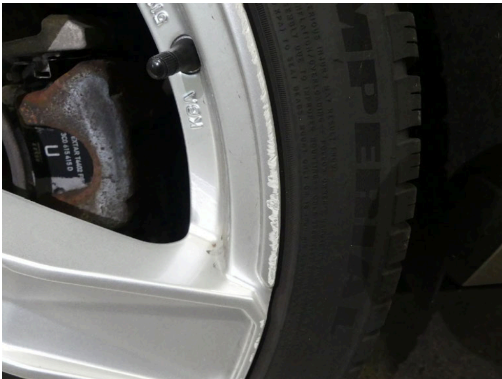
Bild: 26 Weitere Beschädigungen an der LM-Felge vorhanden.
