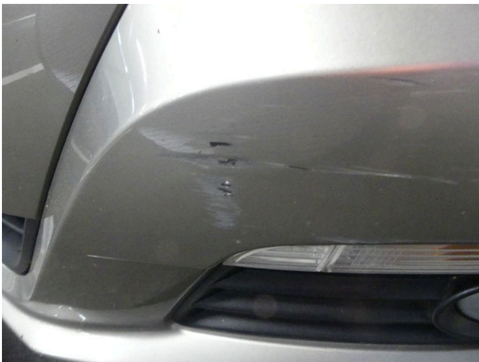
Bild: 58 ... diese ist streifend im Lackaufbau markiert.
