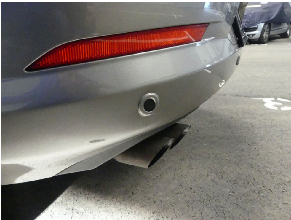
Bild: 70 PDC-Sensoren hinten - nicht lackiert
