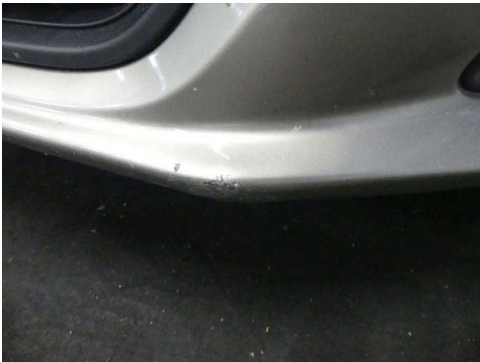
Bild: 60 Weiterführend ist die Frontverkleidung im unteren Segment beschädigt ...
