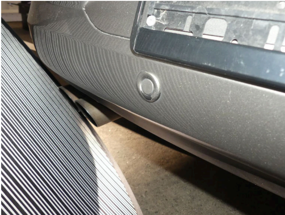
Bild: 69 Lackablösung PDC-Sensor Heckverkleidung mitte links.
