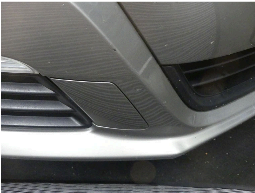
Bild: 62 Ansicht Frontverkleidung rechts, diese ist punktuell deformiert und sichtbar im Lackaufbau abgetragen.
