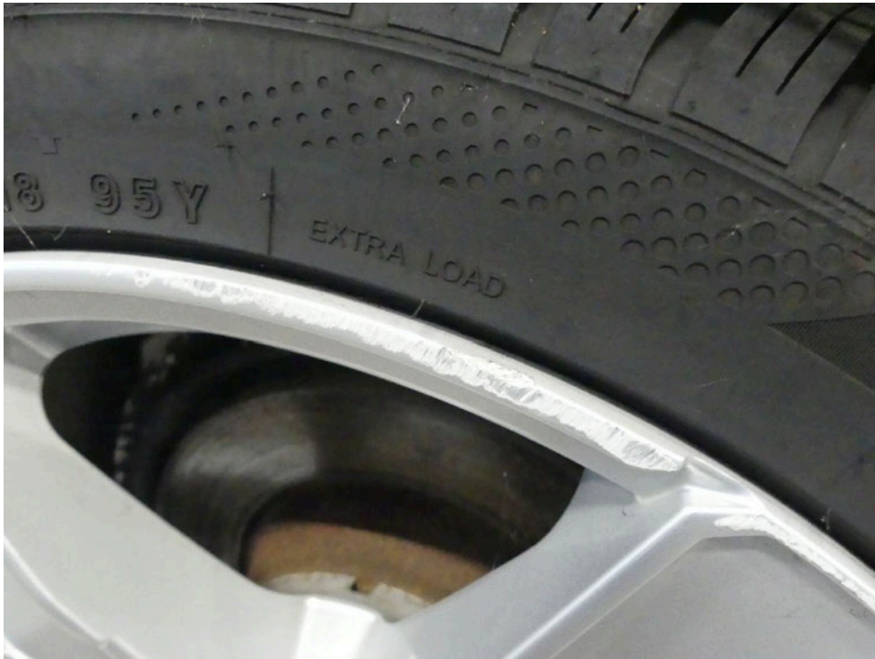
Bild: 25 Detailansicht, LM-Felge im Grundmaterial abgetragen.
