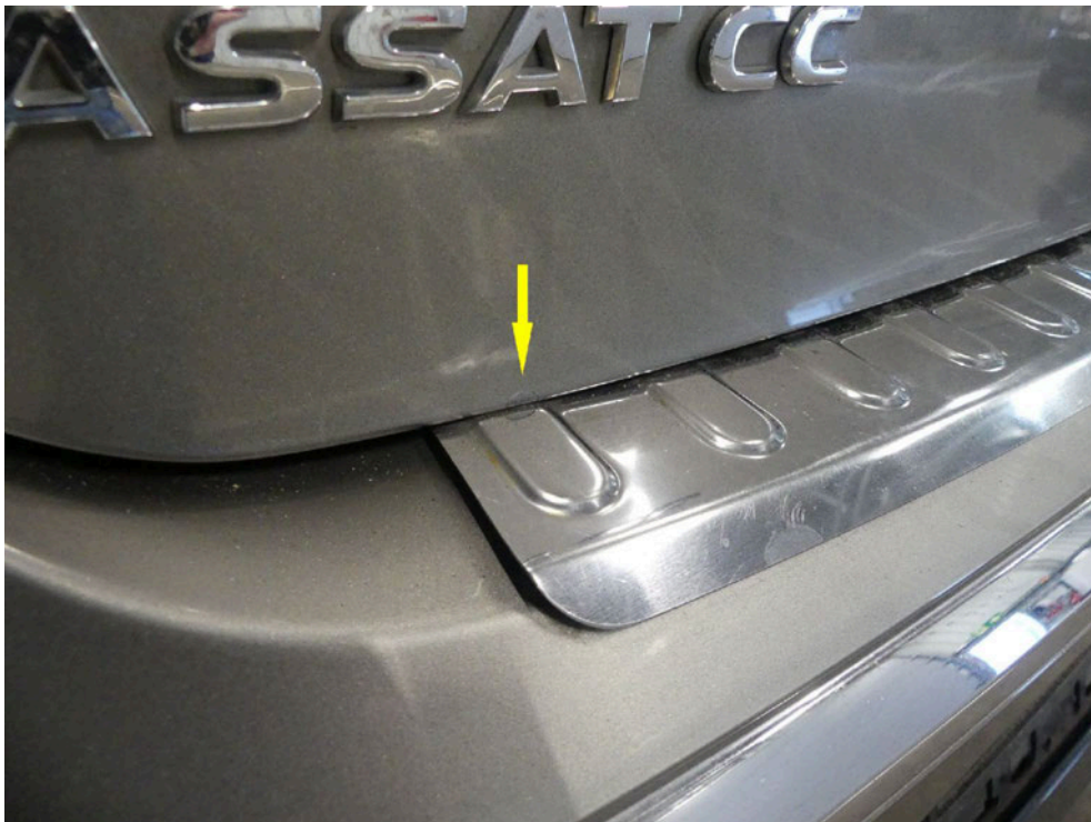
Bild: 73 ... linksseitig ist dieser aufgestellt und lehnt bleibend an der Heckklappe an.
