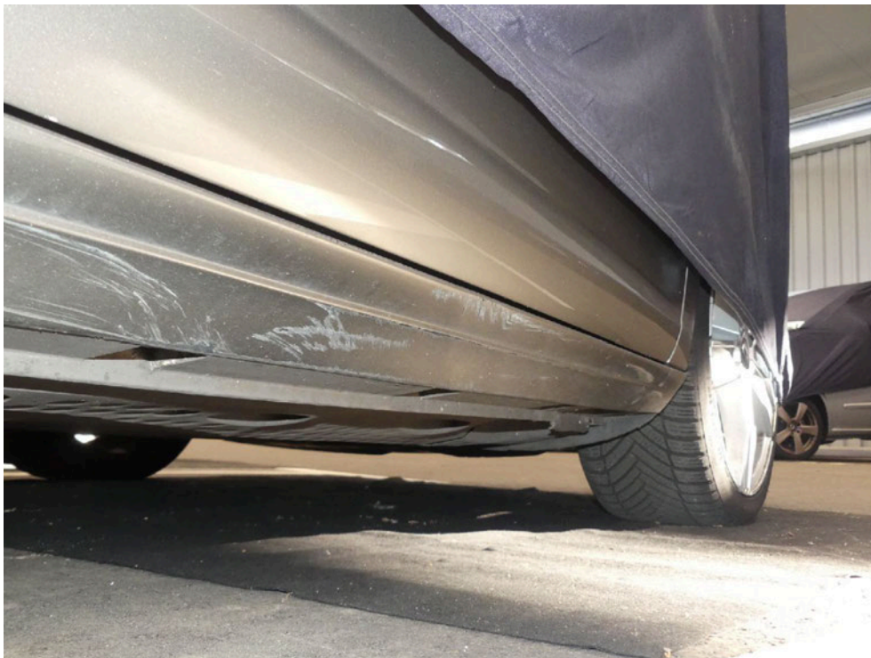
Bild: 55 Schwellerabdeckung rechts streifend beschädigt.
