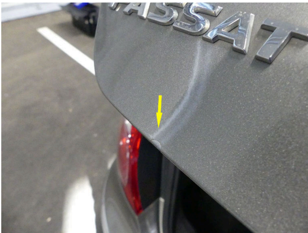
Bild: 74 Einzeldarstellung Heckklappe, diese ist partiell im Lackaufbau abgetragen.
