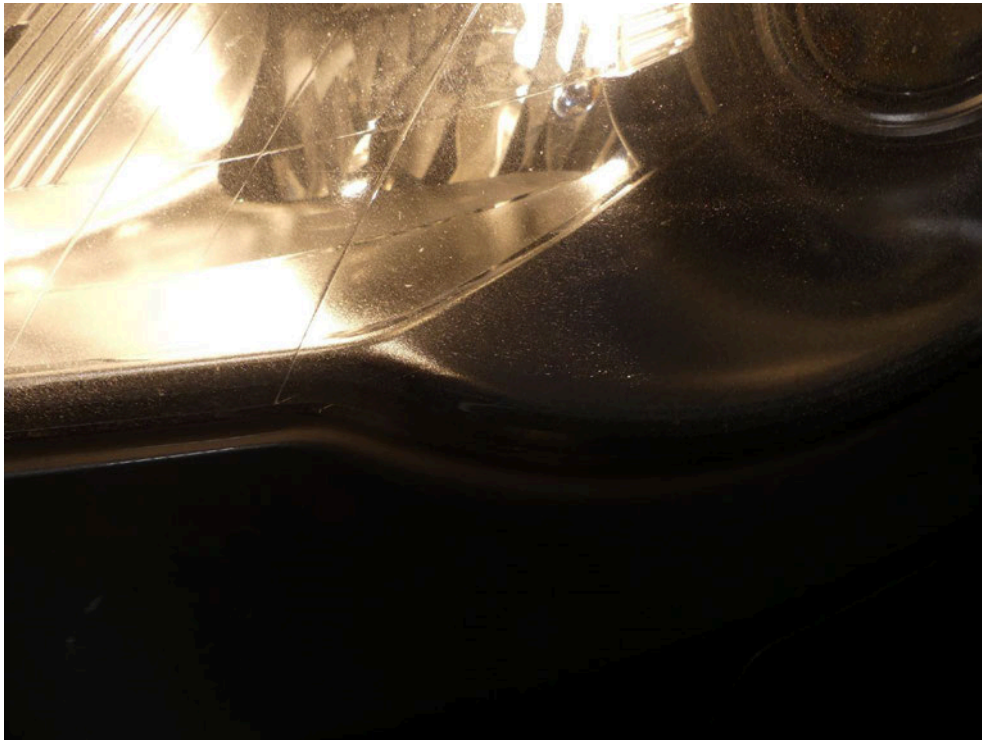
Bild: 59 Scheinwerfer partiell durch Steinschläge blind.
