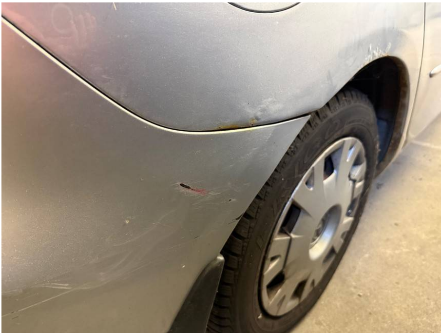
Heckverkleidung beschädigt, Korrosion Seitenwand
