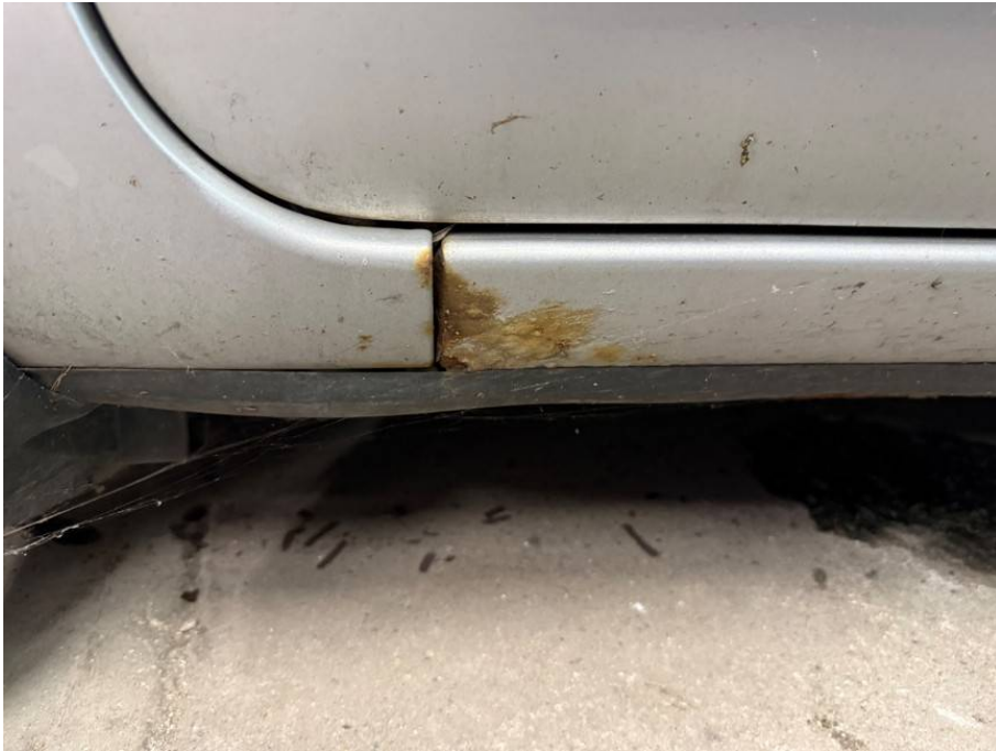
Korrosion Schweller links
