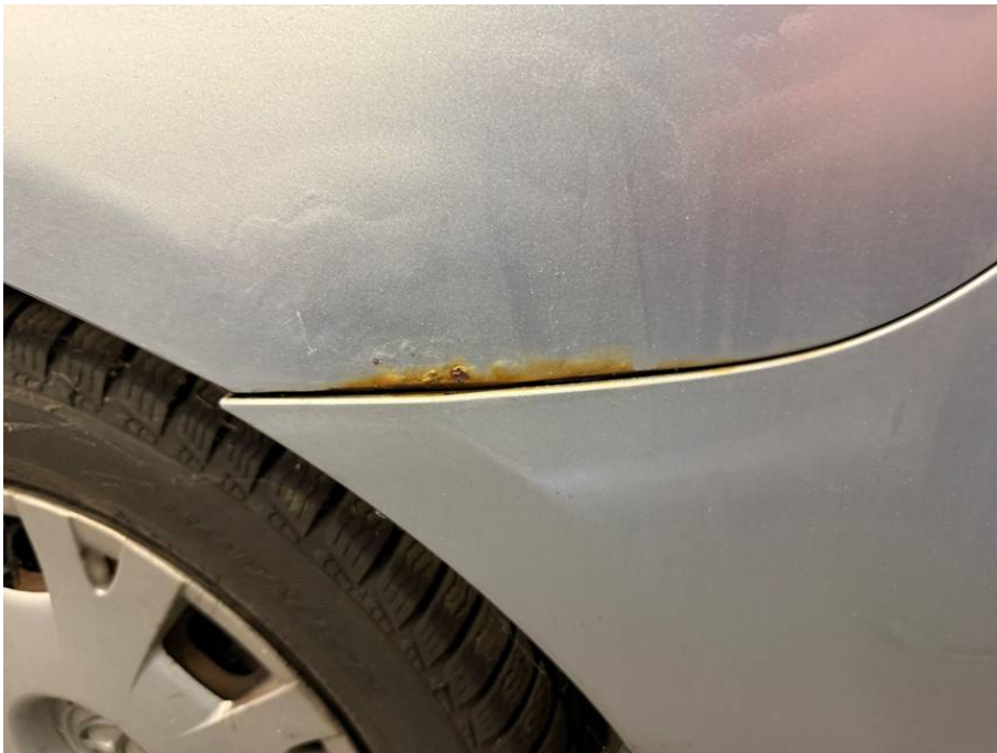
Korrosion Seitenwand links
