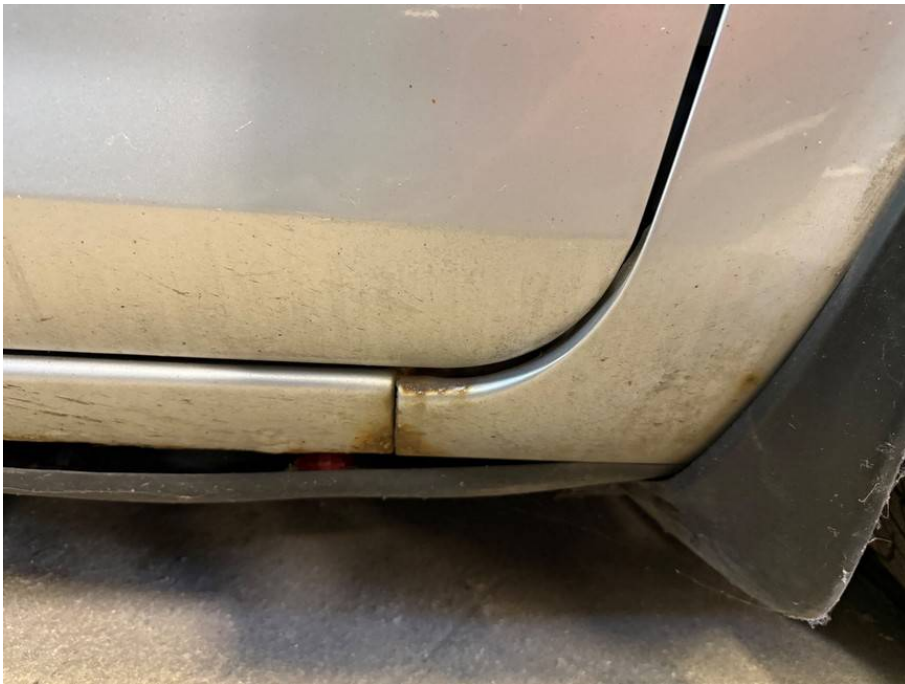
Korrosion rechter Kotflügel und Schweller
