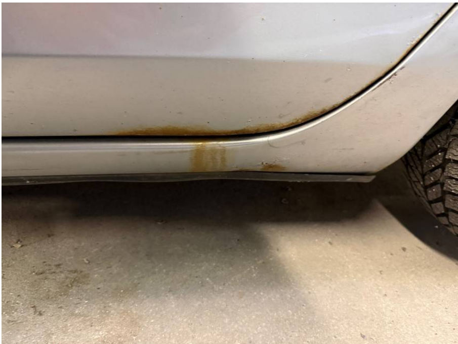
Korrosion Schweller und Tür h.l.
