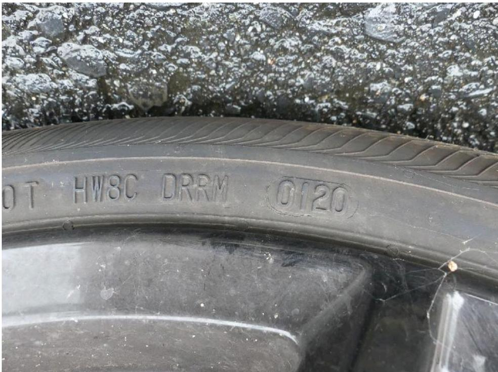
Bild: 36 Ausweisung der DOT Nummer der Radialreifen
