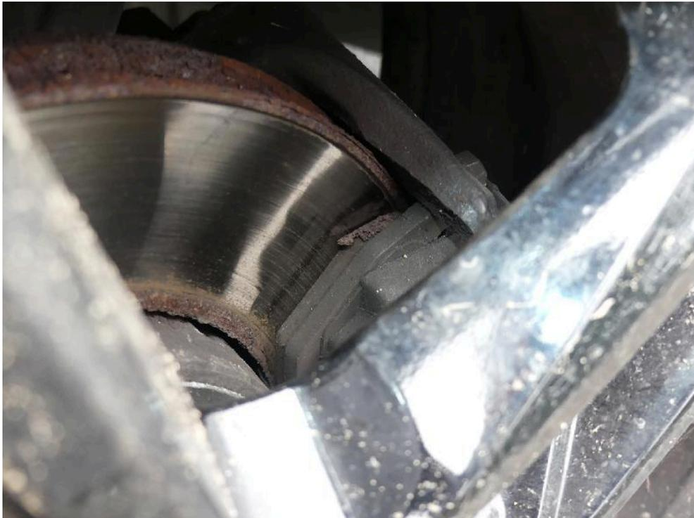
Bild: 48 Detailansicht Bremsanlage Vorderachse
