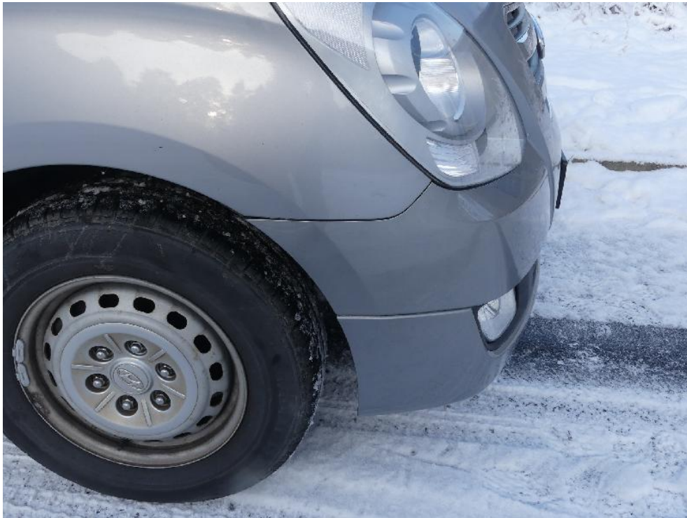
Bild: 67 Aufgrund des Farbunterschiedes der Frontverkleidung ist eine Nachlackierung erfolgt.
