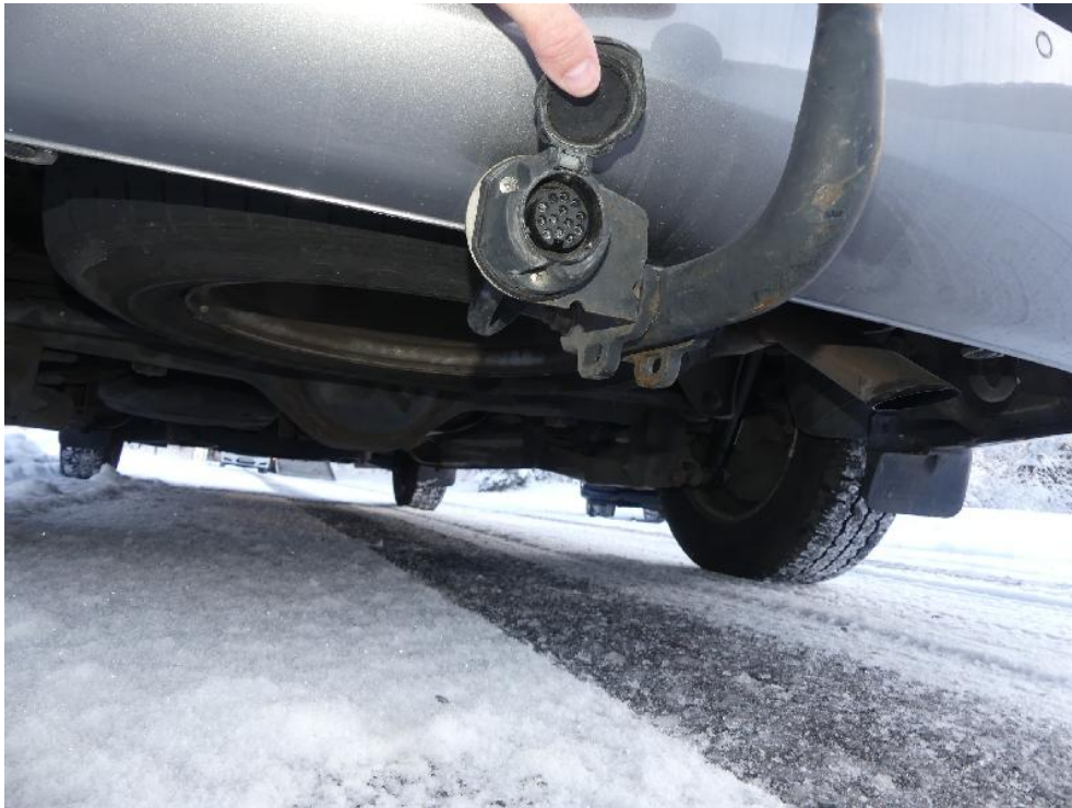
Bild: 25 Anhängerzugvorrichtung mit Elektrodose 13-Polig
