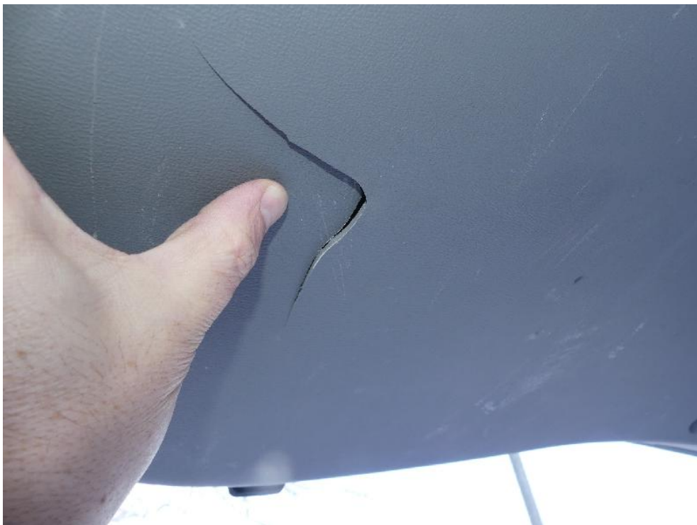
Bild: 24 Detailansicht Heckklappe, die Innenverkleidung ist im Material gebrochen
