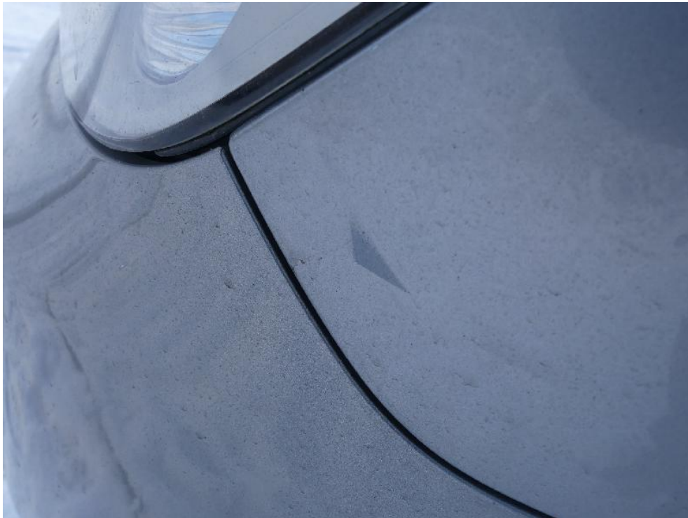
Bild: 71 Farbrückstand am Kotflügel links, durch die Nachlackierung der Frontverkleidung.
