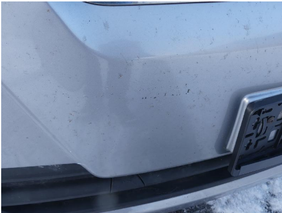
Bild: 68 Ausweisung Schaden Frontverkleidung
