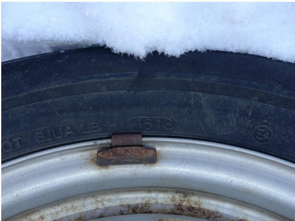
Bild: 10 Ausweisung der DOT Nummer der Radialreifen
