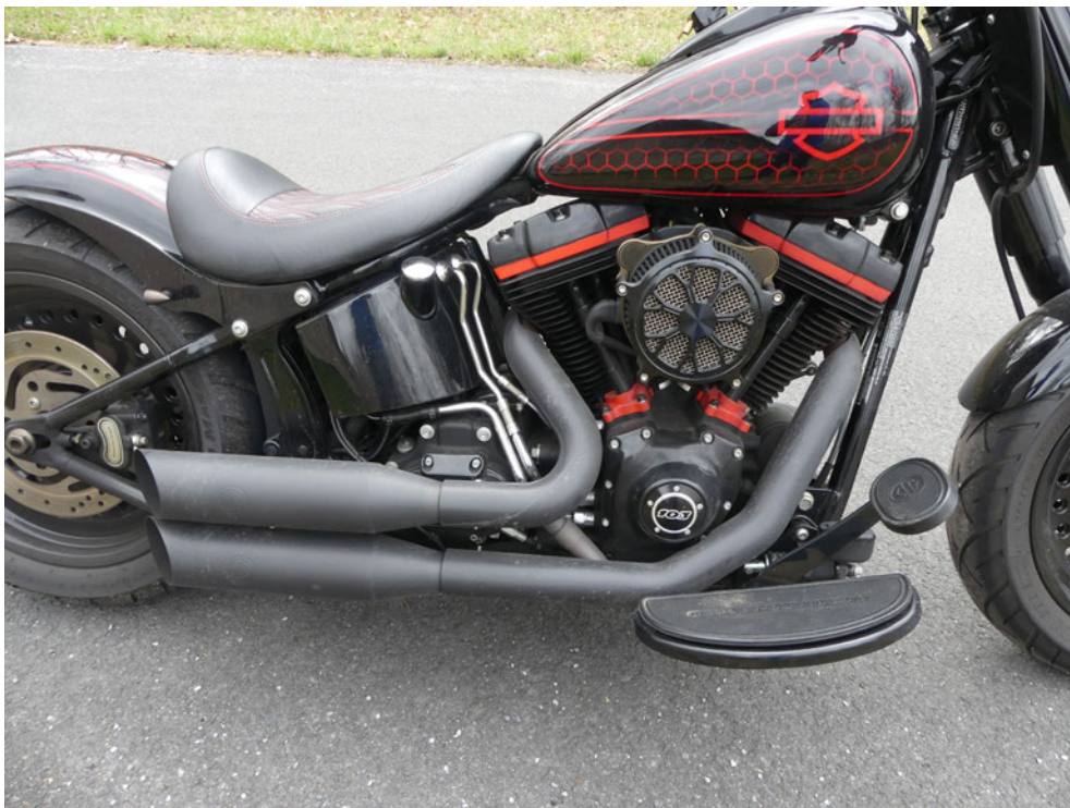
Bild: 20 Ansicht Abgasanlage mit Klappensteuerung
