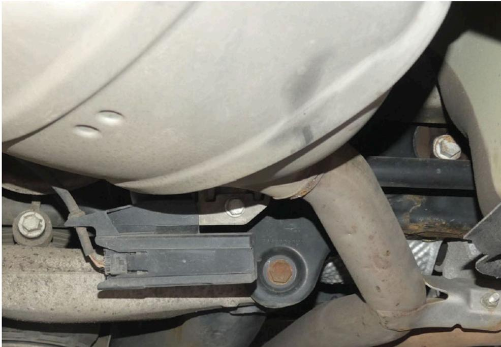
Bild: 53 Detailansicht Endschalldämpfer, dieser ist partiell deformiert.
