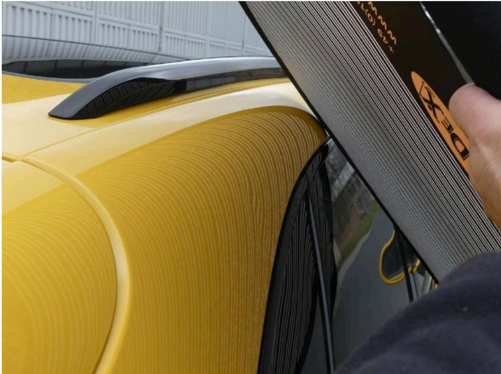
Bild: 73 Dachhol rechts hinten punktuell gestaucht.
