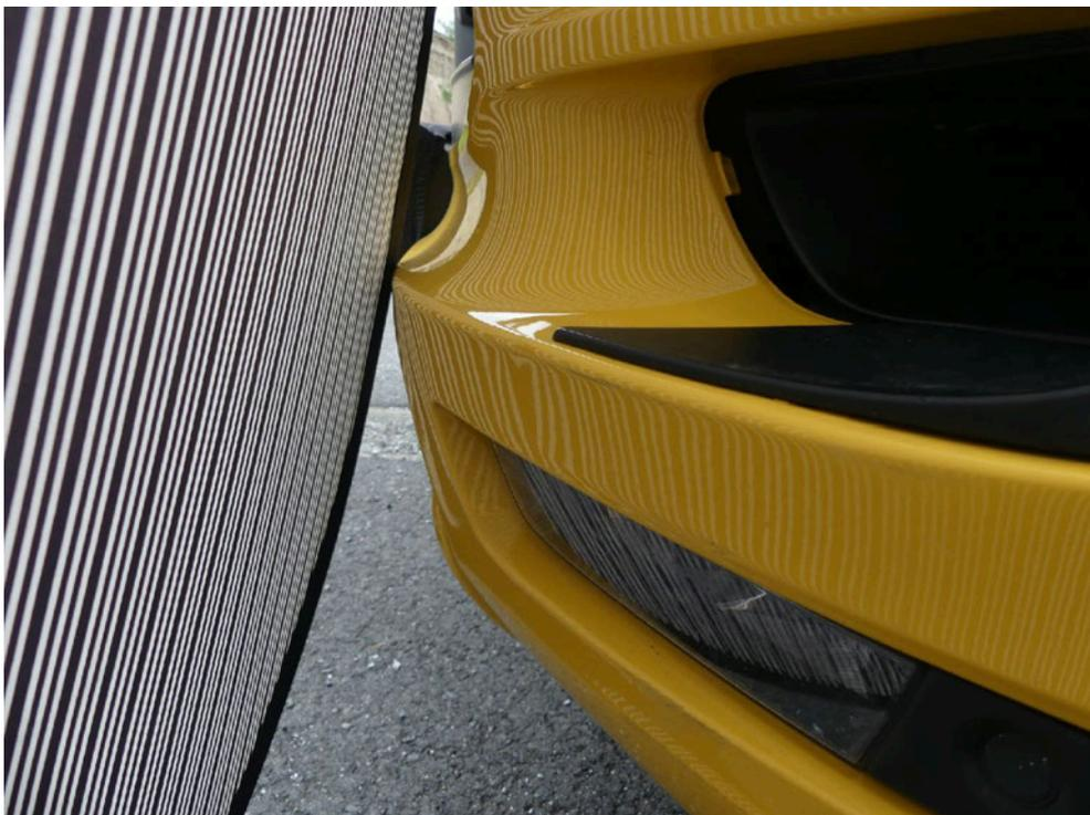
Bild: 72 Ausweisung weitere Materialdeformation der Frontverkleidung.
