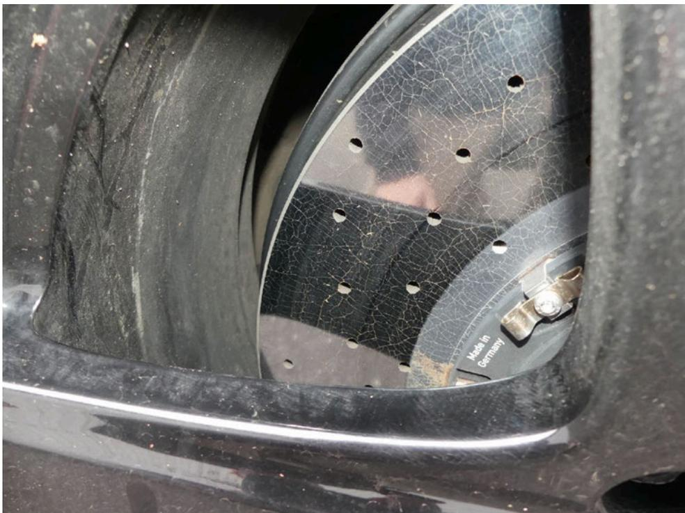
Bild: 46 PCCB - Porsche Ceramic Composite Brake (Keramikbremsanlage)
