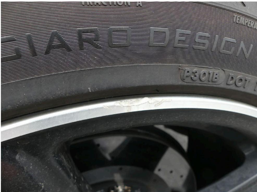
Bild: 48 LM-Felge hinten links beschädigt.
