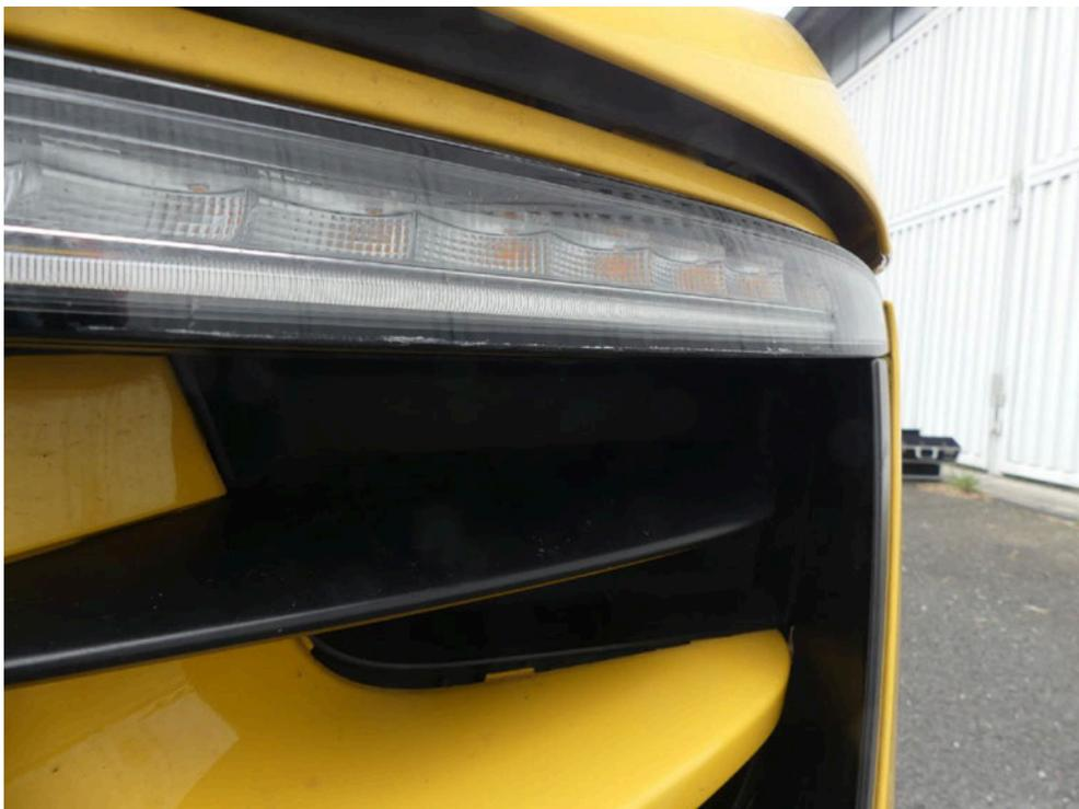
Bild: 70 Die Zusatzleuchte ist partiell abgetragen.
