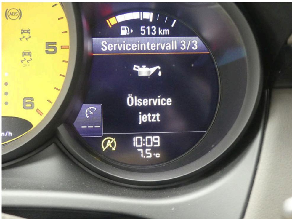
Bild: 20 Ausweisung Hinweis - Kombiinstrument
