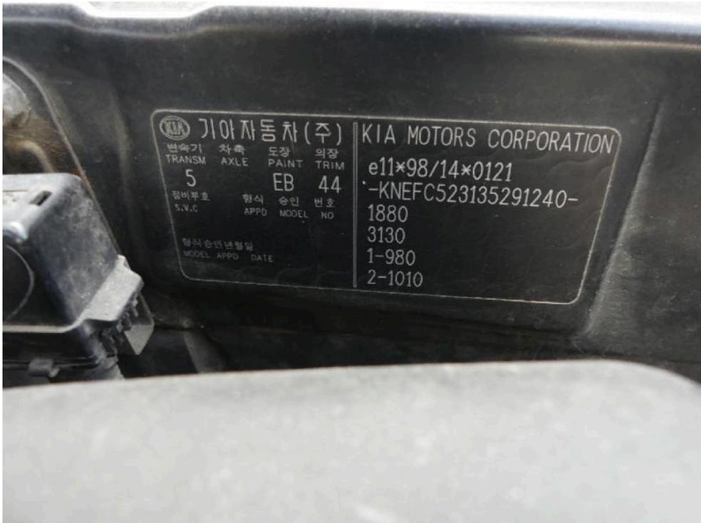
Bild: 25 Ausweisung Fahrzeugidentnummer mit Kennschild
