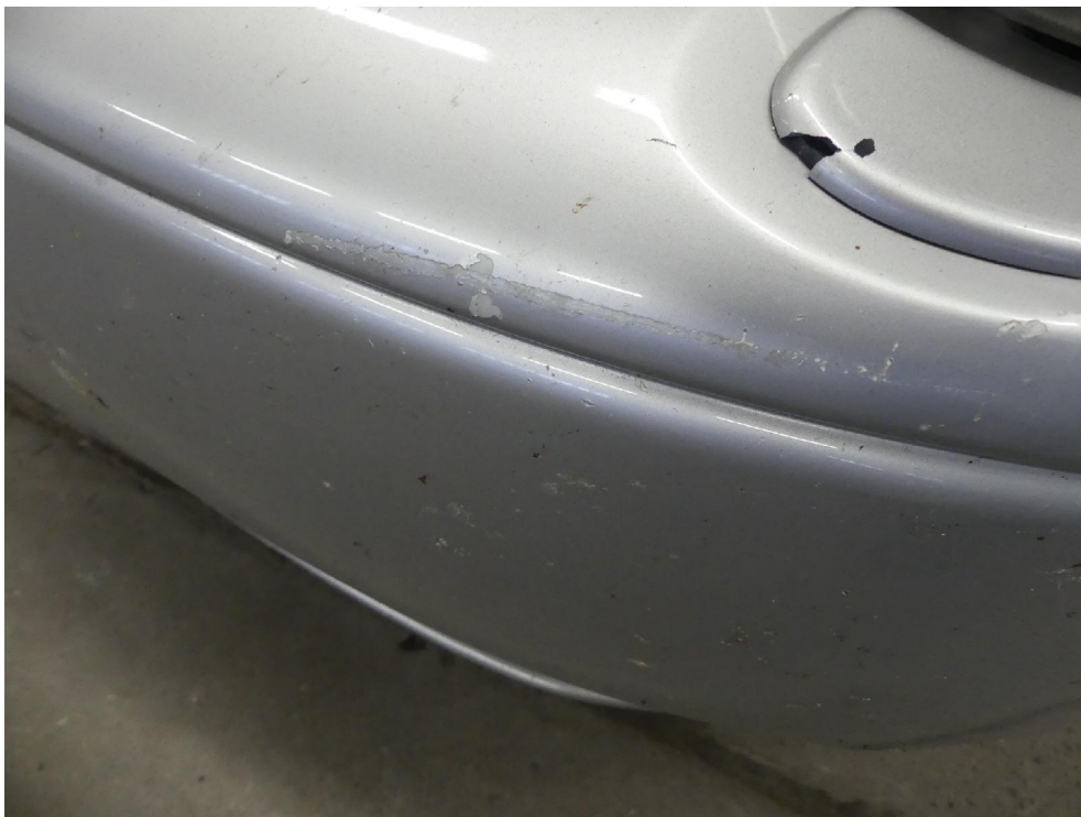
Bild: 48 Frontverkleidung rechtsseitig im Lackaufbau markiert.
