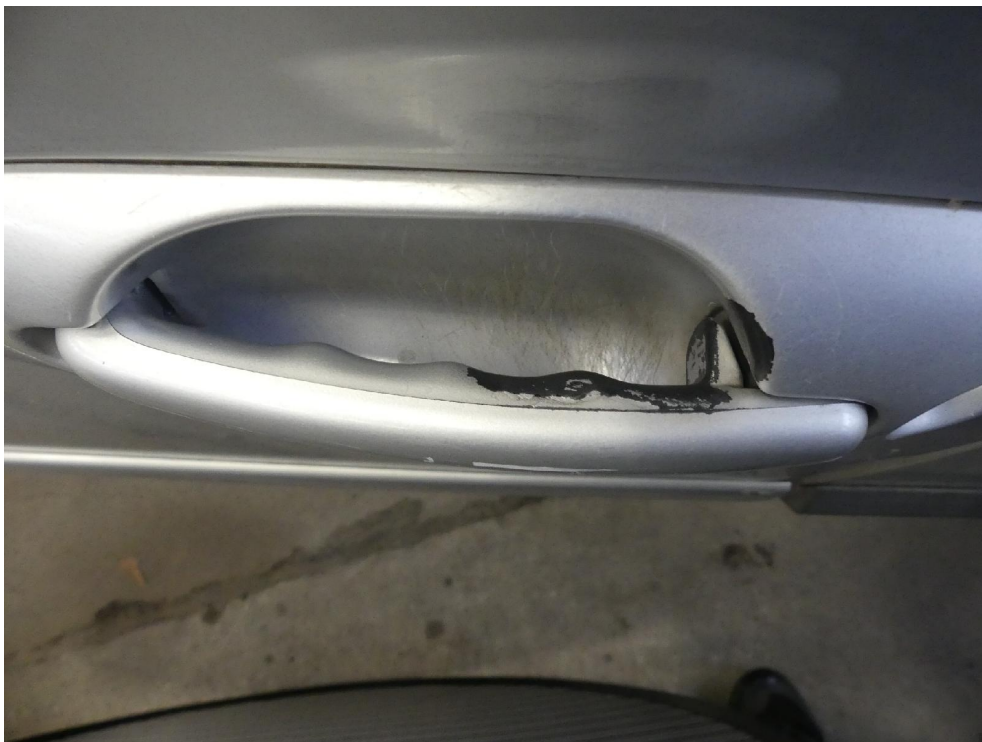
Bild: 50 Türöffner mit Abtragung Lackaufbau
