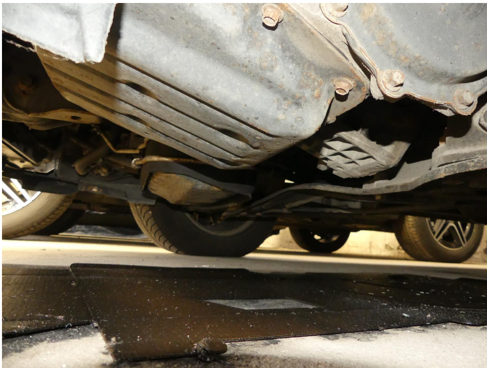
Bild: 64 Ölaustritt vorhanden.
