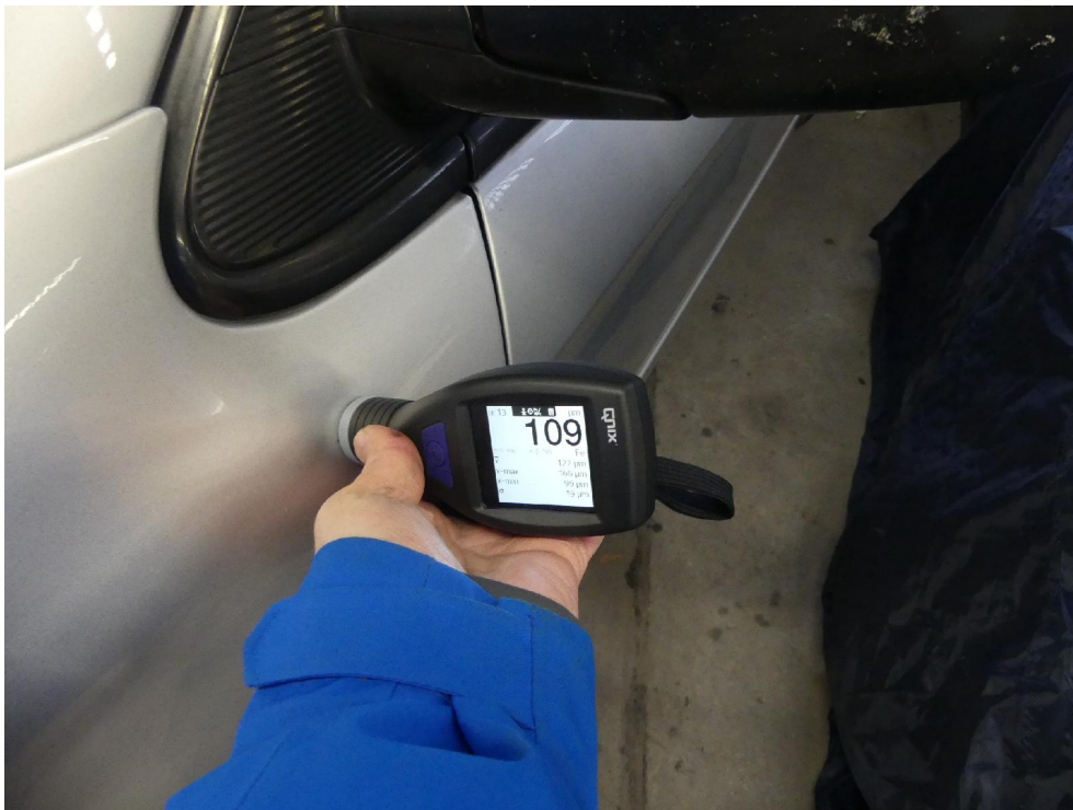
Bild: 61 Ausweisung Lackschichtdickenmessung vorgenommen, Messwerte dem beiliegenden Protokoll entnehmen.
