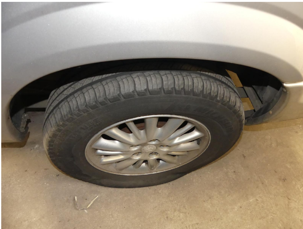
Bild: 56 Ansicht wie vor, Reifen ist drucklos !
