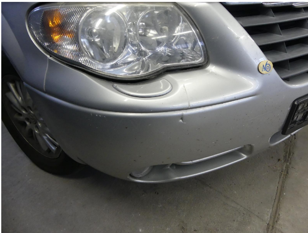
Bild: 46 Detailansicht Frontverkleidung, diese ist punktuell im Grundmaterial durchstoßen.
