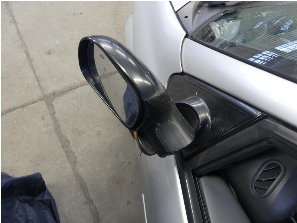
Bild: 49 Außenspiegel links beschädigt, Einbaulage versetzt.
