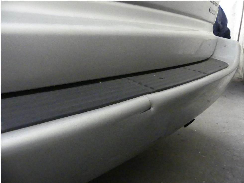
Bild: 53 ... die Heckverkleidung ist im Grundmaterial durchstoßen.
