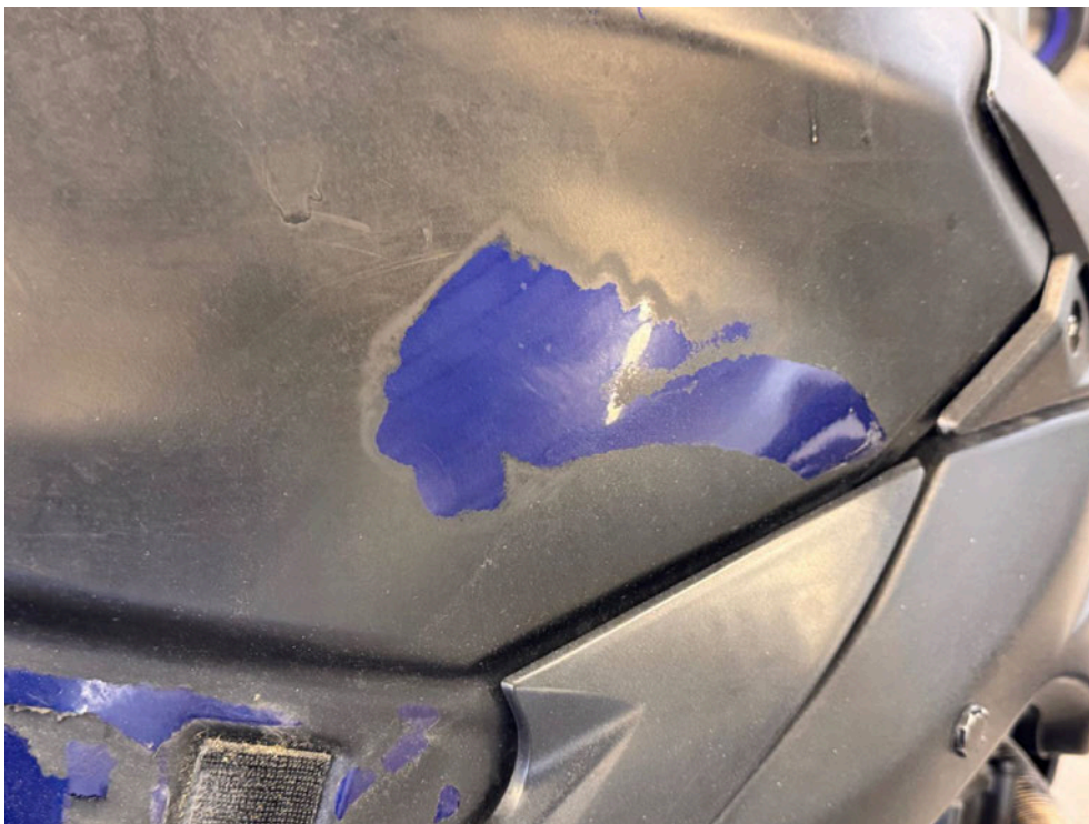
Bild: 28 Fahrzeug partiell foliert - Folierung sichtbar abgetragen.
