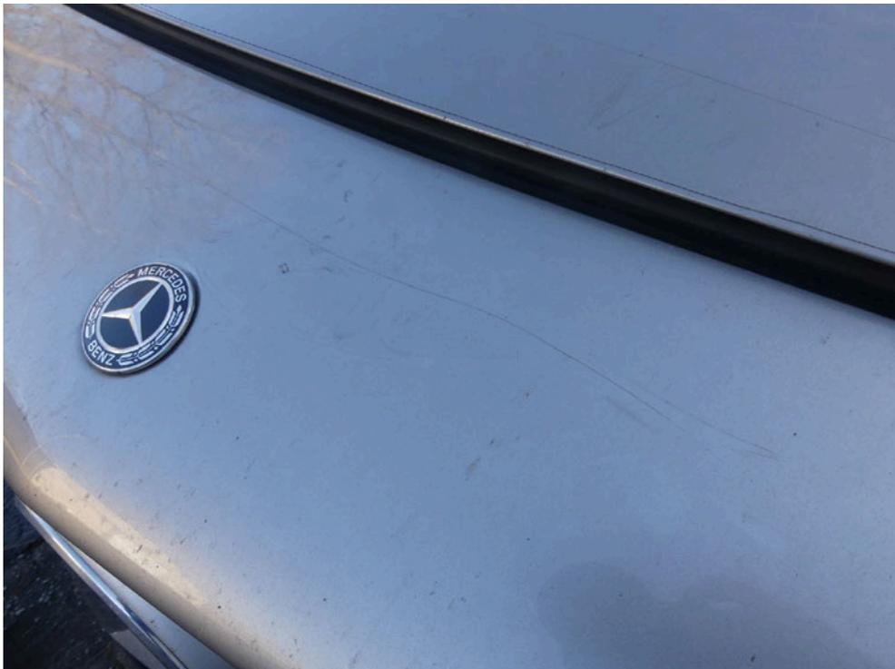
Bild: 54 ... diese ist streifend im Lackaufbau markiert.
