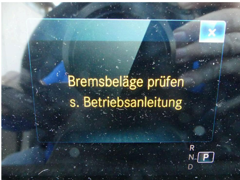
Bild: 16 Ausweisung Hinweis - Fehlermeldung Kombiinstrument
