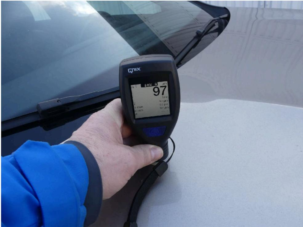
Bild: 11 Ausweisung Lackschichtdickenmessung vorgenommen, Messwerte dem beiliegenden Protokoll entnehmen.
