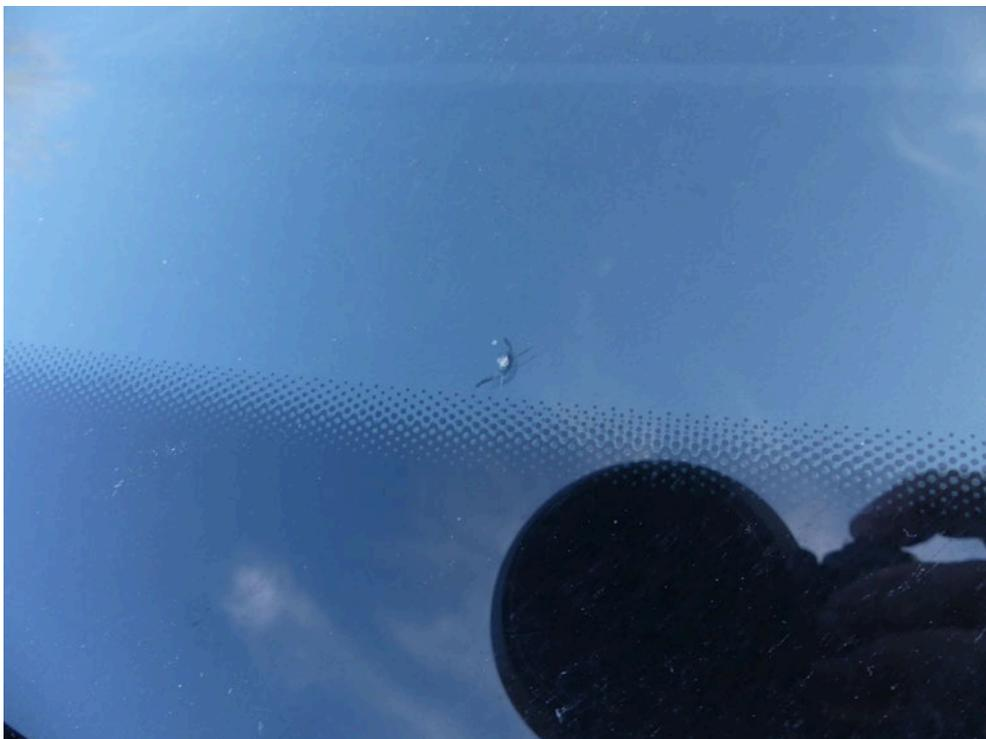
Bild: 60 ... diese hat einen sichtbaren Steinschlag im unteren Segment
