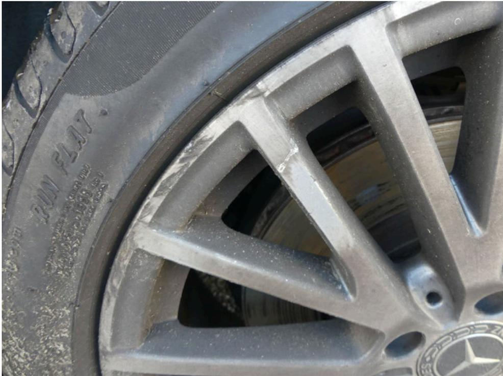
Bild: 49 LM-Felge vorn rechts beschädigt.
