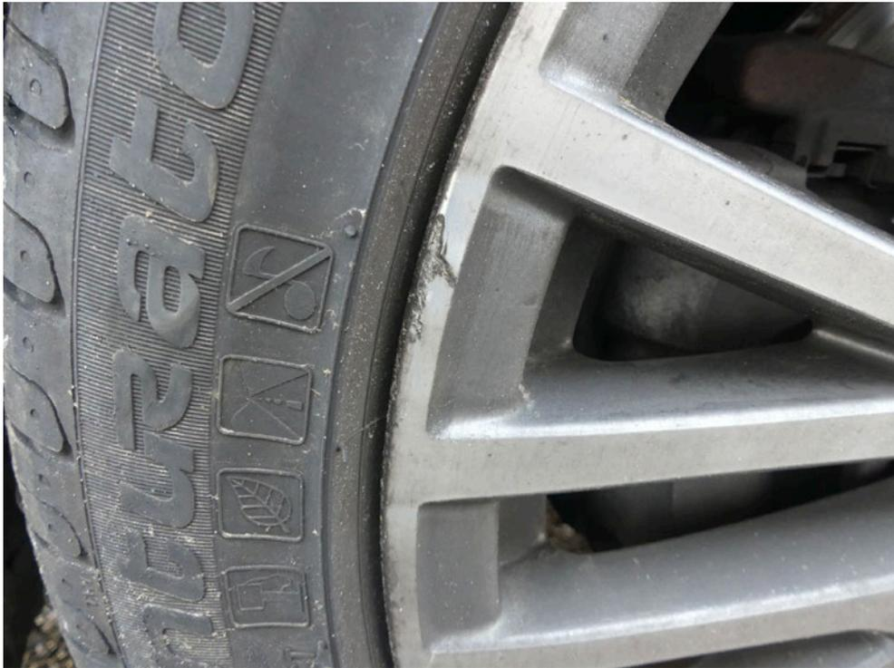
Bild: 41 Detailansicht, LM-Felge partiell beschädigt.
