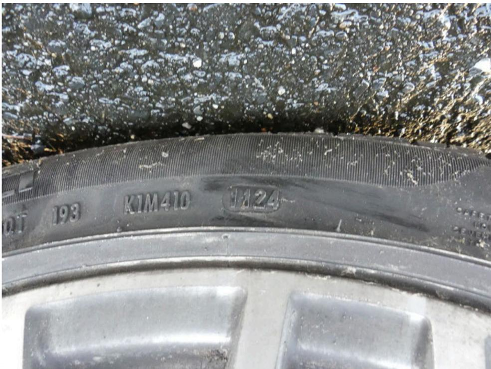
Bild: 40 Ausweisung der DOT Nummer der Radialreifen
