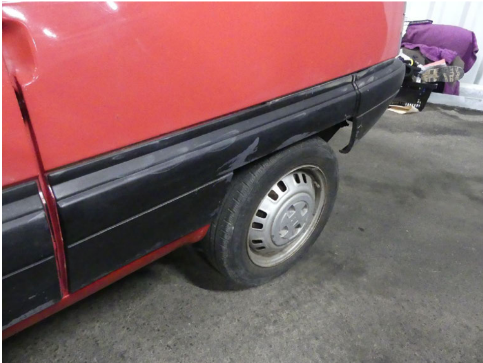
Bild: 41 ... diese ist streifend beschädigt.
