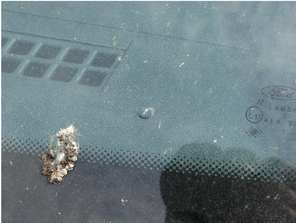
Bild: 37 ... ist ein Steinschlag vorhanden.
