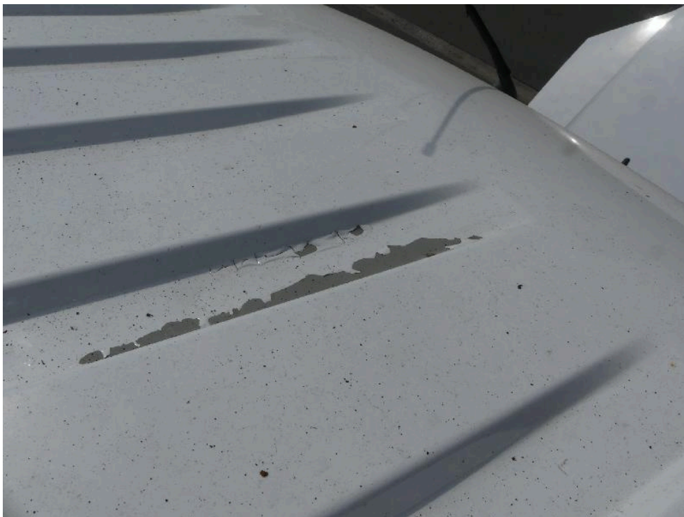
Bild: 34 Lackablösung Fahrzeugdach.
