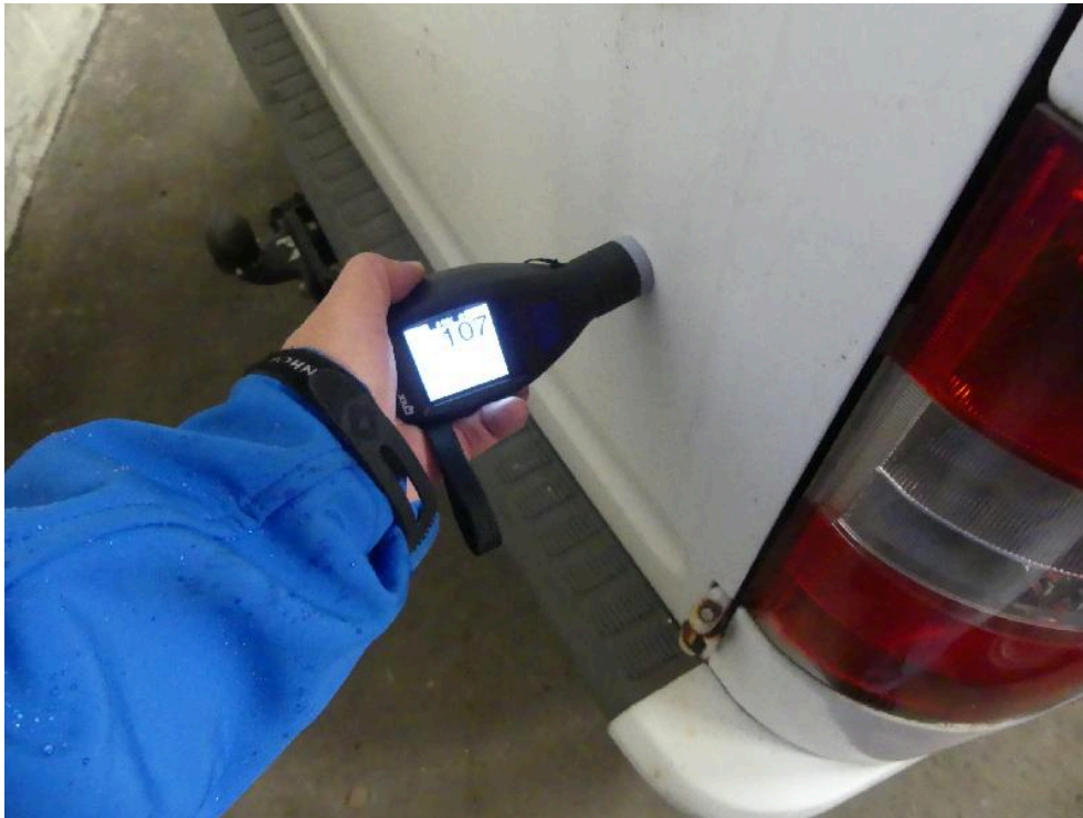
Bild: 54 Ausweisung Lackschichtdickenmessung vorgenommen, Messwerte dem beiliegenden Protokoll entnehmen.
