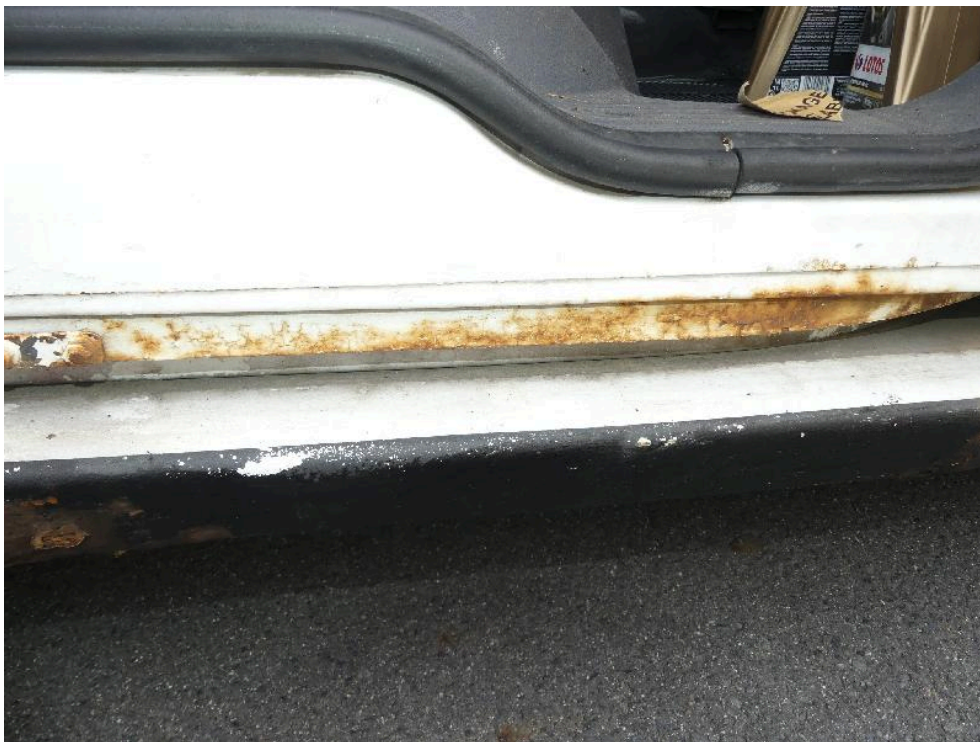
Bild: 32 Laufschiene Schiebetür rechts, diese ist sichtbar korrodiert.
