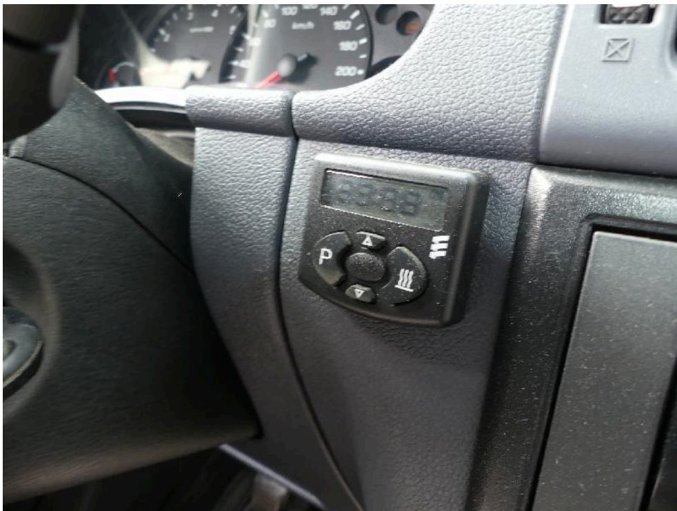
Bild: 28 Ausweisung Standheizung
