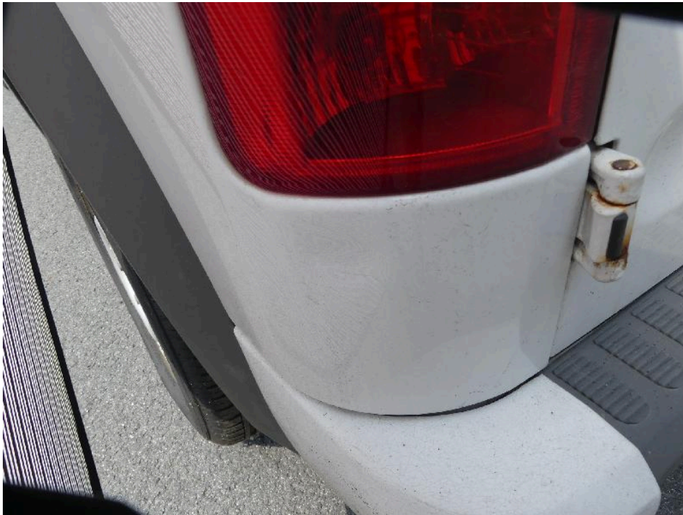
Bild: 45 Seitenwand unterhalb der Rückleuchte gestaucht.
