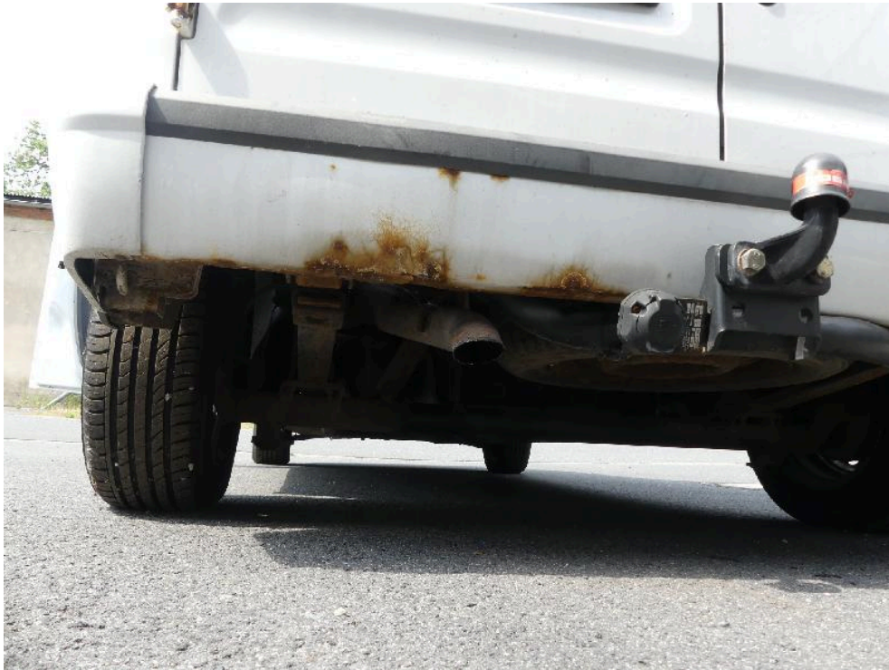
Bild: 39 Abschlussträger korrodiert.
