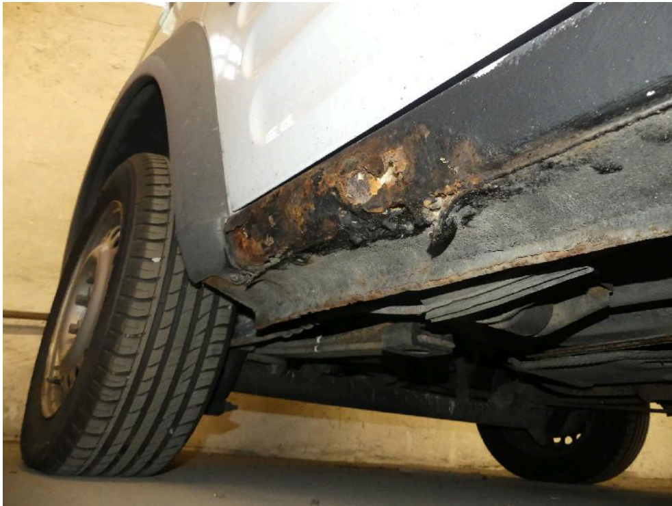
Bild: 49 Einzeldarstellung Einstiegsschweller rechts, dieser ist sichtbar korrodiert.
