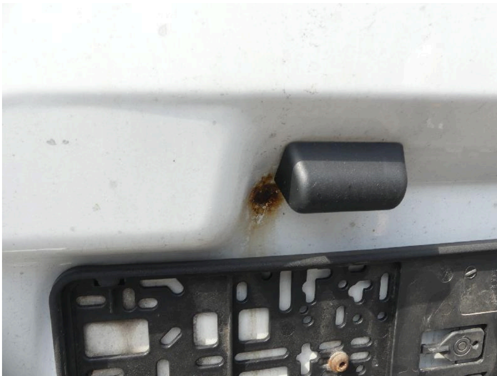
Bild: 38 Korrosionsansatz Flügeltür links
