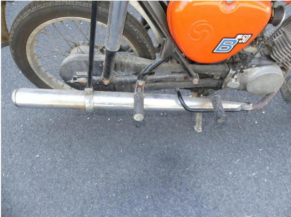
Bild: 33 Einzeldarstellung Abgasanlage
