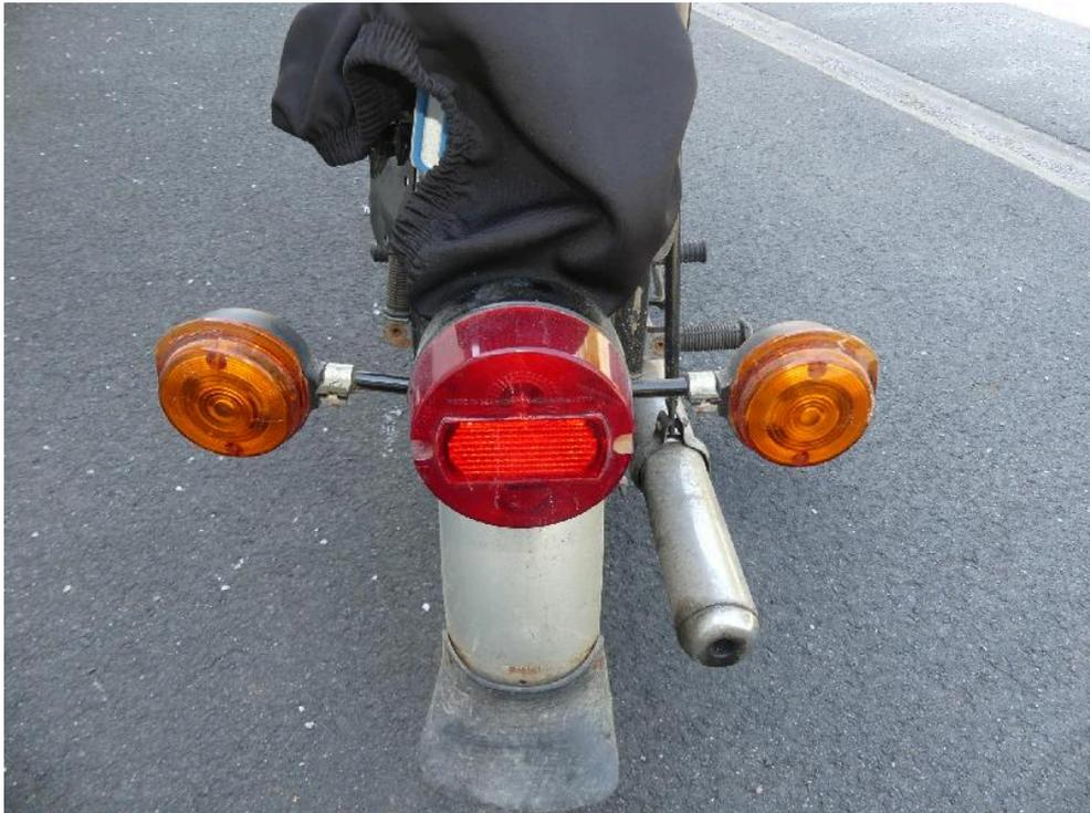
Bild: 35 Detaillierte Darstellung Rückleuchte mit Richtungsanzeiger
