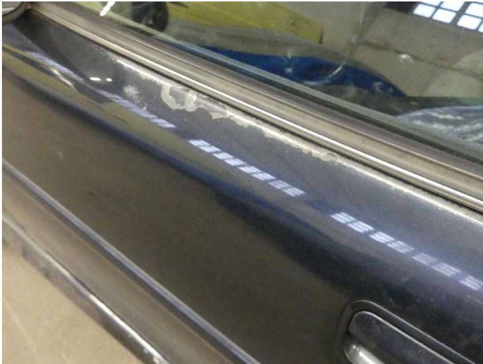
Bild: 31 Ansicht Fahrertür, hierbei löst sich ebenfalls der Lackaufbau ab.
