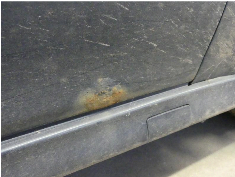
Bild: 38 Detailansicht Beifahrertür unteres Segment, Korrosion vorhanden.
