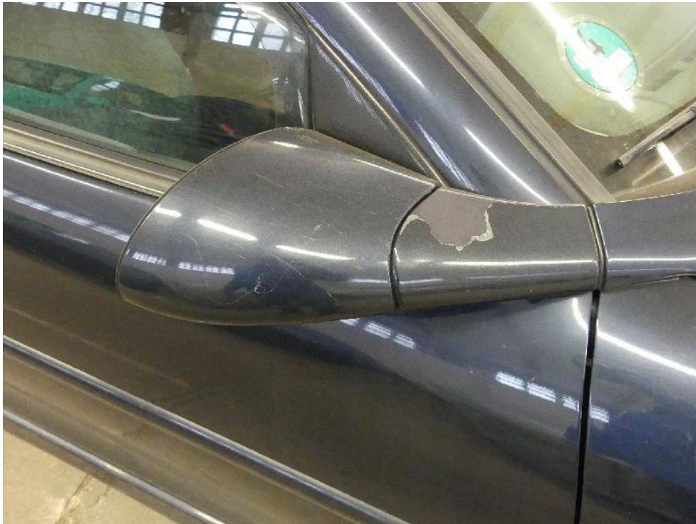
Bild: 39 Außenspiegel links, Lackablösung vorhanden.
