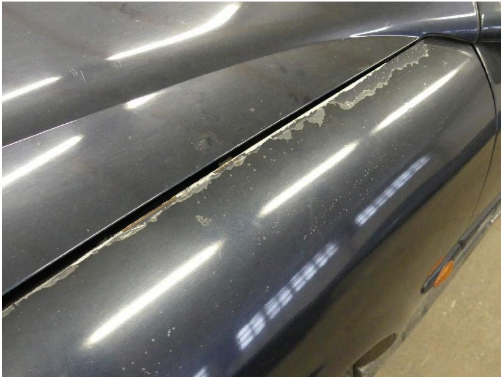
Bild: 29 ... das Lackmaterial löst sich partiell ab.
