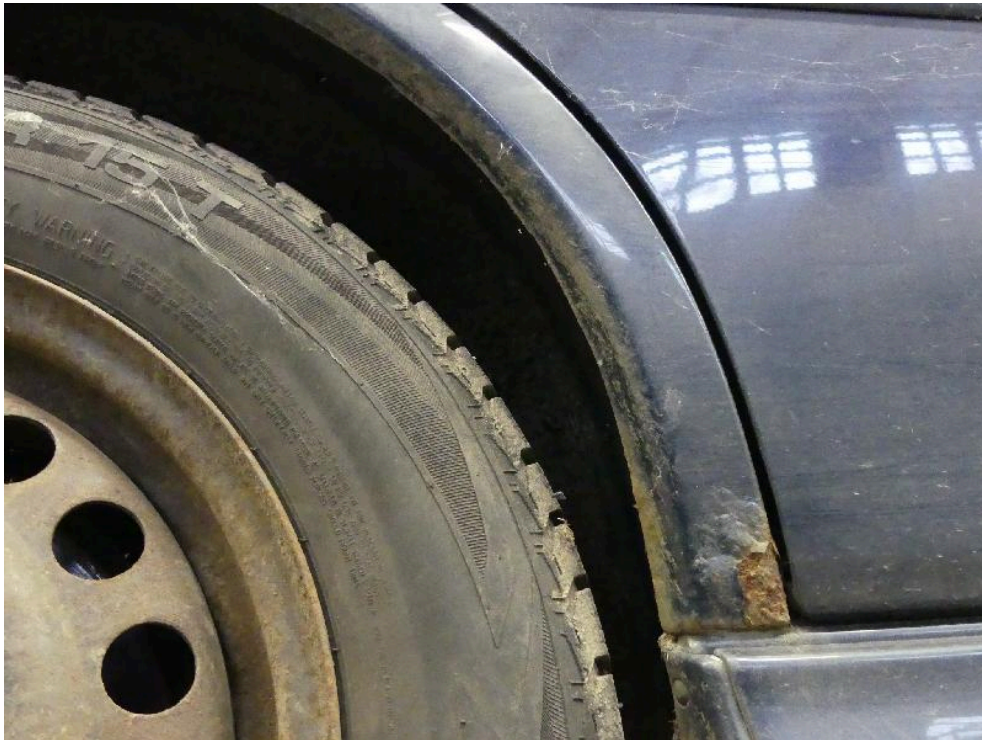
Bild: 37 Fahrzeugtypische Korrosion vorhanden.
