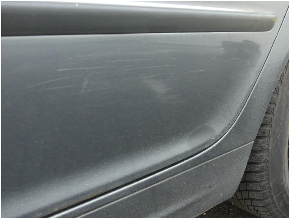
Bild: 45 Weiterführend ist diese streifend beschädigt.
