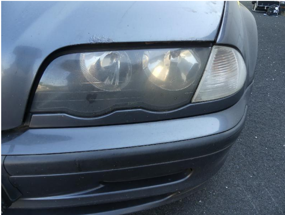
Bild: 65 ... diese sind in der Klarglasscheibe partiell blind.
