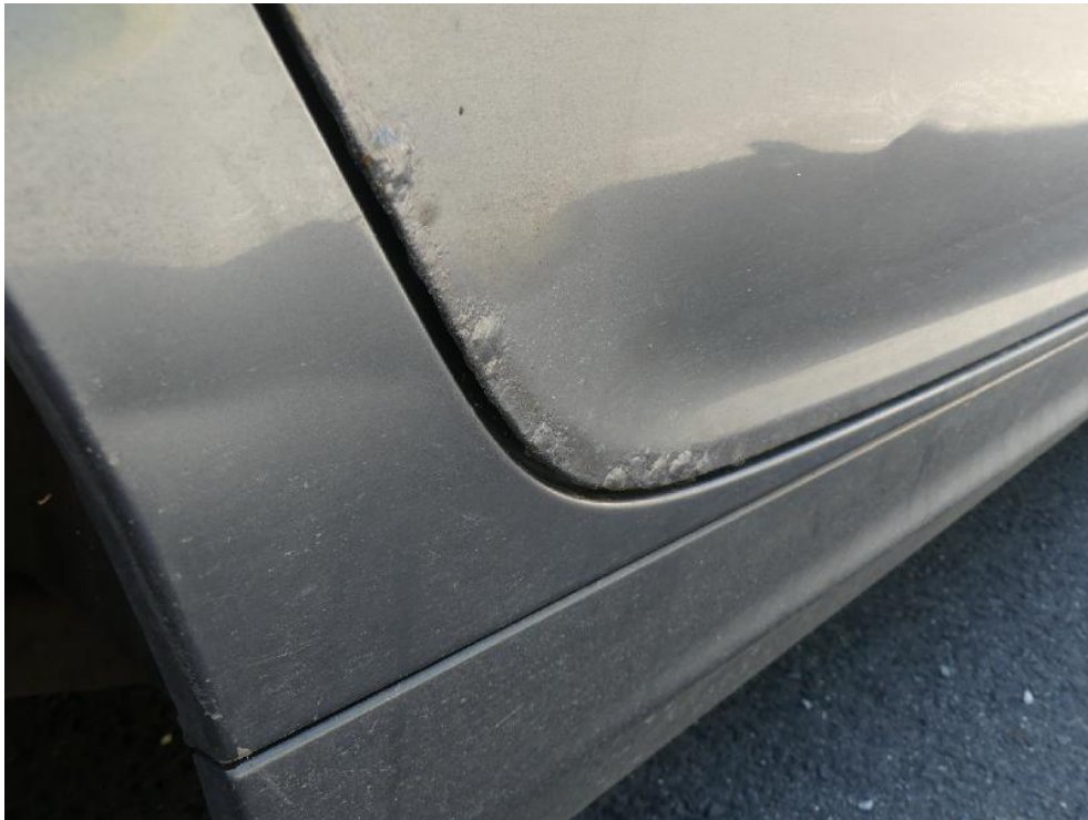
Bild: 61 Korrosion Fondtür rechts
