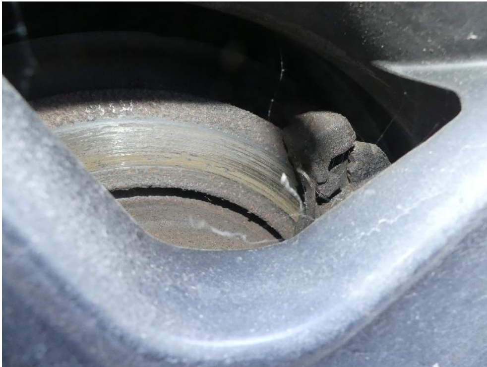
Bild: 75 Standschäden Bremsanlage Hinterachse
