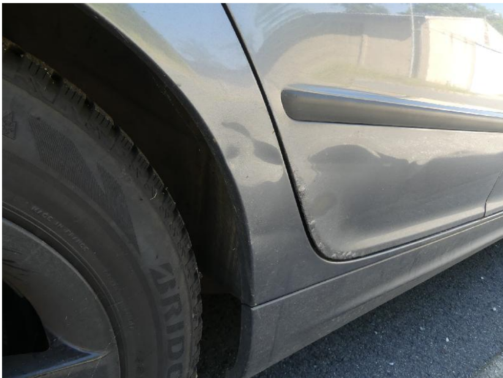
Bild: 60 Kniestück Seitenwand rechts defomiert.
