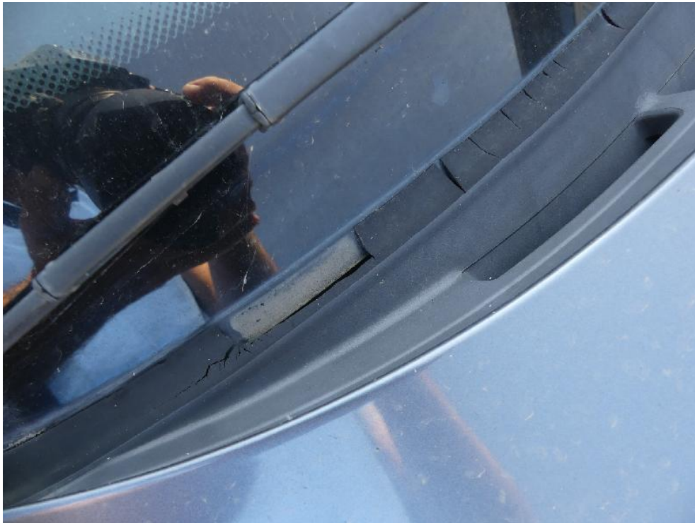
Bild: 63 Abdichtung Frontscheibe brüchig
