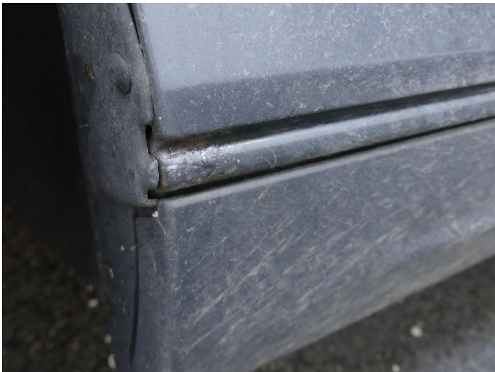
Bild: 42 Rostansatz Schweller links
