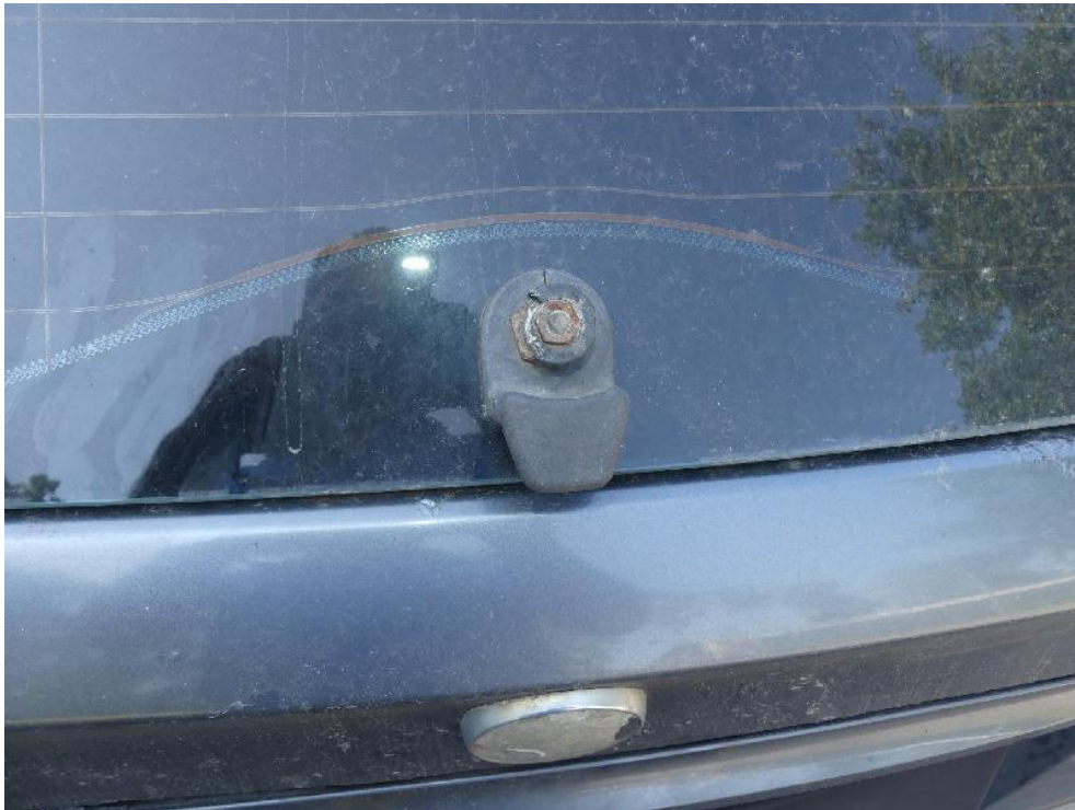
Bild: 55 Heckwischerarm fehlt
