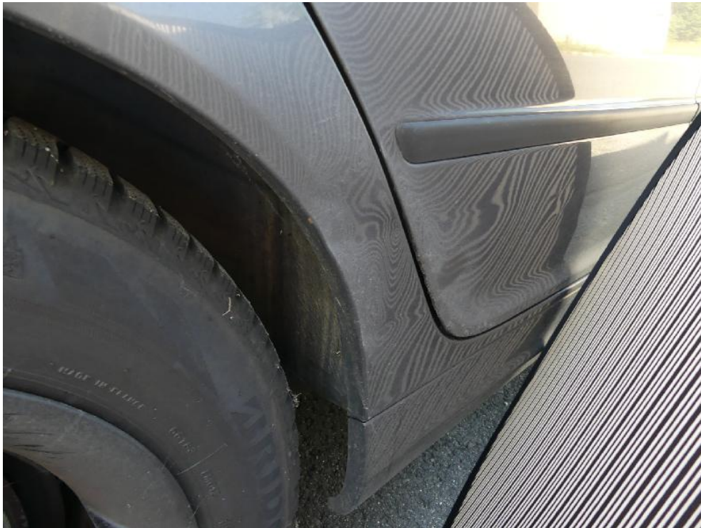
Bild: 91 Deformation Seitenwand und Fondtür rechts.
