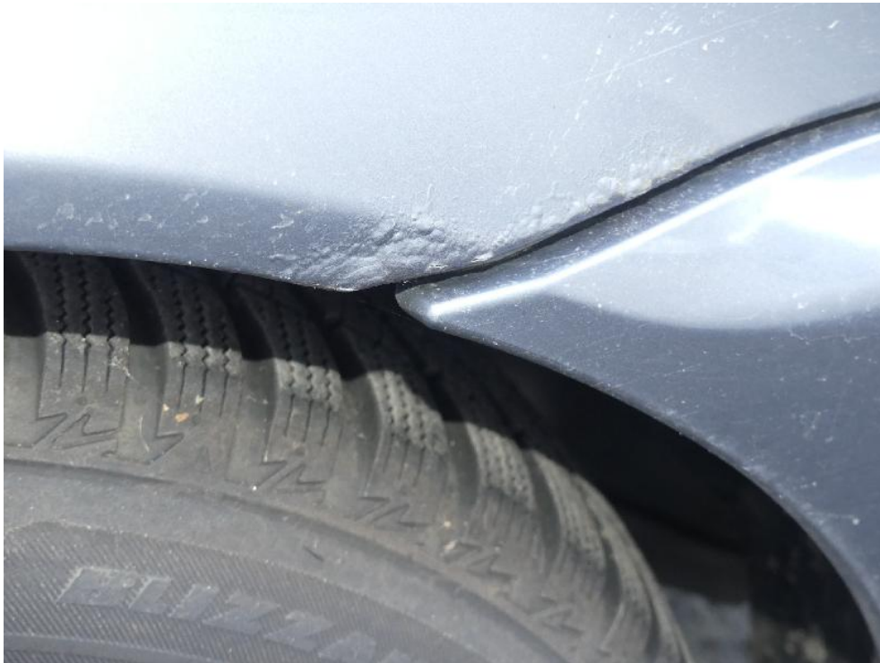
Bild: 47 Seitenwand links, Rostansatz
