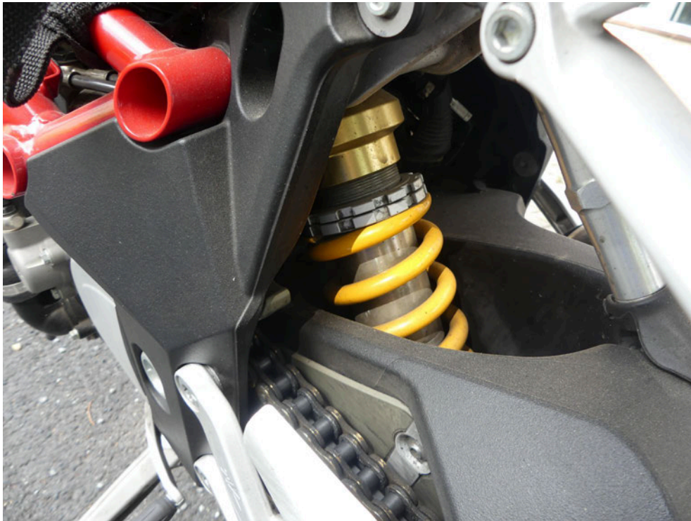
Bild: 25 Detaillierte Darstellung Stoßdämpfer Hinterachse
