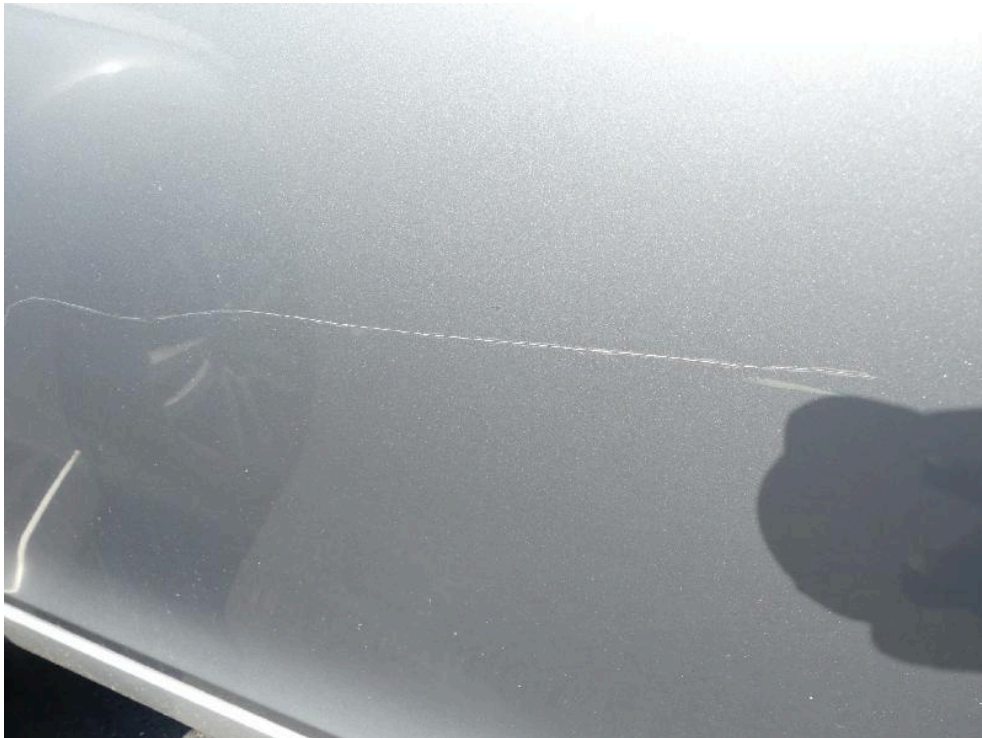
Bild: 66 .... diese ist streifend im Lackaufbau markiert.
