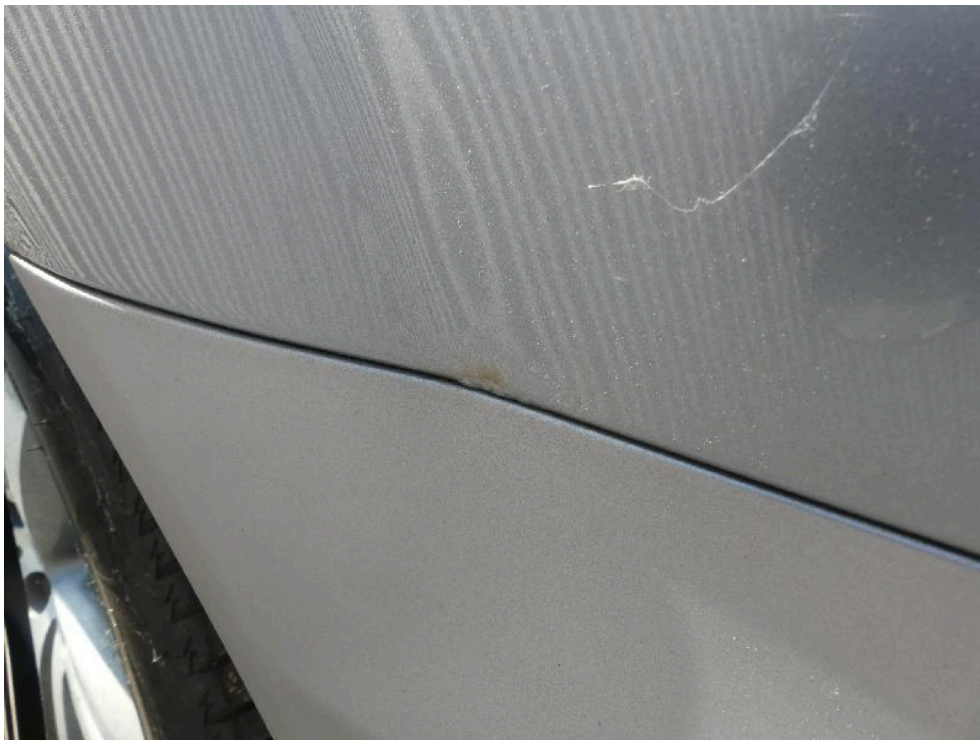
Bild: 75 .... diese ist mehrfach korrodiert.
