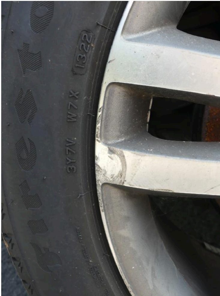
Bild: 53 LM_Felge hinten rechts beschädigt.
