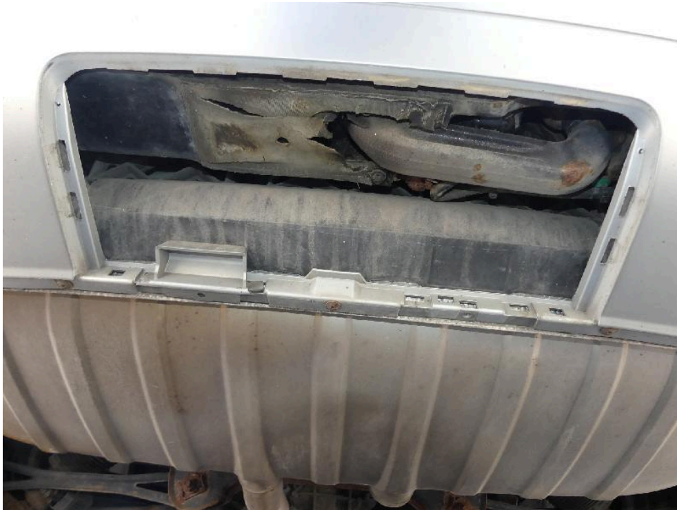
Bild: 83 Ansicht schwenkbare Anhängerzugvorrichtung, Abdeckung ist nicht vorhanden.
