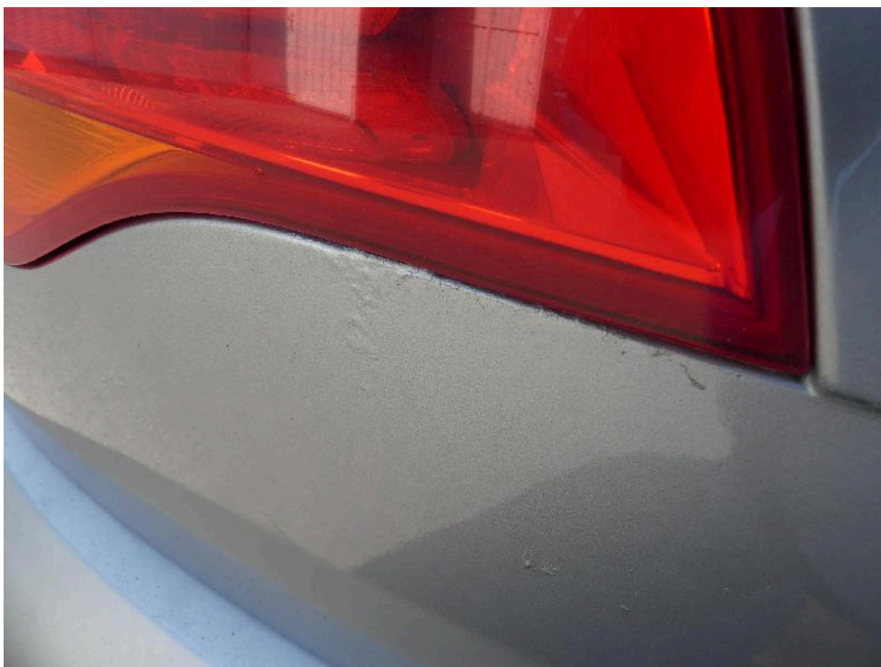
Bild: 86 Ansicht wie vor in geänderter Perspektive, Korrosion unterhalb der Rückleuchteinheit ist vorhanden.
