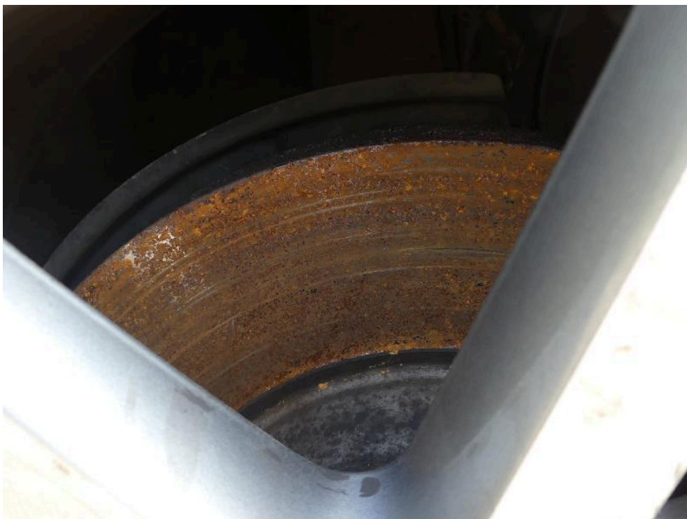
Bild: 51 Bremsanlage erhebliche Standschäden
