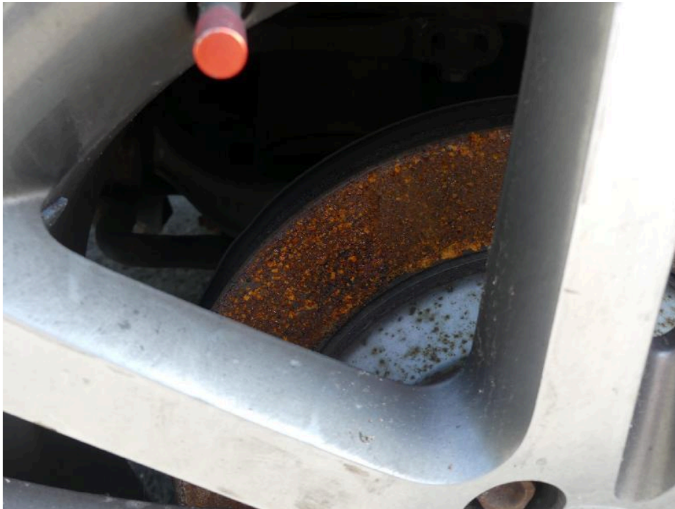
Bild: 54 Hinterachse rechts Bremsanlage -- FEST !!!! --
