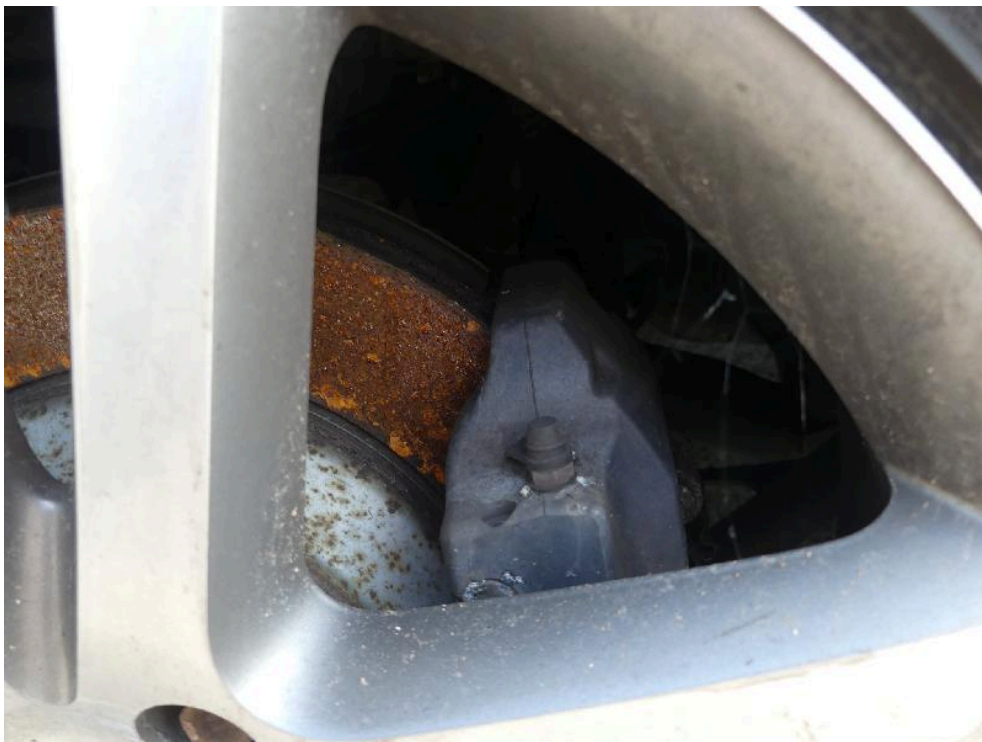
Bild: 55 Bremsscheiben massiv korrodiert.
