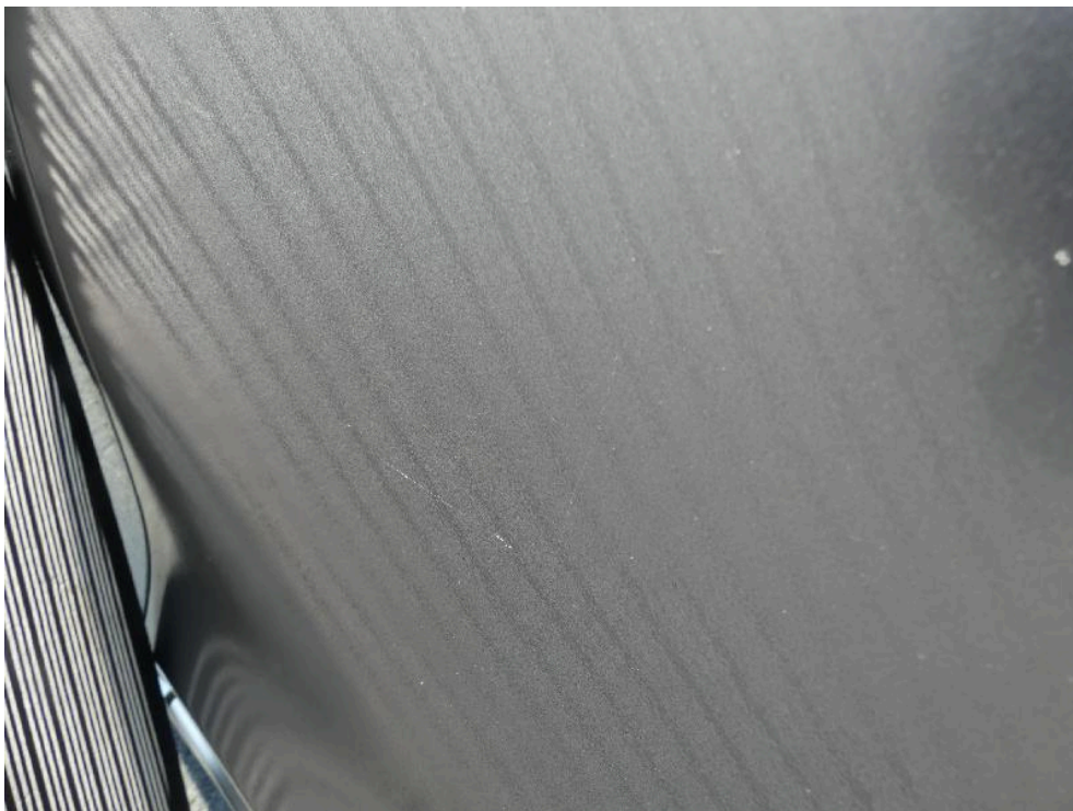
Bild: 72 Detailansicht Fondtür links, diese ist nicht fach- u. sachgerecht nachlackiert.
