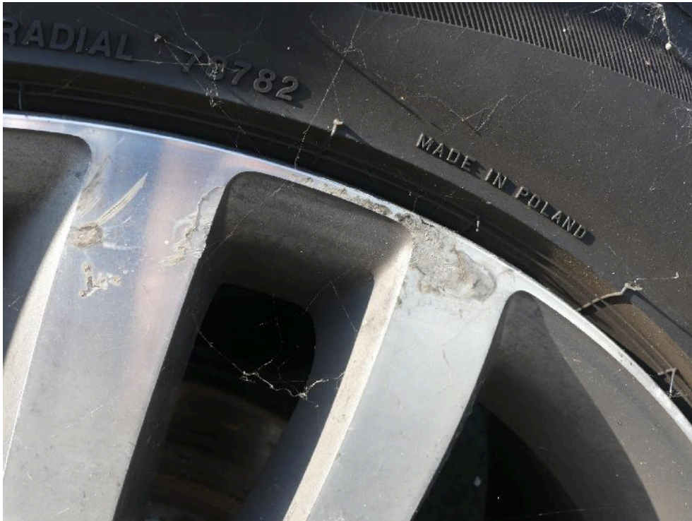
Bild: 58 LM-Felge hinten links bschädigt.
