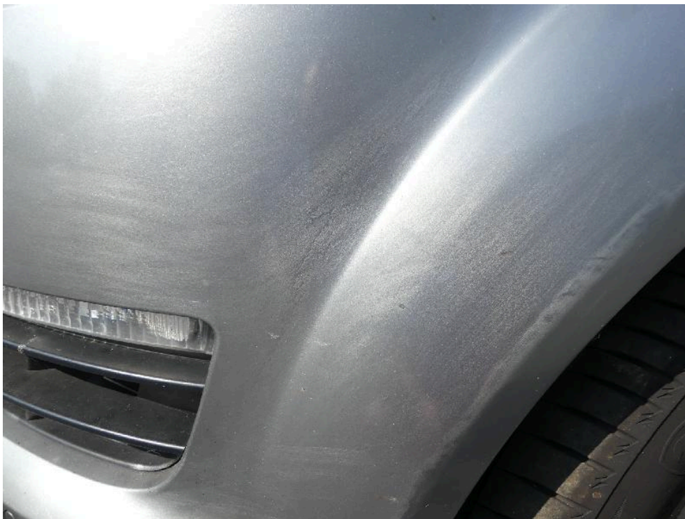
Bild: 61 ... diese ist nicht fachgerecht nachlackiert.
